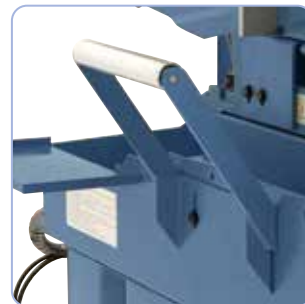
Serial cu suport pe role pentru susținerea pieselor de lucru
