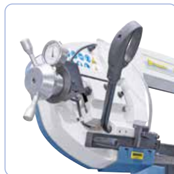
Mâner ergonomic, reglarea tensionării plăcii are loc prin intermediul roții de mână.
