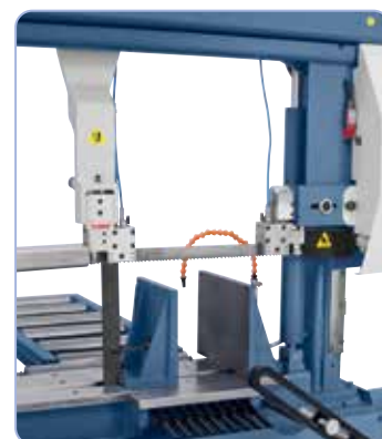
Ghidajul deplasabil al benzii fierăstrău poate fi adaptat optim la lățimea piesei de prelucrat
