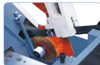
Ghidajului benzii fierăstrău rezemat pe lagăre cu bile și perii de span pentru rezultate optime ale tăierii
