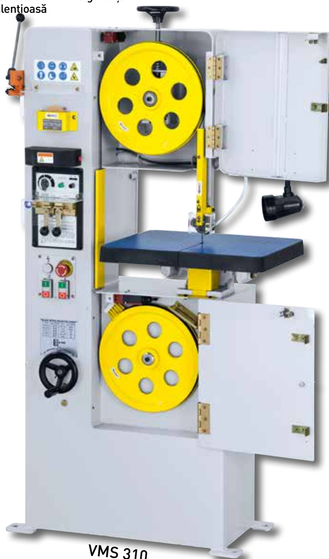
Ghidaj bandă fierăstrău rezemat pe rulmenți cu bile, reglabilă la înălțimea respectivei piesei de prelucrare
