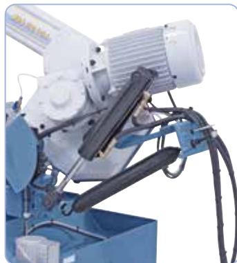
În fabricație de seriei cu cilindru hidraulic de coborâre pentru coborârea fără trepte a etrierului fierăstrău și deconectarea automată de capăt după secționarea materialului
