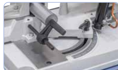
Pentru tăieri oblice etrierul fierăstrăului poate fi pivotat de la +45° până la -60°
