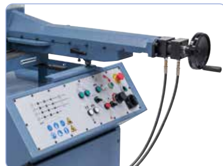
Menghină translatabilă, strângerea se realizează manual sau hidraulic
