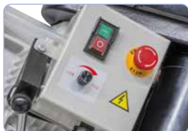
Viteză de tăiere variabilă pentru adaptarea optimă la piesa de prelucrat, pupitrul de operare ușor de utilizat
