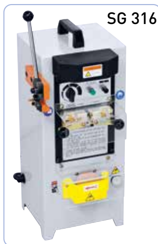
Reglarea tensionării pânzei are loc prin intermediul roții de mână
