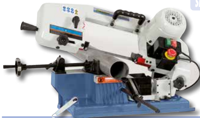
Presiunea de așezare a etrierului fierăstrău reglabilă de 3 ori
