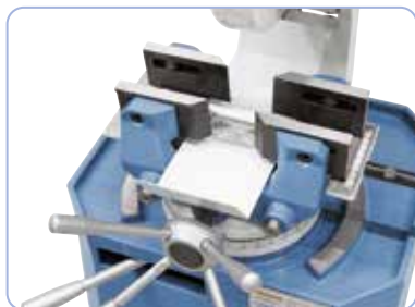
Menghină cu prindere centrată cu bacuri de prindere reglabile longitudinal
