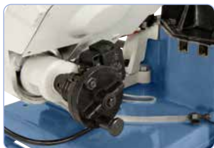
Presiunea de așezare a etrierului fierăstrău reglabilă de 3 ori
