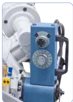
Ghidajului benzii fierăstrău rezemat pe lagăre cu bile și perii de span pentru rezultate optime ale tăierii
