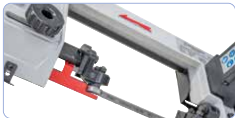
Ghidaj bandă fierăstrău rezemat pe lagăre cu bile pentru tăieri precise
