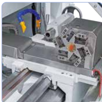
Revolver de sculă automat cu 6-compartimente cuprins în furnitura livrată.
