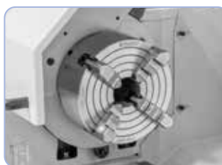
Plansaibă 200 mm (standard) ideală pentru prinderea pieselor de prelucrat de formă asimetrică
