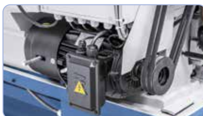
Motor de acționare de mare putere cu frână magnetică conform normativului CE
