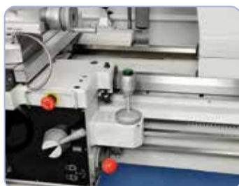
În fabricație de serie cu mers rapid pentru reducerea timpilor auxiliari
