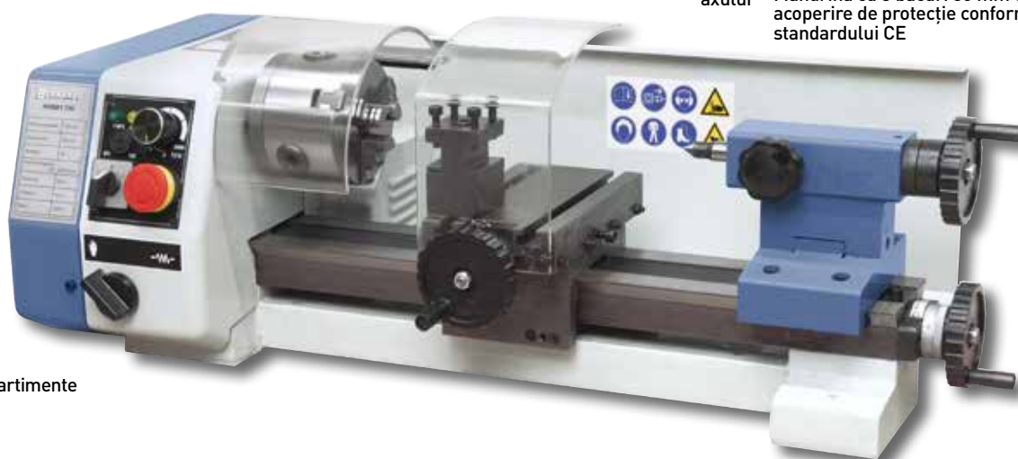
Operare simplă tota elementele de comutare central pe capul axului
