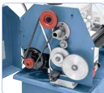
În fabricație de serie echipat cu roți de schimb pentru filetare
