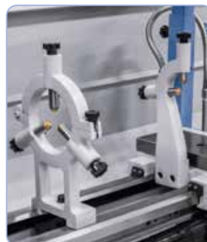
Pentru stabilizarea pieselor de prelucrat lungi este echipat în fabricație de serie cu o linetă fixă (imobilă) respectiv antrenată (mobilă)
