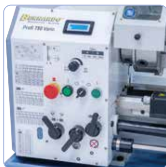
Reglare turație fără trepte, electronică, citire ușoară prin intermediul afișajului digital
