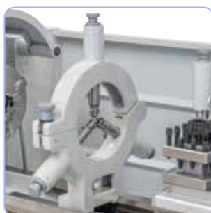
Linetă fixă (imobilă) pentru rezemarea pieselor lungi și subțiri
