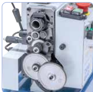
În fabricație de serie echipat cu roți de schimb pentru filetare
