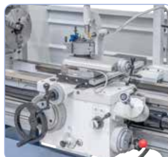
Pentru mișcările longitudinale și transversale ale saniei respectiv ale suportului superior stau la dispoziție 42 avansuri liber selectabile.
