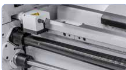
Opritor longitudinal micrometru și cuplaj de fricțiune cuprinse în completul de livrare
