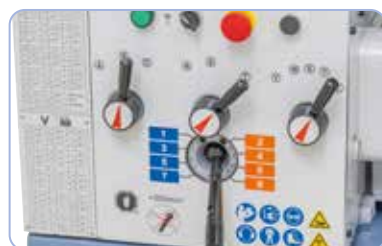
Transmisia avans comutabilă simplu și precis, roțile dințate rectificate asigură o funcționare silențioasă
