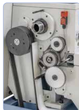
În fabricație de serie echipat cu roți de schimb pentru filetare
