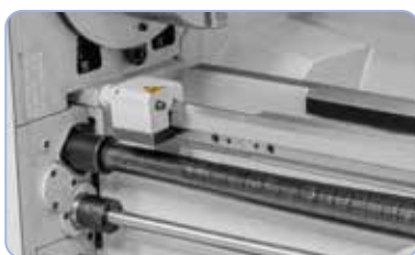
Opritor longitudinal micrometru și cuplaj de fricțiune cuprinse în completul de
