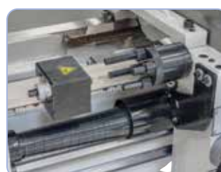
4 rigle de ghidare reglabile și riglă de ghidare longitudinală cu micrometru, ideale pentru lucrări în serie
