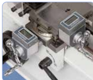
În fabricație de serie cu afișaje digitale pentru poziționarea exactă și citirea la strunjire
