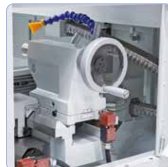
Păpușă mobilă robustă cu prindere pinolă MK 4 poate fi ajustată pentru strunjirea conică
