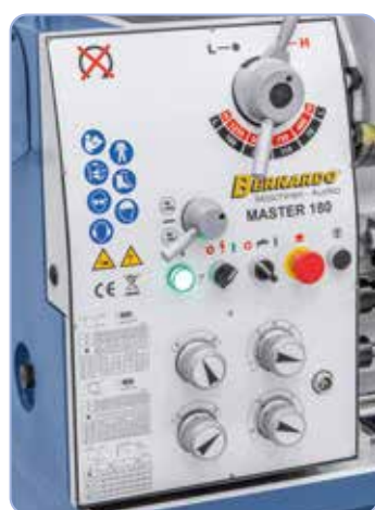
Reglare avans și turație cu mers ușor la capul de transmisie, funcționare silențioasă prin roți dințate călite și rectificate, ce funcționează în baie de ulei
