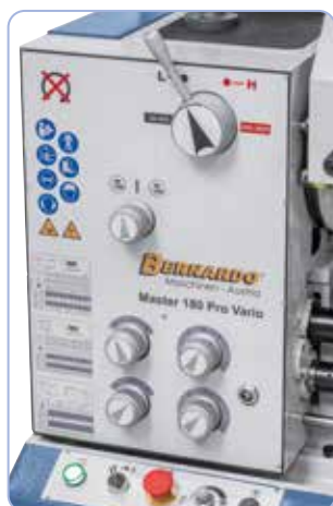
Elemente de comutare montate vizibil la capul transmisiei, roți dințate călite și rectificate asigură o funcționare silențioasă
