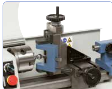
Suport frezare vertical cu dispozitiv de rotire pe bile montat (opțional)
