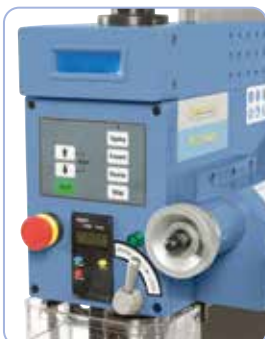
Afișaj digital simplu de citit, operare confortabilă de la tastatura folie
