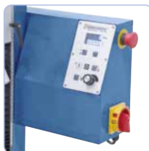
Operare confortabilă de la tastatura folie
