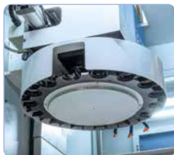
Schimbător de scule cu 16 compartimente pentru durate scurte de echipare
