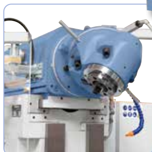
Prin ajustarea nivelelor 90° și 45° capul pivotabil universal poate fi reglat la toate pozițiile unghiulare
