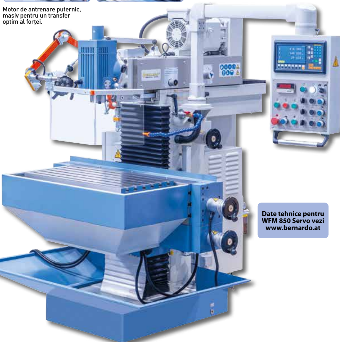
Dispozitiv de protecție ajustabil, utilizabil atât pentru lucrări de frezare verticale cât și orizontale.
