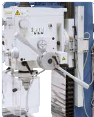
Avansul pinolei poate fi reglat alternativ la 0,10 / 0,18 sau 0,26 mm/rot
