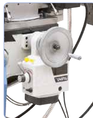
Standard cu dispozitiv de avans cu comanda continua pentru axa y
