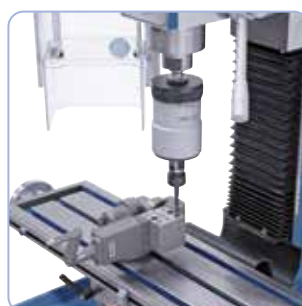
Pentru tăierea filetelor mașina poate să fie echipată cu un aparat de filetare de M5 - M12
