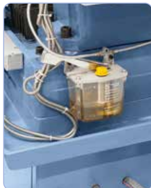
În fabricație de serie cu lubrifiere centralizată pentru căile de ghidare
