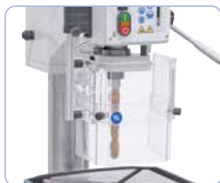
Acoperire de protecție conform standard CE reglabilă la respectiva lungime de burghiu
