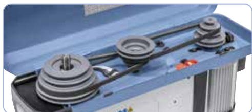
Curele trapezoidale de înaltă calitate asigură o transmisie optimă a puterii
