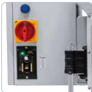
Viteza de alimentare dorită se setează cu ajutorul unui potențiometrul.
