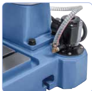
Picior de mașină prelucrat precis, pompă integrată pentru agent de răcire, în fabricația de serie (DMT 32 PFC).
