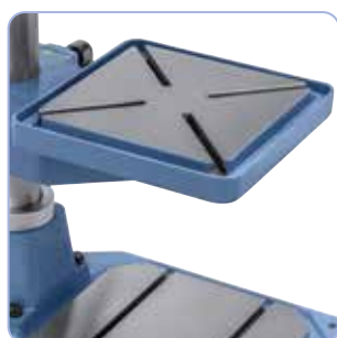
Masă de lucru rectificată cu caneluri T ce o străbat în diagonală
