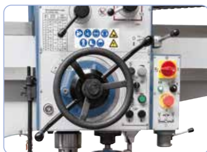
Axul de găurire poate fi deplasat în 3 moduri: ajustare rapidă prin intermediul pârghiei manuale, avans de finețe cu roată de mână sau avans automat
