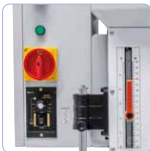
Viteza de alimentare dorită se setează cu ajutorul unui potențiomtru.
