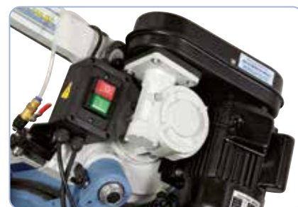
Za pomocą paska wielorowkowego można szybko i łatwo zmienić prędkość cięcia (23 / 33 / 52 m/min).
