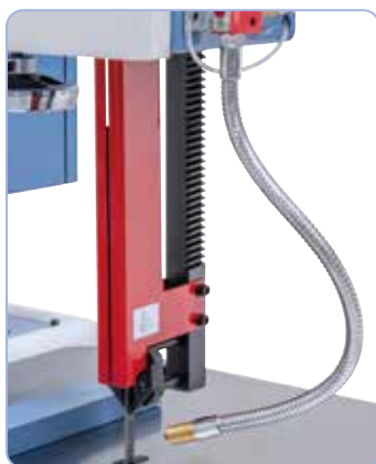
W zestawie mikrosystem chłodzenia i prowadnica wzdłużna.
