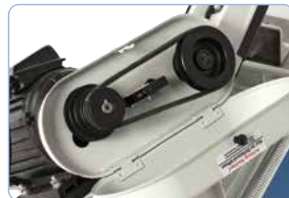
Za pomocą paska wielorowkowego można szybko i łatwo zmieniać prędkość piły taśmowej
