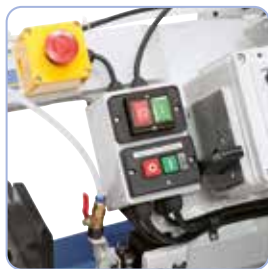
Centralne rozmieszczenie przetłaczniaków na ramieniu piły
