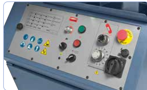
Pokrętło do bezstopniowej regulacji cięcia oraz zawór regulacyjny docisku ramienia pity rozmieszczone w ergonomicznym układzie na pulpicie obsługowym
