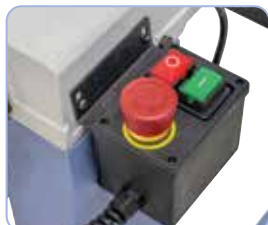
Wyłącznik bezpieczeństwa z wyzwalaczem podnapięciowym i oddzielnym przyciskiem zatrzymania awaryjnego, automatyczne wyłączenie piły po zakończeniu cięcia
