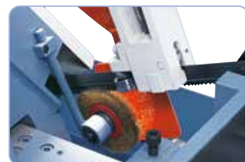
Prowadnica pily oparta na precyzyjnych łożyskach kulkowych i szczotka opilków zapewnia optymalne rezultaty cięcia.
