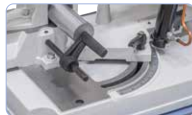
Regulowane ramie do wykonywania cięć skośnych w zakresie od +45° do -60°.
