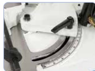
Wychylne ramie piły do cięcia pod kątem od -45^\circ do +60^\circ .
