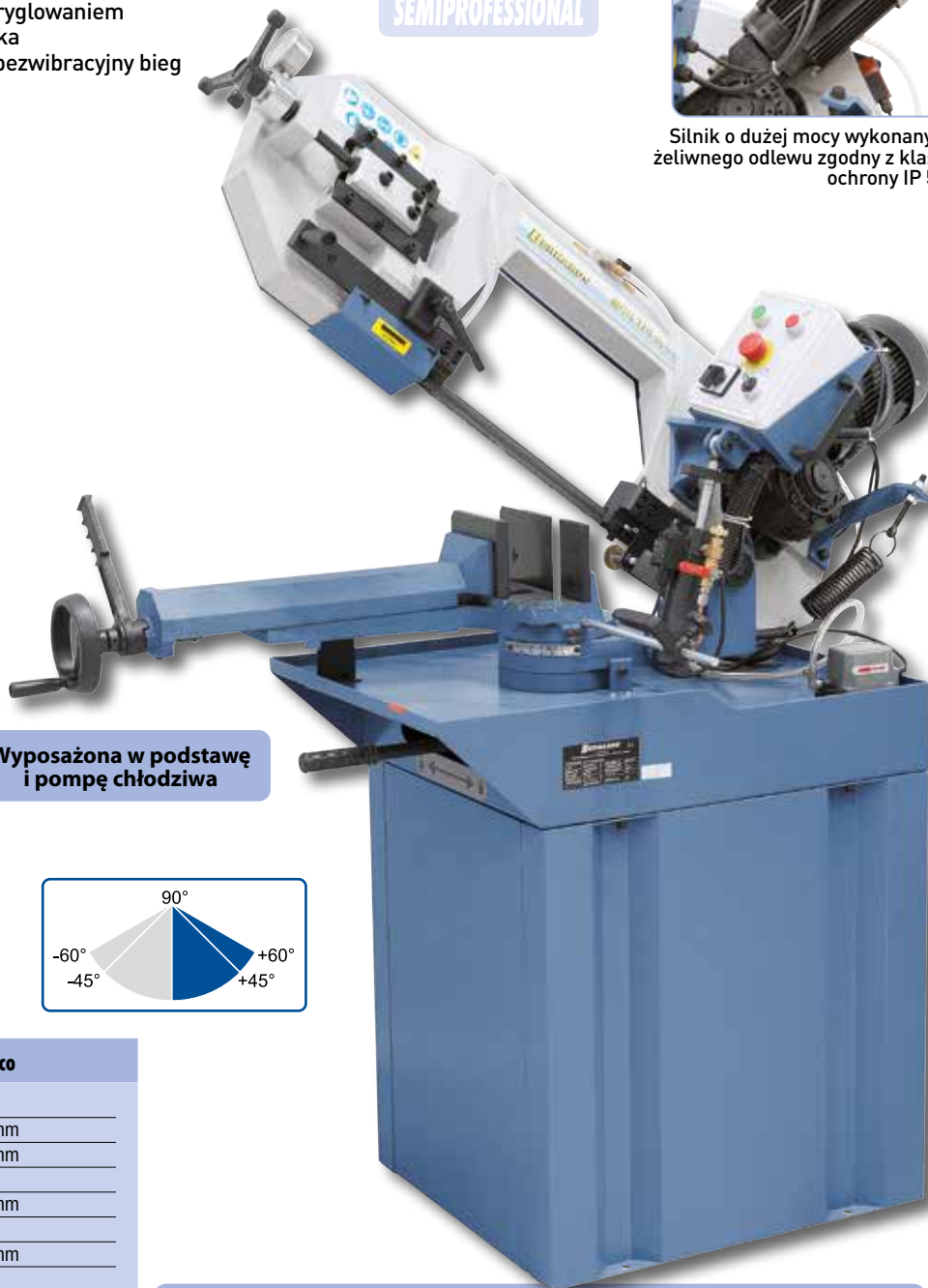
Prowadnica piły oparta na łożyskach kulkowych zapewnia optymalne rezultaty cięcia
