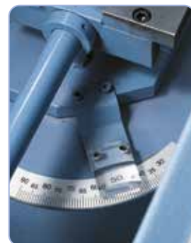
Na czytelnej podziatce można szybko i łatwo ustawić żądany kąt cięcia.
