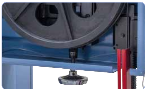
Naciąg piły ustawiany kołem ręcznym.
