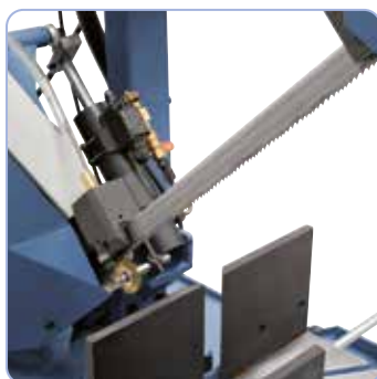
Prowadnica pily oparta na precyzyjnych tożyskach kulkowych i szczotka opitków zapewnia optymalne rezultaty cięcia.
