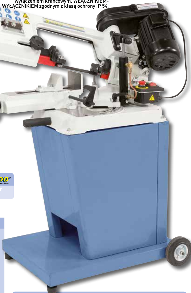
Wychylne ramie piły do cięcia pod kątem od -45^\circ do +60^\circ .
