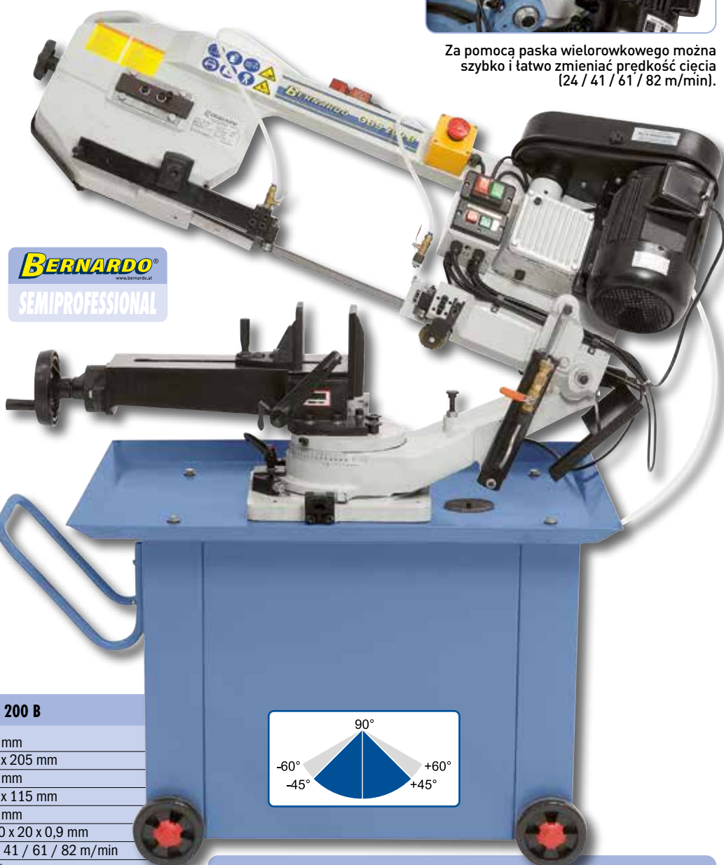
Wychylne ramię piły do cięć pod kątem od -45^\circ do +45^\circ .
