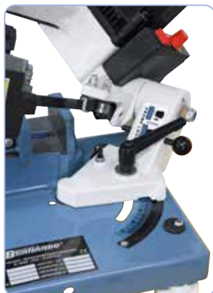
Ramię z blokadą zapewniające lepszą obsługę w zastosowaniach przenośnych
