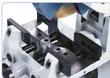
Masywne, samocentrujące się imadło ze szczękami mocującymi przesuwными wzdłużnie.
