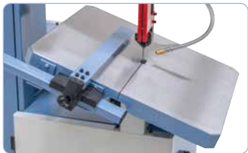
Uchylny stół roboczy wykonany z żeliwa.
