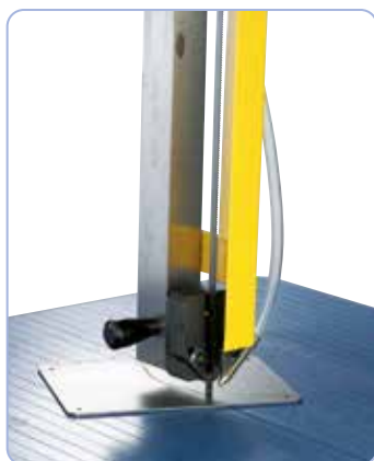
Prowadnica piły na łożyskach kulkowych, z regulacją na wysokość obrabianego przedmiotu.
