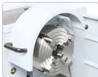
Uchwyt tokarski 250 mm (opcja) idealny do mocowania niesymetrycznych przedmiotów obrabianych.
