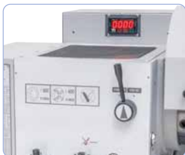
Elektroniczna, bezstopniowa regulacja prędkości obrotowej, czytelne wskazania na cyfrowym wyświetlaczu.
