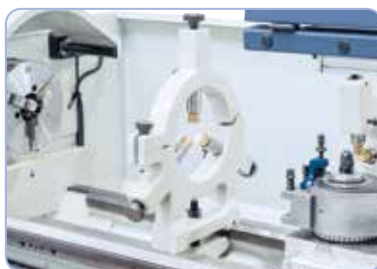
Stać podtrzymka z prowadnicą do stabilizowania długich przedmiotów obrabianych
