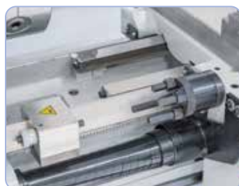
Mikrometryczny ogranicznik wzdłużny i ogranicznik rewolwerowy w zakresie dostawy.
