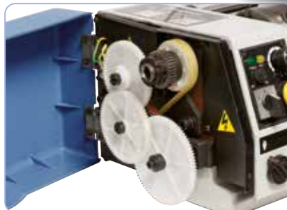
Opcjonalnie z wymiennymi kołami do gwintowania (0,5 - 1,25 mm)
