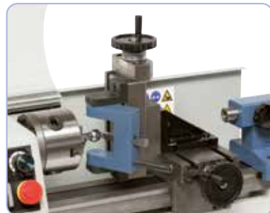
Pionowy suport frezowania z urządzeniem do toczenia kul (opcja)
