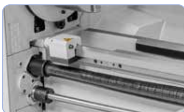
W zakresie dostawy mikrometryczny ogranicznik wzdłużny i sprzęgło cierne.
