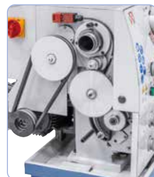
W zakresie dostawy kompletny zestaw wymiennych kół do gwintowania.
