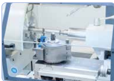
Maszyna w wyposażeniu standardowym posiada szybkowymienny uchwyt.
