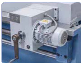
Zmotoryzowany mechanizm przesuwu konika (od rozstawu kół 3000 mm)
