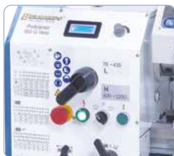
Przekładnia odboczkowa ułatwia nastawę przełożenia, ustawianie żądanej prędkości obrotowej potencjometrem.
