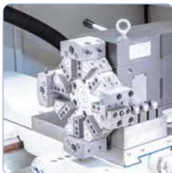
Mocny rewolwer narzędziowy z 8 stanowiskami.
