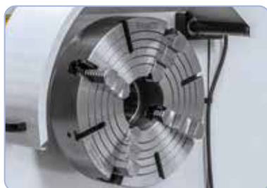
Uchwyt tokarski 400 mm (opcja) idealny do mocowania niesymetrycznych przedmiotów obrabianych.
