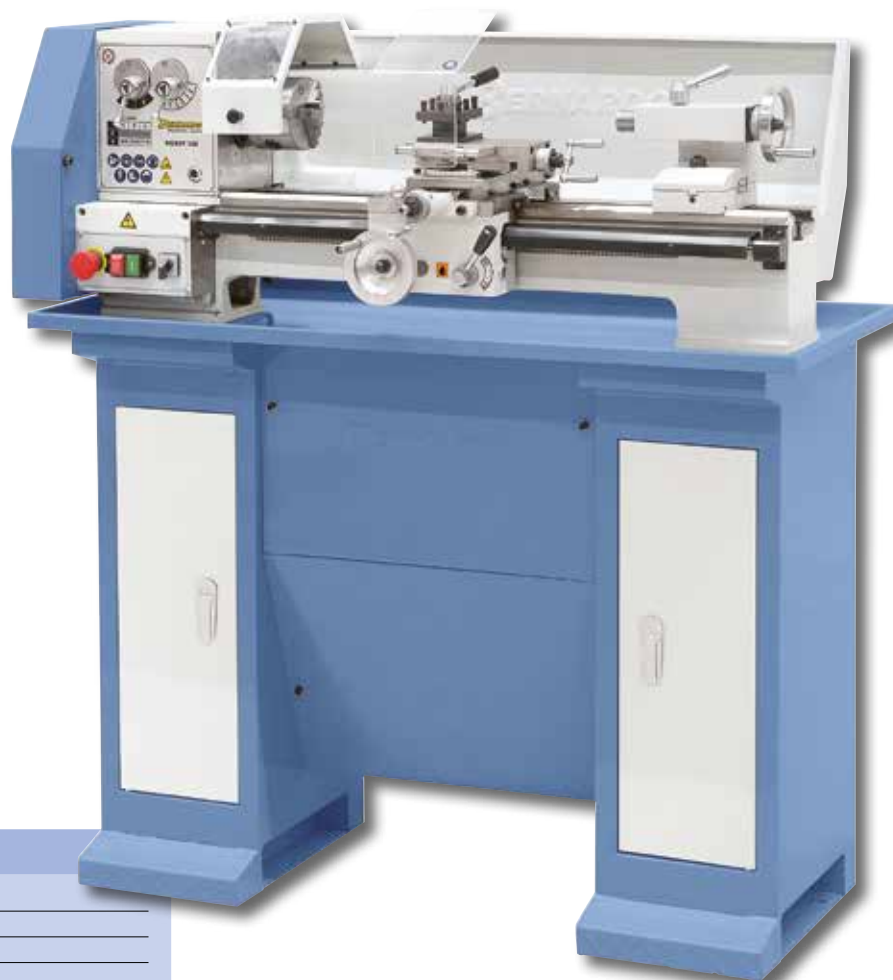
Swobodnie i precyzyjnie poruszające się sanie narzędziowe, długa żywotność dzięki bezluzowo regulowanym listwom blokującym
