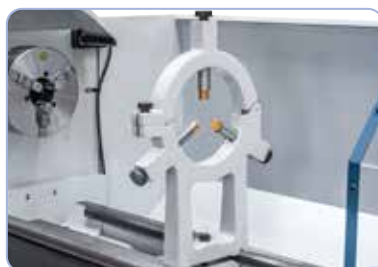
Stała podtrzymka z prowadnicą do stabilizowania długich przedmiotów obrabianych
