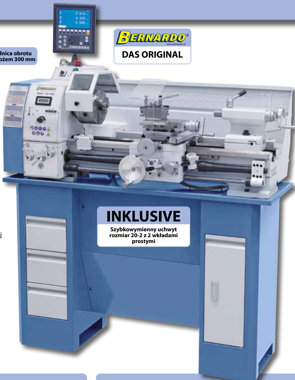
Łatwa regulacja stopnia prędkości obrotowej za pomocą pasków wielorowkowych
