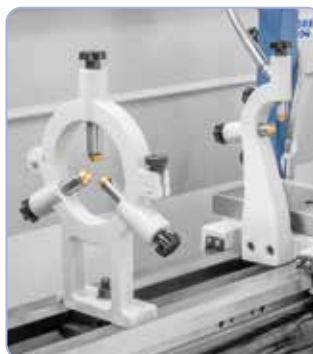
W wyposażeniu standardowym ze stałą i ruchomą podtrzymałą do unieruchamiania długich przedmiotów obrabianych.
