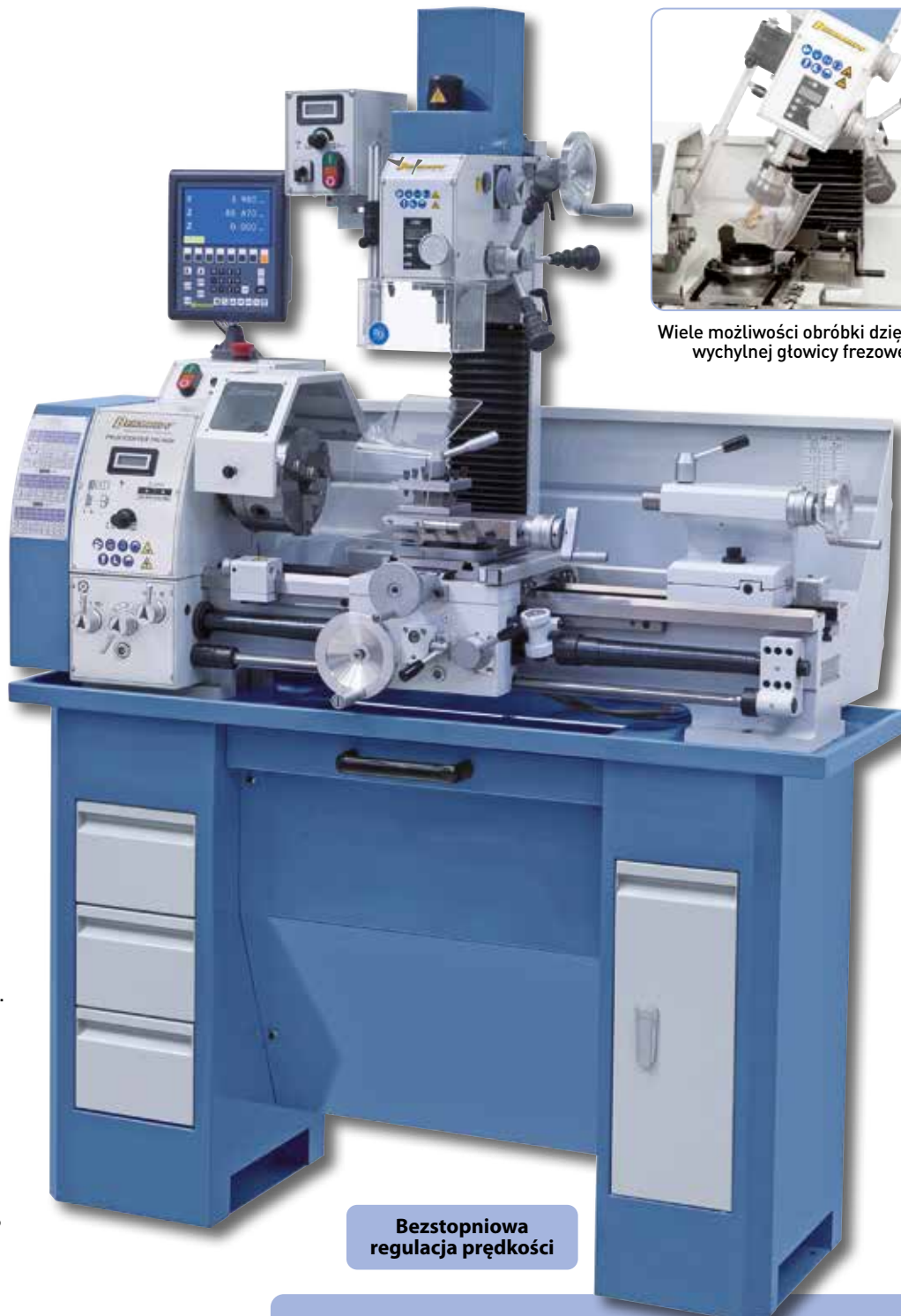
Sanie z kołami ręcznymi z precyzyjną skalą. Dodatkowo model ten jest wyposażony w automatyczny posuw poprzeczny.
