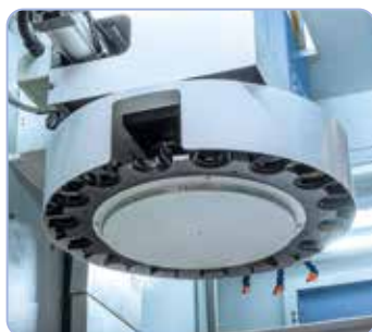
16-miejscowa zmieniarzka narzędzi zapewniająca krótkie czasy przezbierania
