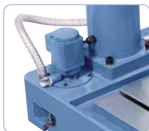
W zakresie dostawy wydajna pompa czynnika chłodzącego
