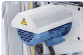
Silnik pozycjonujący regulacji wysokości (oś z) stołu.
