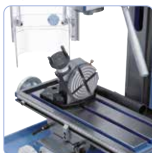
Opcjonalny stół okrągły zwiększający zakres zastosowań.
