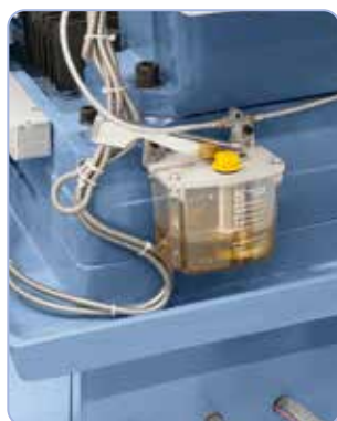
W wyposażeniu standardowym z ręczne centralne smarowanie wszystkich torów prowadzących
