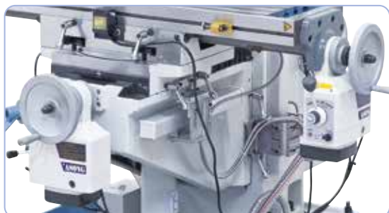
W wyposażeniu standardowym z automatycznym posuwem stołu w osi x i y
