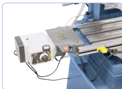
Posuw kła można ustawić do wyboru na 0,10 / 0,18 lub 0,26 mm/obr.
