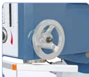
Koło ręczne umożliwia skok kąta do 100 mm.
