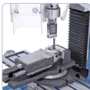
Opcjonalnie maszyna może być wyposażona w głowicę do wytaczania.
