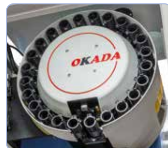
W wyposażeniu seryjnym 24-krotny zmieniacz narzędzi.
