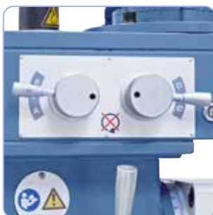
Łatwa obsługa przetaczników zmiany prędkości obrotowej
