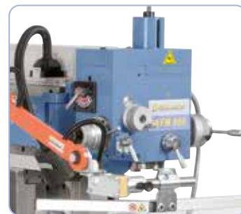
Pionowa obrotowa głowica frezująca umożliwia skok kąta do 60 mm i posiada 3 automatyczne zakresy posuwu.
