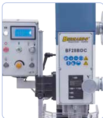
W zakresie dostawy elektroniczny wskaźnik prędkości obrotowej i głębokości wiercenia
