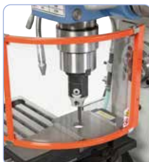
W wyposażeniu opcjonalnym: głowica do wytaczania o śr. 75 mm i imadło maszynowe śrubowe z szerokim mocowaniem FJ 125
