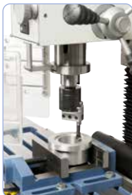
Opcjonalnie maszyna może być wyposażona w głowicę do wytaczania.
