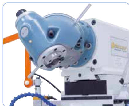
Uniwersalna głowica frezu, ustawiana pod różnymi pozycjami kątowymi
