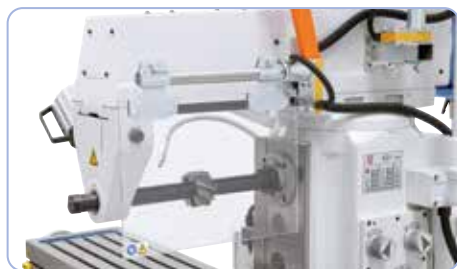
W wyposażeniu standardowym z podtrzymańką i długim trzpieniem frezowym do frezowania poziomego.
