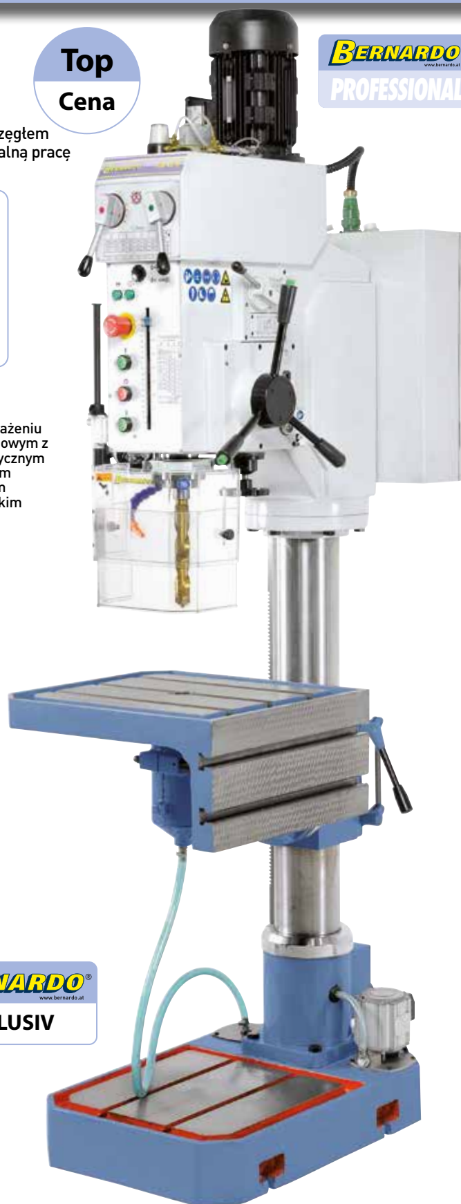
Masywny, obracany i wychyłny stół kostkowy zapewnia uniwersalne możliwości mocowania
