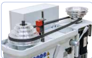
Wyrównoważone koła napędowe z aluminium i wysokiej jakości paski zapewniają wysoką kulturę pracy i optymalne przeniesienie napędu.
