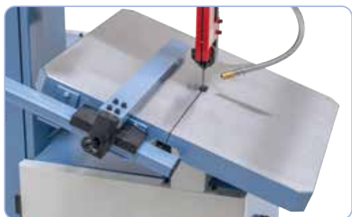
Kantelbare werktafel van grijs gietijzer
