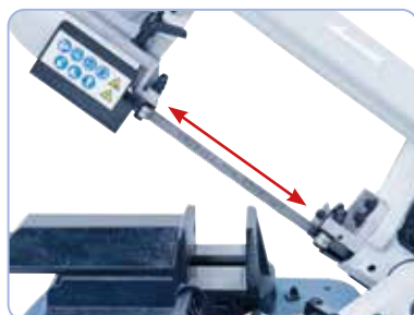
Zaagbladgeleiding kan worden aangepast aan de materiaalbreedte
