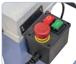
Veiligheidsschakelaar met onderspanningsschakelaar en aparte noodstop-schakelaar, automatische einduitschakeling na voltooien van het zaagproces
