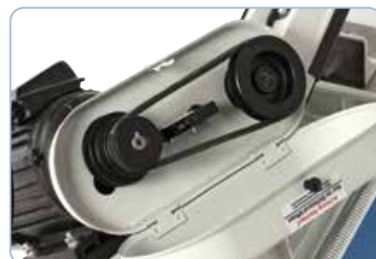
D.m.v. V-snaren kan de zaagbandsnelheid snel en makkelijk gewisseld worden
