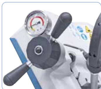
Optimaal instellen van de zaagbandspanning d.m.v. manometer
