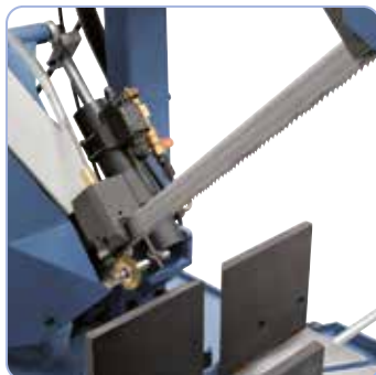
Kogelgelagerde zaagbandgeleiding en spanenborstel voor optimale zaagresultaten
