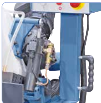
Groot bemeten hydraulische cylinder voor traploze neerlaat van de zaagbeugel
