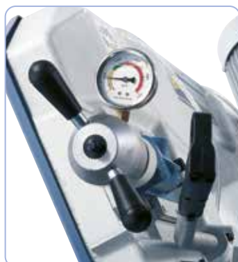
Controle van de zaagbandspanning d.m.v. manometer
