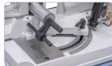
De zaagbeugel kan voor verstekzagen van +45° tot -60° versteld worden
