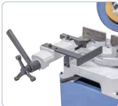
Groot bemeten materiaalklem met snelspanhendel voor nauwkeurig zagen.
