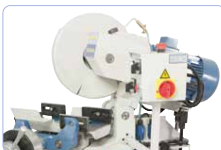
Aandrijfkop naar rechts en links 90° zwenkbaar
