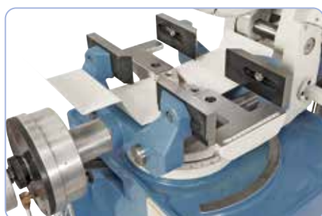
Pneumatische snelspanmateriaalklem voor korte steltijden
