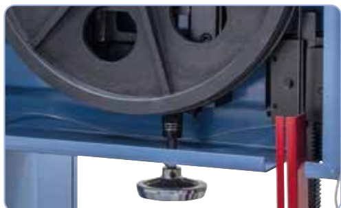
De instelling van de bladspanning gebeurt via een handwiel
