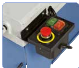
Veiligheidsschakelaar met onderspanningsschakelaar en aparte noodstop-schakelaar, automatische einduitschakeling na voltooiën van het zaagproces
