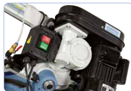
D.m.v. V-snaren kan de zaagsnelheid (24 / 41 / 61 / 82 m/min) gewisseld worden
