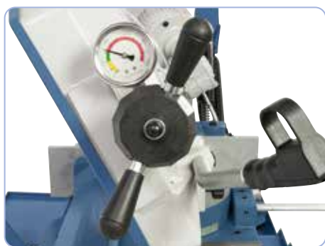
De standaard manometer maakt een optimaal instellen van de zaagbandspanning mogelijk
