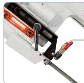
Kogelgelagerde zaagbandgeleiding, instelbaar op werkstukbreedte
