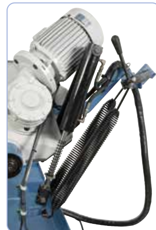
Trekveer met instelhendel voor het omschakelen naar handmatig gebruik
