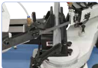
Zwenkbare zaagbeugel voor verstekzagen van -45^\circ tot +45^\circ verstelbaar
