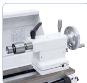
Voor universele inzet is optioneel een meelopende centerpunt type SMA met 7 uitwisselbare inzetten leverbaar
