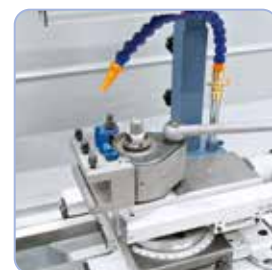
Voor economisch werken kan de machine met een snelwisselbeitelhouder uitgerust worden.
