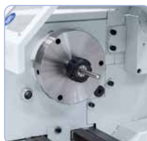
De spantanghouder ER25 garandeert een hoge nauwkeurigheid bij het opspannen van werkstukken, 1 - 16 mm
