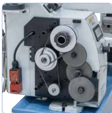
Standaard uitgerust met wisselwielen voor draadsnijden
