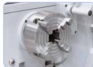
Klauwplaat 200 mm (optie) ideaal voor het opspannen van asymmetrische werkstukken
