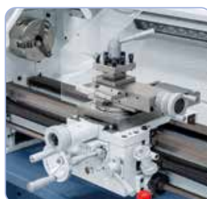
Licht lopende slede met bovenondersteuning en viervoudige stalen houder, handwielen met instelbare metrische fijnschaling
