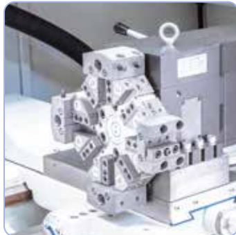
Robuuste gereedschapsrevolver met 8 stations.
