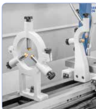
Voor het stabiliseren van lange werkstukken standaard met een vaste resp. een meelopende bril uitgevoerd.
