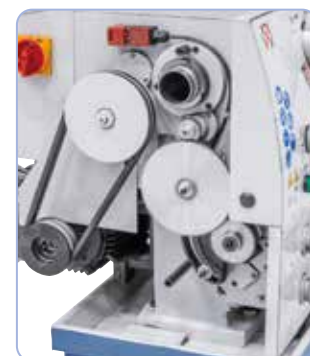
Geleverd compleet met wisselwielen voor schroefdraad snijden
