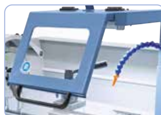
Geïntegreerde LED-machineverlichting in stalen houder voor optimale belichting tijdens het werken.
