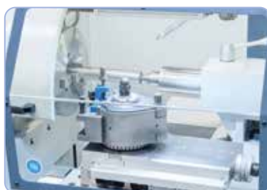
Voor economisch werken is de machine met een snelwisselbeitelhouder uitgerust.
