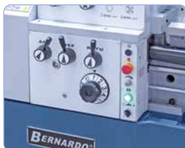
Voedingsaandrijving licht en nauwkeurig schakelbaar, geslepen tandwielen zorgen voor rustige loop
