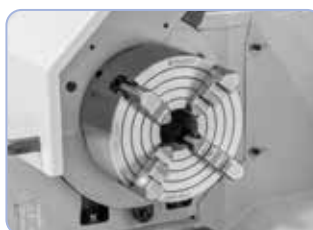
Klawwplaat 200 mm (standaard) ideaal voor het inspannen van asymmetrische werkstukken
