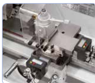
Voor economisch werken is de machine met een snelwisselbeitelhouder uitgerust.
