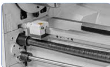
Micrometer-lengteaanslag en slipkoppeling meegeleverd
