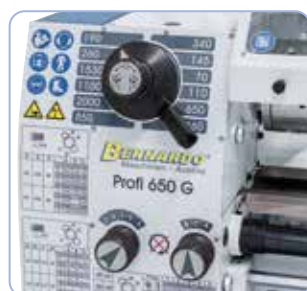
De aan de spindel aangebrachte schakelkast bemogelijkt een snelle en makkelijke toerentalwissel
