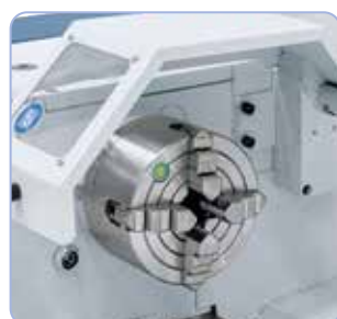
Klauplaat (optie) voor het inspannen van onregelmatig gevormde werkstukken
