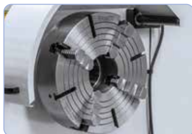
Klauplaat 400 mm (optie) ideaal voor het opspannen van asymmetrische werkstukken
