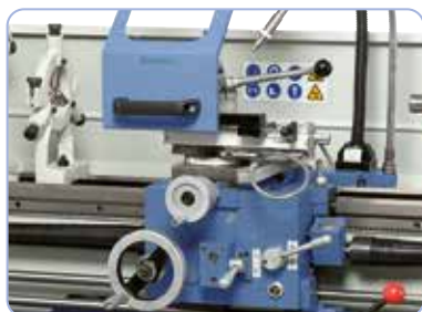
Licht lopende en exacte slede met bovenondersteuning en viervoudige stalen houder, handwielen met instelbare metrische fijschaling
