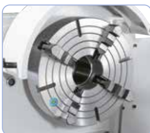
Klawwplaat 400 mm (optie) ideaal voor het opspannen van asymmetrische werkstukken
