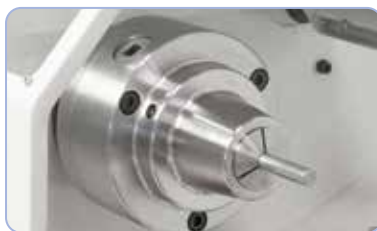
Optioneel leverbaar: spantangenhouder 5C, spanbereik 3-26 mm
