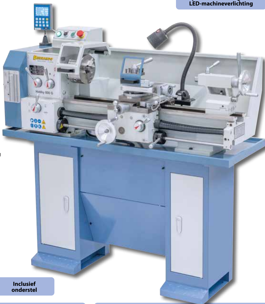
De losse kop met eenhendel klemming kan voor conisch draaien verschoven worden, naar wens met centreerkegel leverbaar.
