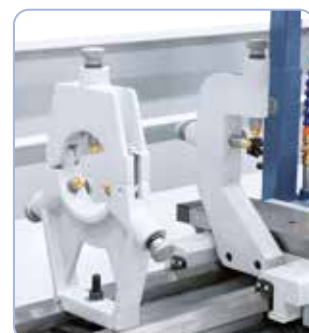
Voor het stabiliseren van lange werkstukken standaard met een vaste resp. een meelopende bril uitgevoerd.
