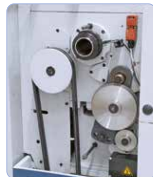
Geleverd compleet met wisselwielen voor schroefdraad snijden
