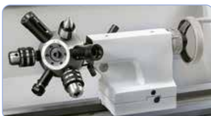
Optioneel leverbaar: revolverkop met 6 stations
