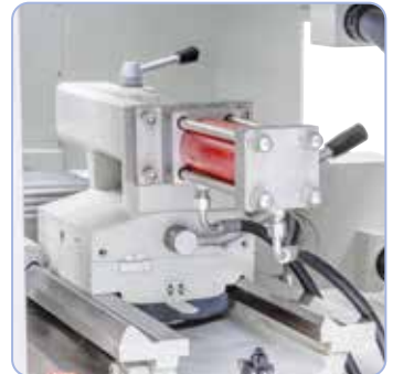
Standaard hydraulische verstelling van de pinole.
