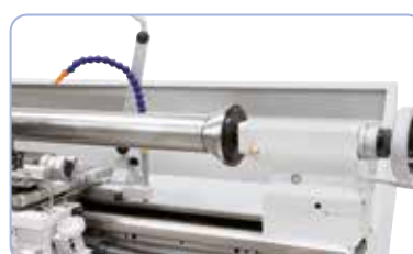
Centreerkegel diam. 125 mm, ideaal voor het opspannen van buizen en holle voorwerpen (optioneel)
