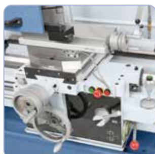
Standaard met snelgang ter reducering van de steltijden uitgevoerd
