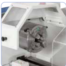
Klauwplaat (optie) voor het inspannen van onregelmatig gevormde werkstukken
