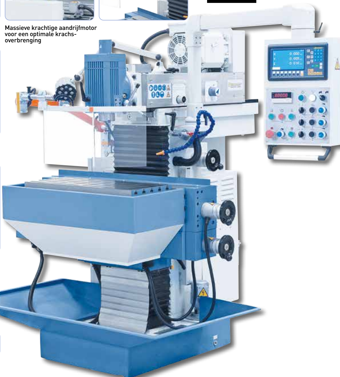
Groot bemeten pinole (Ø 90 mm) zorgt voor de hoogst mogelijke stabiliteit
