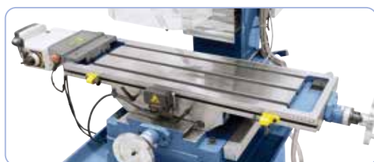
Groot bemeten kruistafel met T-groeven en koelmiddelgoot. Afbeelding met optionele freestafelvoeding AL 450 D
