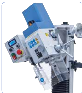
Tweezijdig zwenkbare Freeskop van -90° tot +90°
