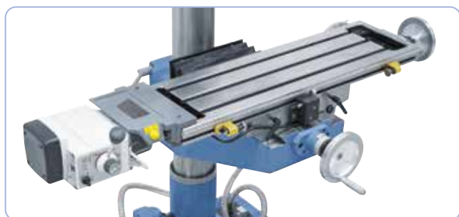
Groot bemeten kruistafel met T-groeven en koelmiddelgoot. Afbelijding met optionele freestafelvoeding AL 450 D
