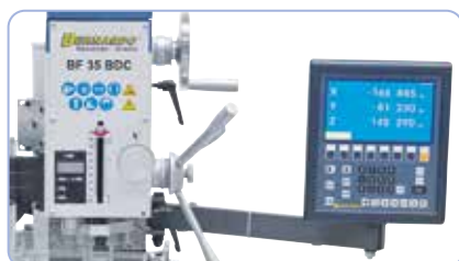
Digitale meter Bernardo ES-12 V in x-, y en z-as is inbegrepen bij levering (Art. nr. 02-1117).
