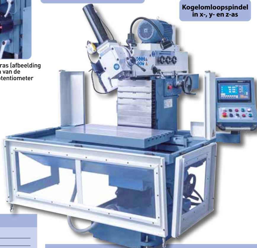
Overzichtelijk geplaatste schakelementen op het draaibare bedieningspaneel, standaard met 3-assige digitale meter met LCD-scherm.
