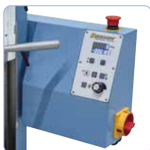
Gebruiksvriendelijke bediening via tiptoetsen. Standaard digitale toerental en boordiepteuitleiding
