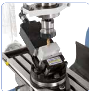
Frezen met 2 assige machineklem
