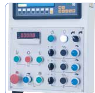
Snelle en makkelijk instellen van de gewenste voedingssnelheid direct aan het bedieningspaneel.
