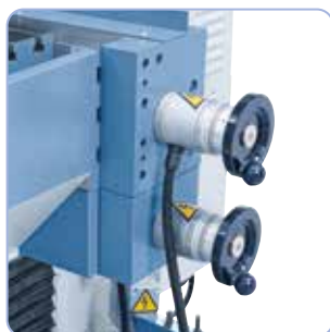
Standaard met elektronische handwielen voor verplaatsen over de x-, y- en z-assen.
