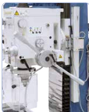
De pinolevoeding kan naar keuze op 0,10 / 0,18 of 0,26 mm/omw. ingesteld worden
