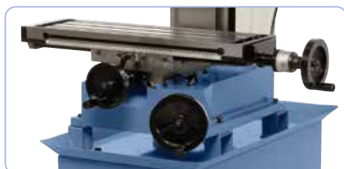
Gebruiksvriendelijke freeskop hoogteverstelling d.m.v. handwiel aan de voorzijde
