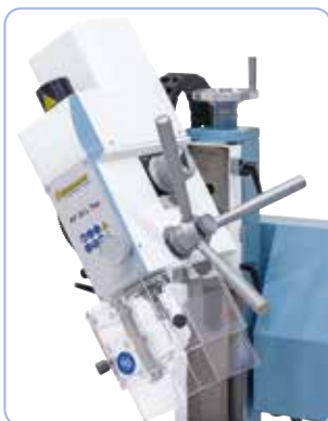
Tweezijdig zwenkbare Freeskop van -90° tot +90°
