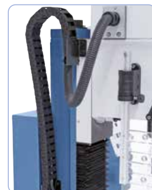
Inclusief kabelgeleiders via kabelruips
