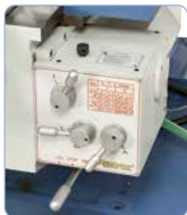
Door de standaard tafelvoeding met snelgangfunctie in alle 3 de assen worden de insteltijden aanzienlijk verkort.
