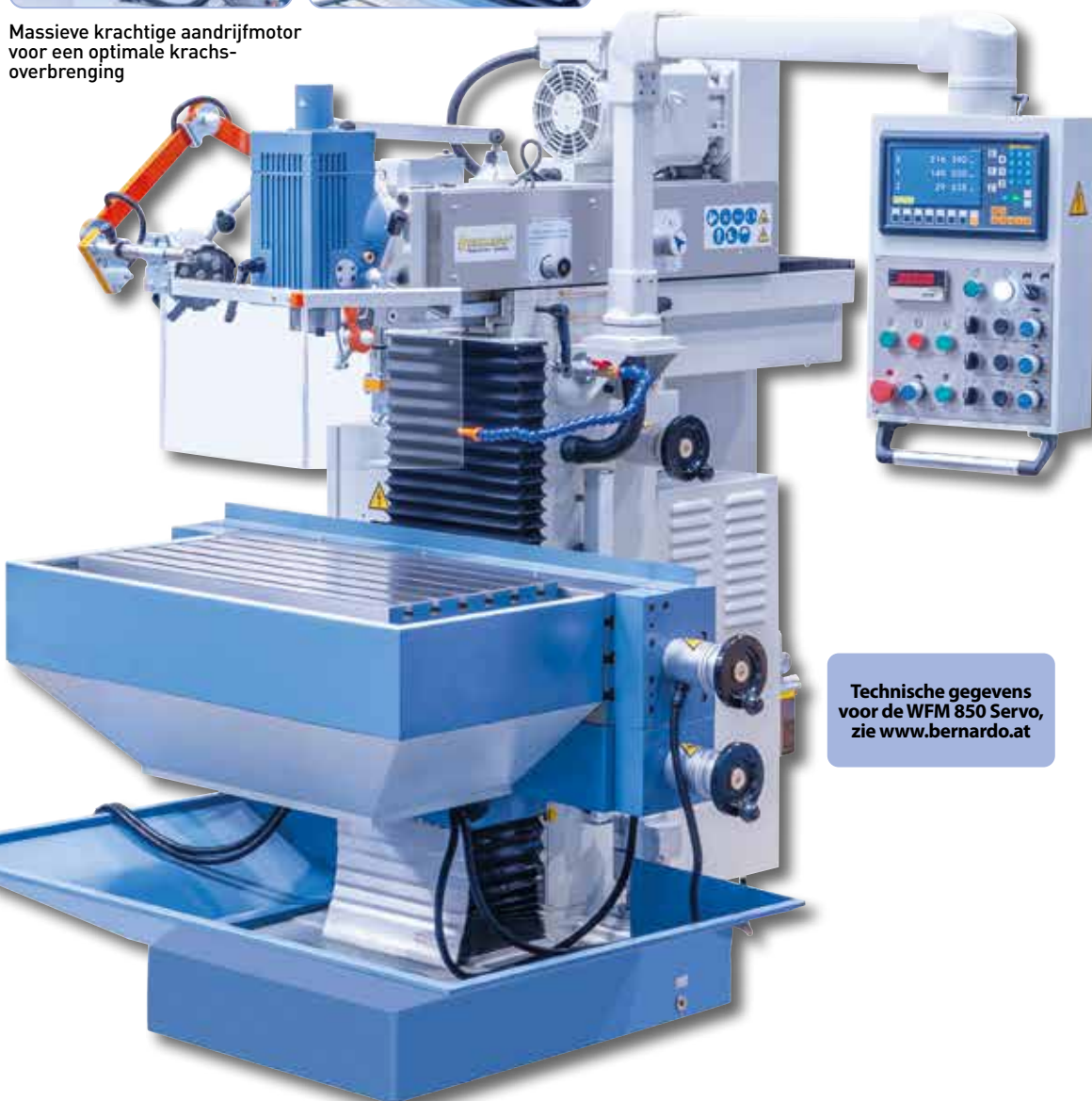
Groot bemeten pinole (Ø 90 mm) zorgt voor de hoogst mogelijke stabiliteit
