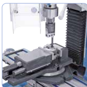
Naar wens kan de machine met een uitdraaikop worden uitgevoerd.
