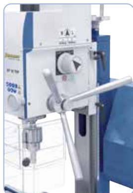
Grote stergreep voor makkelijke pinoleafstelling bij boren, handwiel voor fijnaafstelling bij frezen.
