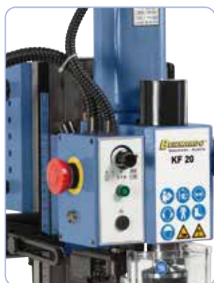
Toerentalregeling d.m.v. elektronische traploos regelbare gelijkstroommotor
