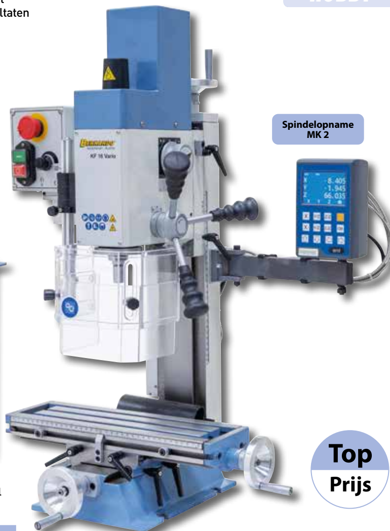
Afbeelding met onderstel BF 1 (optie) en gedraaide freeskop
