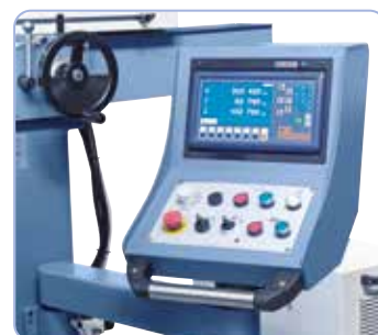
Overzichtelijk geplaatste schakelementen op het draaibare bedieningspaneel, standaard met 3-assige digitale meter met LCD-scherm.
