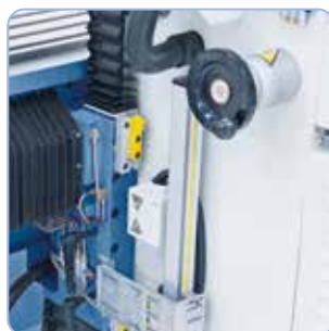
Standaard met elektronische handwielen voor verplaatsen over de x-, y- en z-assen.
