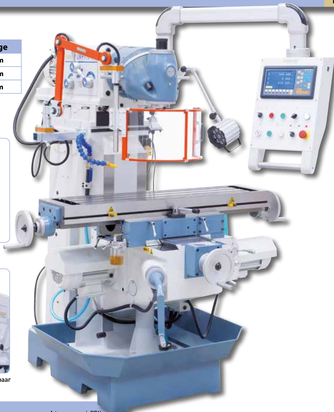
Digitale uitlezing in alle 3 de assen ter reducering van de steltijden
