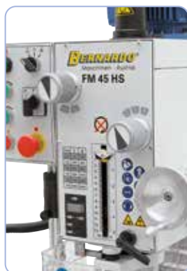
Makkelijke en snelle toerentalwissel d.m.v. schakelhendel.
