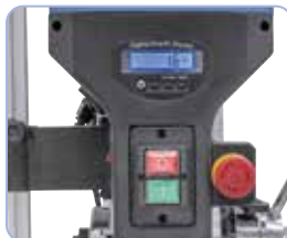
Digitale boordiepte-aanduiding voor comfortabel werken.
