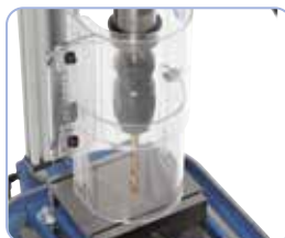
Nauwkeurig werken door de standaard kruislijn laserinrichting.
