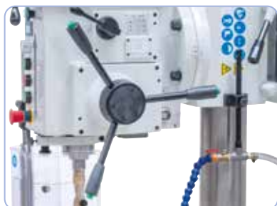
Standaard met automatische 3-traps voeding uitgevoerd
