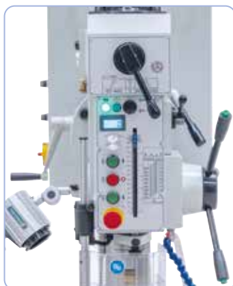
Makkelijk instellen van de juiste voeding, instellen van het gewenste toerental door middel van potentiometer
