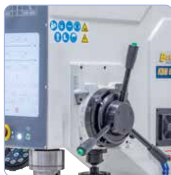
Voor exact werken is de machine standaard uitgerust met een automatische spindelvoeding, evenals een digitaal boordiepte display.
