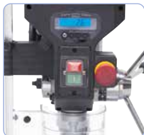
Aan-uit schakelaar volgens IP 54 en separate noodstop volgens CE-normering
