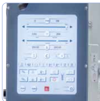
Groot aanraakscherm voor alle instelwerkzaamheden zoals snelheid, boren, rechts- en linksloop, hoogteverstelling van de boortafel, enz.
