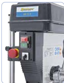
Alle schakelementen zijn gebruiksvriendelijk aangebracht op de machinekop.
