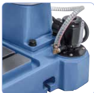
Nauwkeurig bewerkte machinevoet, standaard met geïntegreerde koelmiddelpomp. (DMT 32 PFC).
