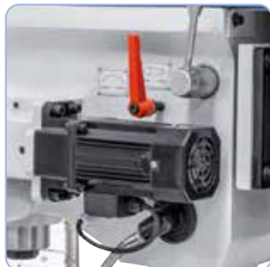
Traploos instelbare pinoletoevoer met aparte aandrijfmotor.
