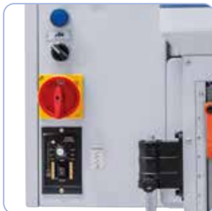
De gewenste toevoersnelheid wordt ingesteld met behulp van een potentiometer.
