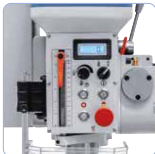
Standaard uitgerust met een digitaal toerental display. Ergonomisch aangebrachte schakel- en bedieningselementen aan de voorzijde. (DMT 25 PFV).
