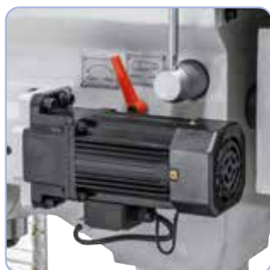
Traploos instelbare pinoletoevoer met aparte aandrijfmotor.
