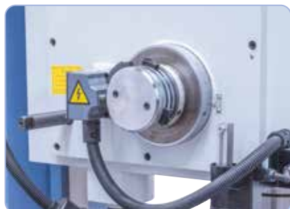
Tapinrichting met snel- resp. werkvoeding en snelterugslag (vanaf KBM 63)
