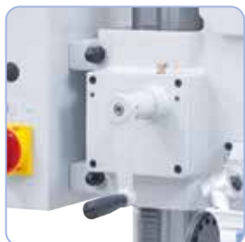
Boorkop eenvoudig in hoogte verstelbaar middels zwengel.
