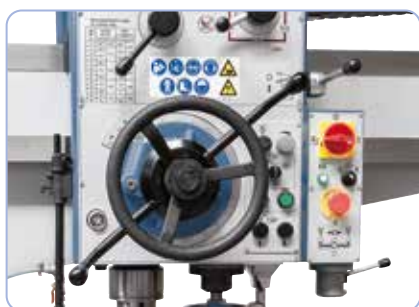
De boorspindel kan op drie manieren verplaatst worden: snelverplaatsing d.m.v. hengel, fijnverplaatsing via handwiel of met de automatische voeding.
