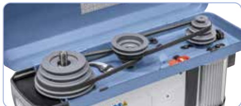
Hoogwaardige V-snaren zorgen voor een optimale krachtsoverbrenging
