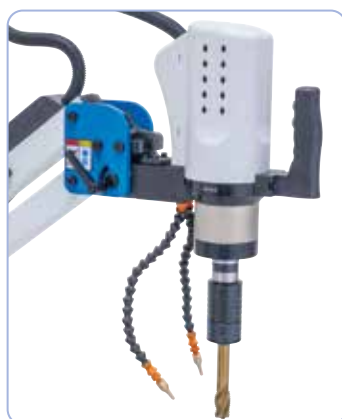
Standaard met microsproeisysteem en uitblaasinrichting.
