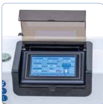
Comfortabele werken: instellen van de draadmaat, helling, het toerental en de boordiepte rechtstreeks op het geïntegreerde aanraakscherm.
