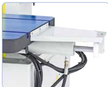
Cilindri idraulici per l'avanzamento della tavola
