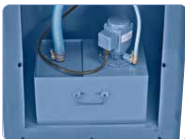
Potente impianto di refrigerazione, collocato nel basamento con un risparmio dello spazio
