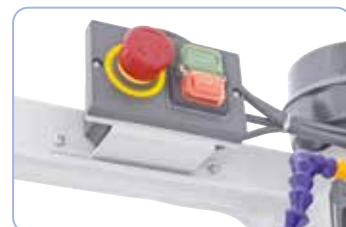
Interruttore di sicurezza con rilascio di minima tensione e un interruttore di arresto di emergenza separato
