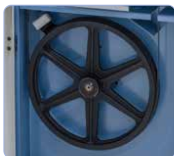
La ruota motrice con rivestimento in gomma speciale assicura un funzionamento regolare e aumenta la durata della lama
