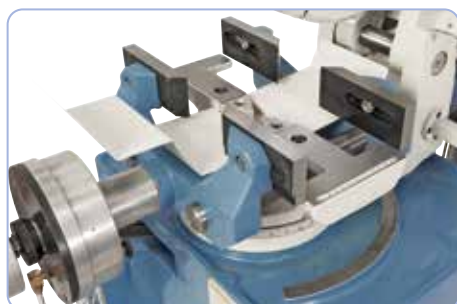
Stock viti di serraggio rapido pneumatico per tempi di messa a punto brevi
