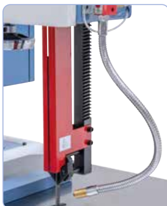
Sistema di microspruzzatura e battuta longitudinale inclusi nella fornitura.
