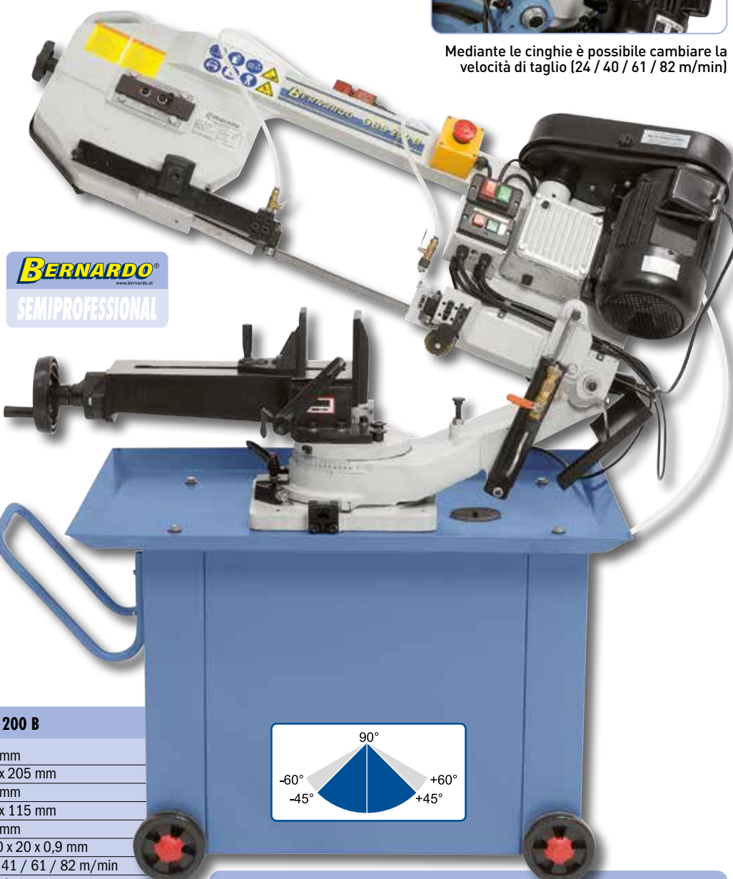
Seghetta ad arco inclinabile per tagli obliqui regolabile da -45^\circ fino a +45^\circ
