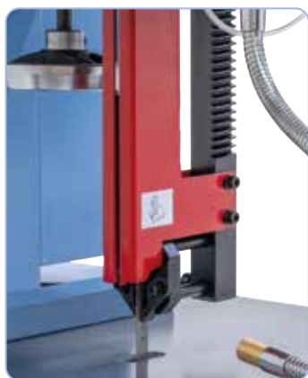
Guida a nastro con ganasce guida a V temprate e rettificate
