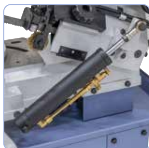
Cilindro idraulico di grandi dimensioni per un abbassamento continuo della seghetta ad arco
