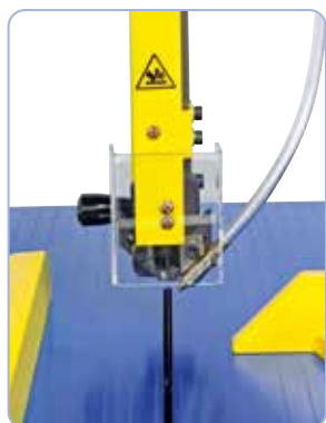
Dispositivo per il soffiaggio per una visione ottimale della linea di sezione
