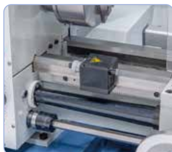
Battuta longitudinale del micrometro e giunto di slittamento in dotazione
