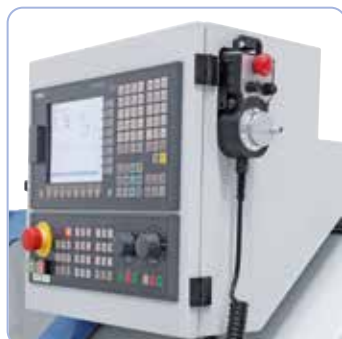
Unità di comando Siemens 808D Advanced di serie con numerose funzioni preprogrammate
