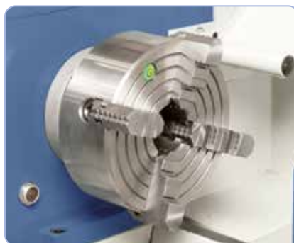
Piattaforma 200 mm (standard) ideale per il serraggio di pezzi asimmetrici
