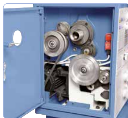
La fornitura comprende ruote di ricambio per la filettatura
