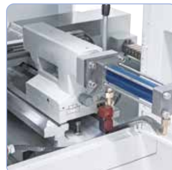
Regolazione idraulica del mandrino contropunta di serie.
