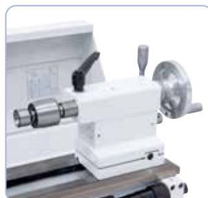
Per l'uso universale è disponibile in modo opzionale una punta di centraggio tipo SMA con 7 inserti intercambiabili
