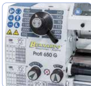
Il circuito di trasmissione sulla testa mandrino permette una variazione della velocità semplice e veloce
