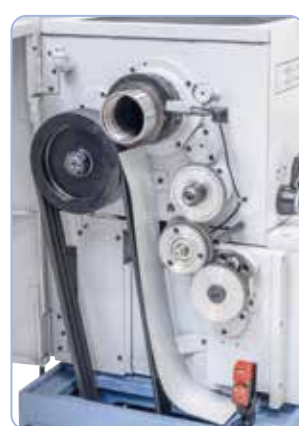
Mandrino principale temprato con cuscinetti a rulli conici di precisione per un'elevata concentricità, trasmissione ottimale di potenza grazie alle cinghie dentate Optibelt
