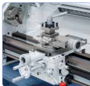
Slitte regolari con supporto superiore e porta-utensili quadruplo, volantini con scalatura di precisione metrica regolabile
