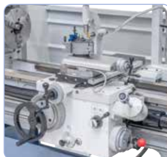
Per il movimento longit. e trasversale della slitta o del supporto superiore, sono disponibili 42 sistemi di avanz. selezionabili liberamente.
