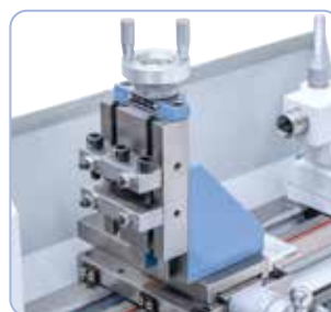
Il supporto di fresatura verticale può essere montato successivamente per lavorazioni supplementari.
