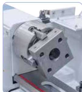
Piattaforma 100 mm (opzionale) per il serraggio di pezzi di forma irregolare
