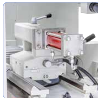
Regolazione idraulica del mandrino contropunta di serie.
