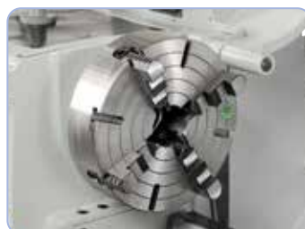
Piattaforma 320 mm (opzionale) ideale per il serraggio di pezzi asimmetrici
