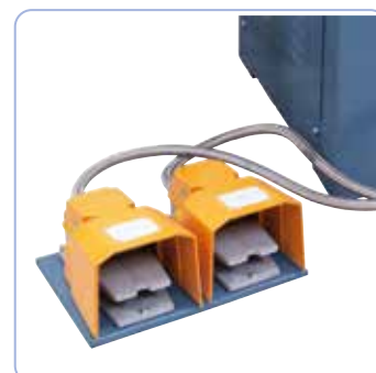
Con pedale di serie per il bloccaggio del mandrino a griffe o lo spostamento del mandrino della contropunta.
