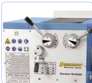
Funzionamento semplice, elementi di commutazione e funzionali disposti in maniera intuitiva sul riduttore
