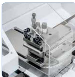
Slitte regolari con supporto superiore e porta-utensili quadruplo, volantini con scalatura di precisione metrica regolabile
