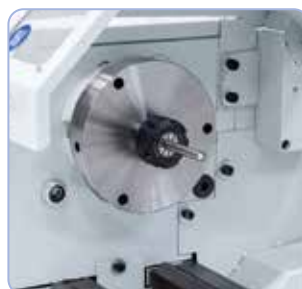
Il mandrino porta pinze ER 25 garantisce un'elevata concentricità per il bloccaggio di pezzi, intervallo di serraggio 1-16 mm
