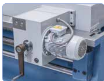
Contropunta regolabile a motore (da distanza tra le punte 3000 mm)
