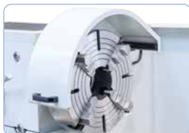
Piattaforma 400 mm (opzionale) ideale per il serraggio di pezzi asimmetrici
