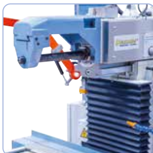
Dotato di supporto esterno e lungo mandrino per la fresatura in posizione orizzontale.
