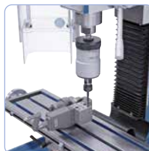
Per la filettatura, è possibile che la macchina sia dotata di un apparato per la filettatura di M5 - M12
