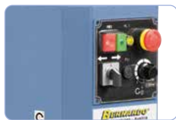
Pratica disposizione degli elementi di commutazione sulla testa di fresatura
