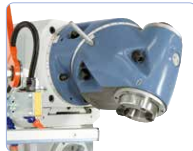
Testa di fresatura universale con 2 assi rotanti, regolabile in tutte le posizioni angolari.
