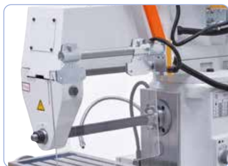
Dotato di supporto esterno e lungo mandrino per la fresatura orizzontale
