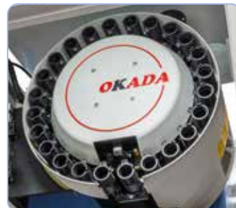
Dotato di serie di un cambiautensile a 24 postazioni.
