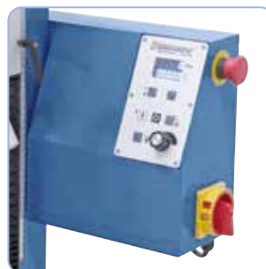
Funzionamento semplice tramite tastiera a membrana.
