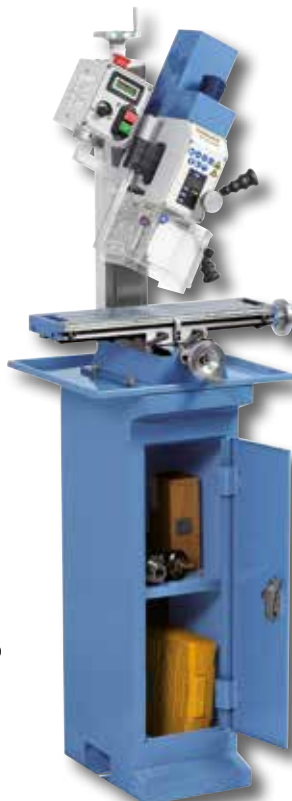
Visualizzatore della velocità e della profondità di foratura digitale in dotazione
