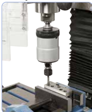
Per la filettatura, è possibile che la macchina sia dotata di un apparato per la filettatura di M5 - M12
