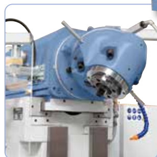
Grazie alla regolazione dei piani a 90° e 45°, la testa inclinabile universale può essere regolata per qualsiasi posizione angolare.
