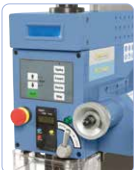
Display digitali di facile lettura, funzionamento semplice tramite tastiera a membrana.
