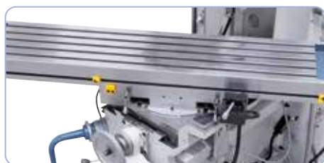
Tavola per la foratura inclinabile da -45° a +45°.
