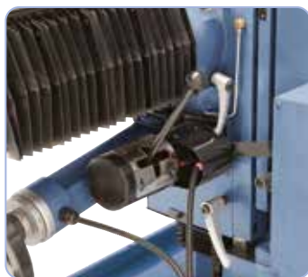
Leva selettiva per asse di avanzamento (illustr. per assi x e z), regolazione della velocità di avanzamento mediante potenziometro situato sul pannello di controllo.
