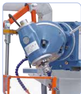
Testa di fresatura universale, regolabile per diverse posizioni angolari.
