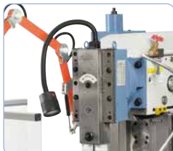
La testa per stozzare (opzionale), con corsa regolabile, può essere orientata verso sinistra o verso destra.
