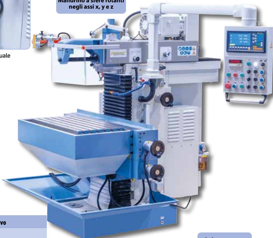
Regolazione della velocità di avanzamento desiderata semplice e veloce, direttamente sul pannello di controllo.
