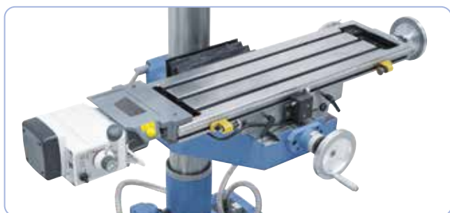
Grande tavola composta con scanalature a T e un canale di raffreddamento. Figura con avanzamento tavolo di fresatura opzionale AL 450 D
