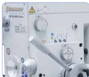
L'alimentazione del mandrino può essere impostata a 0,10 / 0,18 o a 0,26 mm/giro
