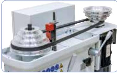
Pulegge in alluminio levigate ad alta silenziosità di funzionamento; le cinghie di alta qualità garantiscono la trasmissione ottimale della potenza.
