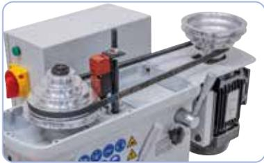
Pullegge in alluminio levigate ad alta silenziosità di funzionamento; le cinghie di alta qualità garantiscono la trasmissione ottimale della potenza.
