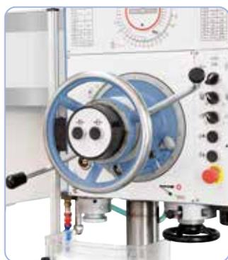
Elementi funzionali posizionati in maniera intuitiva, il serraggio del portapunta avviene direttamente sul volantino
