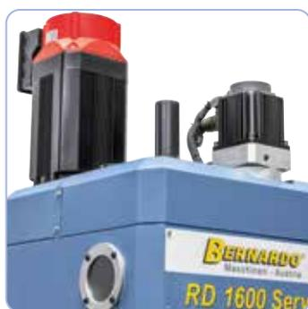
Dotato di serie di potenti servomotori per l'azionamento del mandrino e l'avanzamento della penna.
