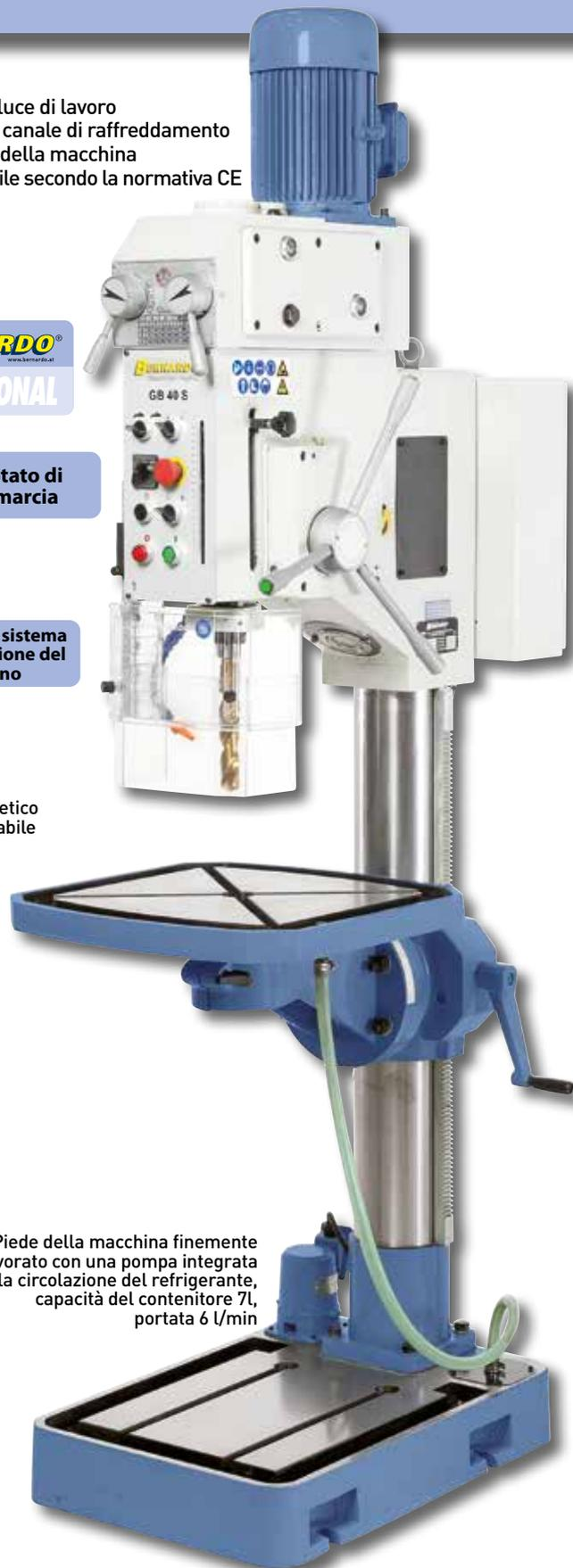
Piede della macchina finemente lavorato con una pompa integrata per la circolazione del refrigerante, capacità del contenitore 7L, portata 6 l/min
