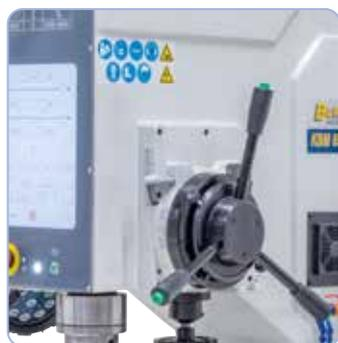
Per lavori di precisione, la macchina è dotata di un avanzamento automatico del mandrino e un visualizzatore della profondità di foratura
