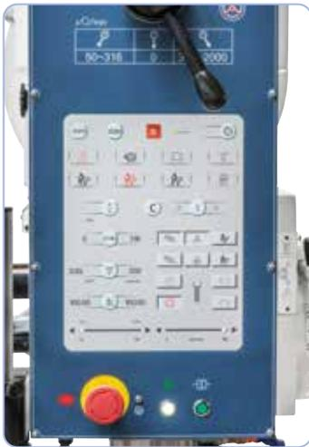
Touchscreen di grandi dimensioni per tutte le operazioni di impostazione, ad esempio velocità, foratura / filettatura, regolazione dell'altezza del braccio...
