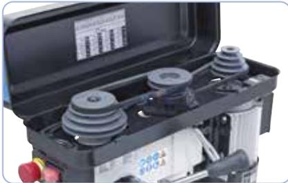
Pulegge di ghisa levigate ad alta silenziosità di funzionamento; le cinghie di alta qualità garantiscono la trasmissione ottimale della potenza
