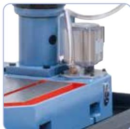
Piastra di fondo raschiata a mano, dotata di una pompa integrata per la circolazione del refrigerante.
