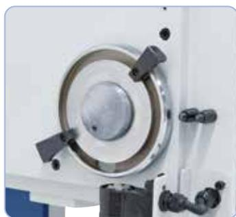
Dispositivo di filettatura con inversione della direzione, ideale per la produzione in serie (a KBM 50)
