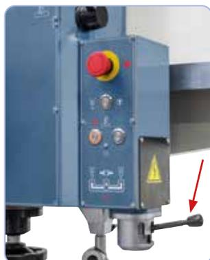
Cambio del senso di rotazione, ovvero l'innesto o disinnesto del mandrino ha luogo mediante l'interruttore pilota nella parte inferiore del portapunta
