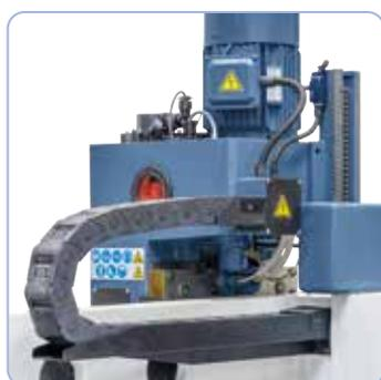
Contrappeso per il mandrino e la catena di conduzione dell'energia nella parte posteriore del portapunta
