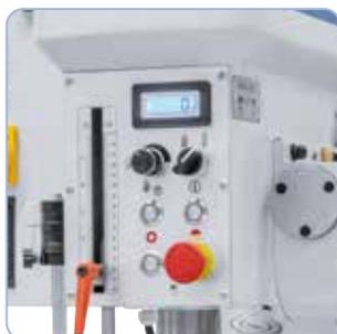
Dotato di un regolatore continuo della velocità. Elementi di commutazione e funzionali posizionati ergonomicamente sul lato anteriore
