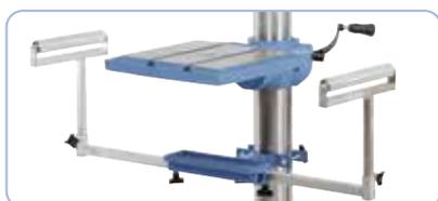
Per agganciare pezzi lunghi, la macchina può essere dotata di un supporto di perforazione estraibile
