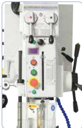
Regolazione della velocità semplice e veloce mediante il circuito di trasmissione nella parte anteriore. La velocità può essere letta sul display digitale
