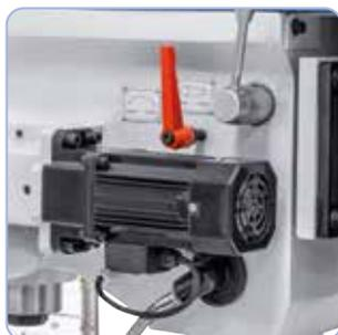
Avanzamento del mandrino regolabile in modo continuo con motore separato.
