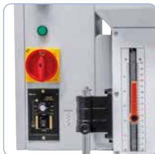
La velocità di avanzamento desiderata viene impostata tramite un potenziometro.
