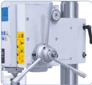
L'avvicinamento dei mandrini avviene manualmente o mediante avanzamento meccanico.
