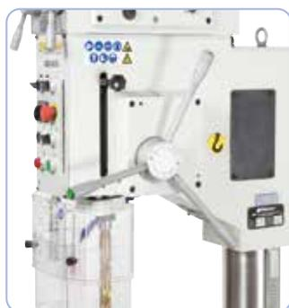
Per lavori di precisione, la macchina è dotata di un avanzamento automatico del mandrino e una luce di lavoro
