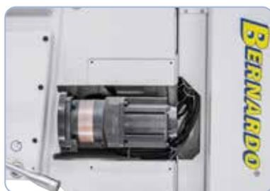
Fornito di serie con servomotore per l'alimentazione automatica della penna.
