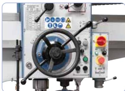
Il mandrino di foratura può essere spostato in 3 modi: regolazione rapida con leva manuale, avanzamento di precisione con il volantino o avanzamento automatico
