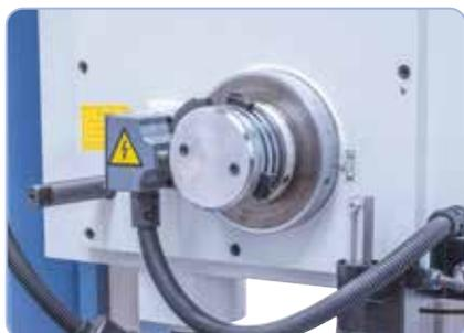
Dispositivo di filettatura con dispositivo di avanzamento rapido o avanzamento del lavoro e corsa di ritorno rapido (a KBM 63)
