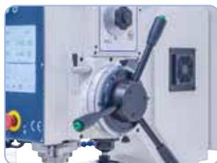
Per lavori di precisione, la macchina è dotata di un avanzamento automatico del mandrino e un visualizzatore della profondità di foratura
