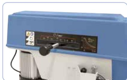
La regolazione del numero di giri avviene in maniera continua mediante la leva manuale sulla testa della macchina
