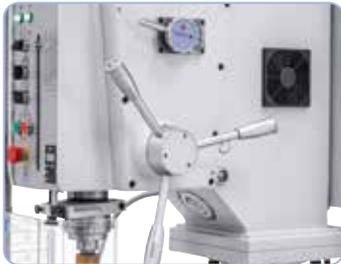
Per lavori di precisione, la macchina è dotata di un avanzamento automatico del mandrino e una luce di lavoro
