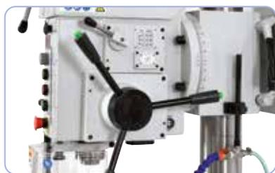
L'alimentazione del trapano avviene manual. o mediante accoppiamento elettromagn.
