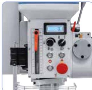
Dotato di un regolatore continuo della velocità. Elementi di commutazione e funzionali posizionati ergonomicamente sul lato anteriore (DMT 25 PFV).
