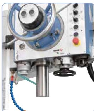
L'impostazione della velocità desiderata o dell'avanzamento avviene nella parte inferiore del portapunta
