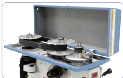
La trasmissione di velocità dal motore al mandrino avviene mediante un solido variatore.
