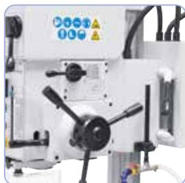
Dotato di 3 sistemi di alimentazione automatica del trapano
