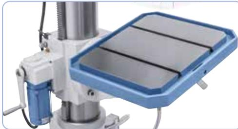
La grande tavola di foratura può essere inclinata e girata da -45° a +45°. Significativa riduzione dei tempi morti con l'elevatore motorizzato del tavolo
