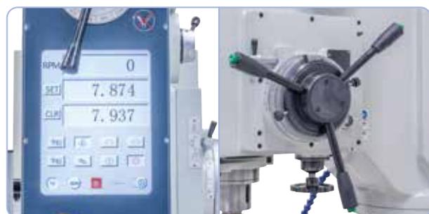
Per lavori di precisione, la macchina è dotata di un avanzamento automatico del mandrino e un visualizzatore della profondità di foratura
