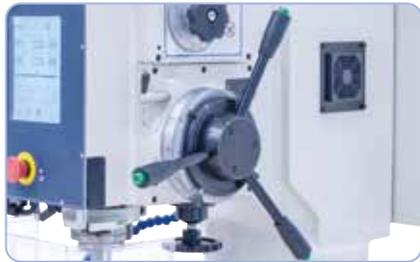
L'alimentazione del trapano avviene manualmente o mediante accoppiamento elettromagnetico
