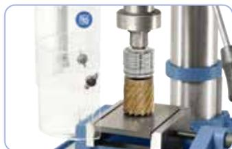
Alloggiamento intercambiabile rapido opzionale per l'utilizzo di fresa a corona
