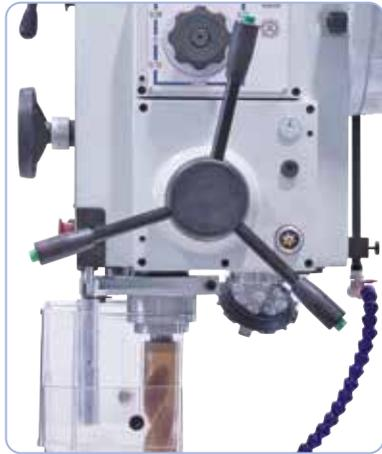
6 sistemi di alimentazione automatica attivabili mediante innesto elettromagnetico
