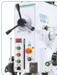
Massiccio riduttore con elementi di commutazione e funzionali posizionati ergonomicamente. Il display digitale per la regolazione della profondità di foratura e per la velocità sono in dotazione
