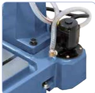
Piede della macchina finemente lavorato con una pompa integrata per la circolazione del refrigerante (DMT 32 C).
