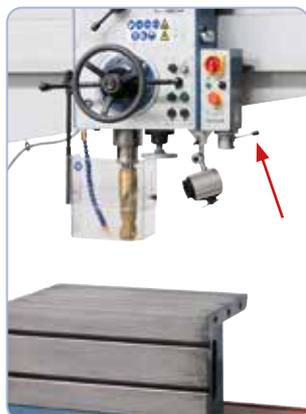
Cambio del senso di rotazione, ovvero l'innesto o disinnesto del mandrino ha luogo mediante l'interruttore pilota nella parte inferiore del portapunta
