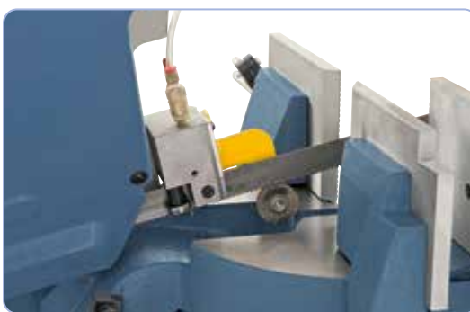
Golyóscsapágyas fűrészszalag-vezető és forgácskefe az optimális vágási eredményekért
