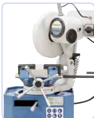
Elfordítható hajtóműfej [45° bal / jobb], optimális sarokvágásra
