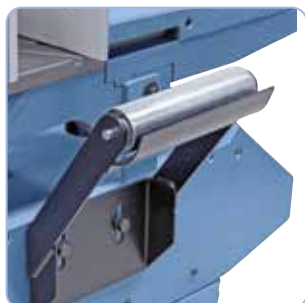
Sorozatszerűen görgős feltétellel munkadarabok megtámasztásához
