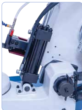
Sorozatszerűen hidraulikus süllyesztőhengerrel a fűrészkeggyel fokozatmentes süllyesztésre és automatikus végálláskapcsolással anyagvágás után
