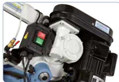
Ékszíj segítségével változtatható a sebesség (23 / 33 / 52 m/perc)
