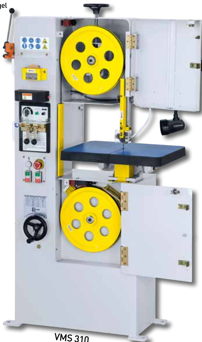
Golyóscsapágyas fűrészszalag-vezető, beállítható a mindenkori munkadarab magasságához
