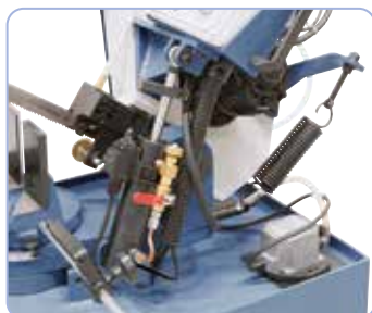
Hidraulikus henger a fűrészkeret fokozatmentes süllyesztésére
