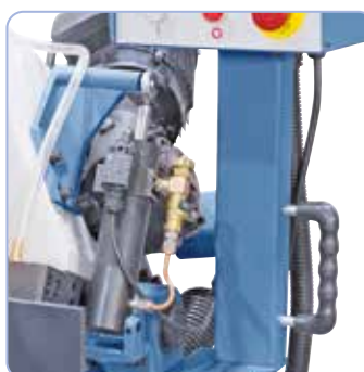
Nagyra dimenzionált hidraulikus henger a fűrészkenyel fokozatmentes süllyesztéséhez
