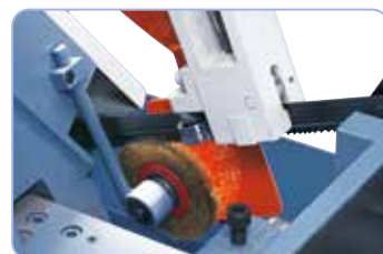
Golyóscsapágyas fűrészszalag-vezető és forgácsoló az optimális vágási eredményekért
