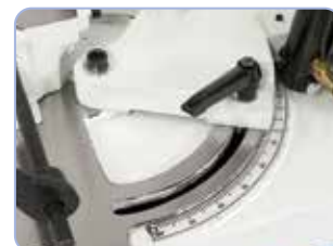
Elfordítható fűrészkeggyel kettős sarkalóvágáshoz +45°-tól -60°-ig
