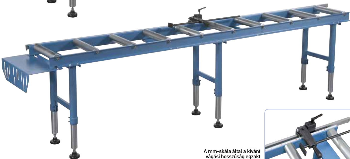
Stabil anyagütköző, igény esetén felnyitható
