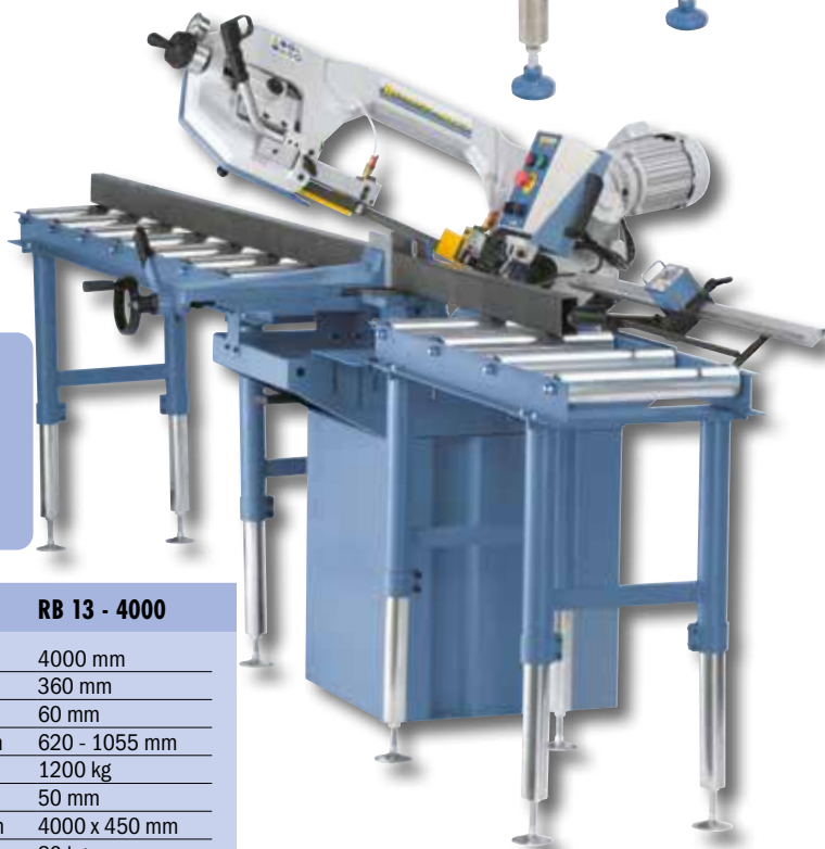
Kétoldalt golyóscsapágyas acélgörgők a nagy terhelhetőség érdekében
