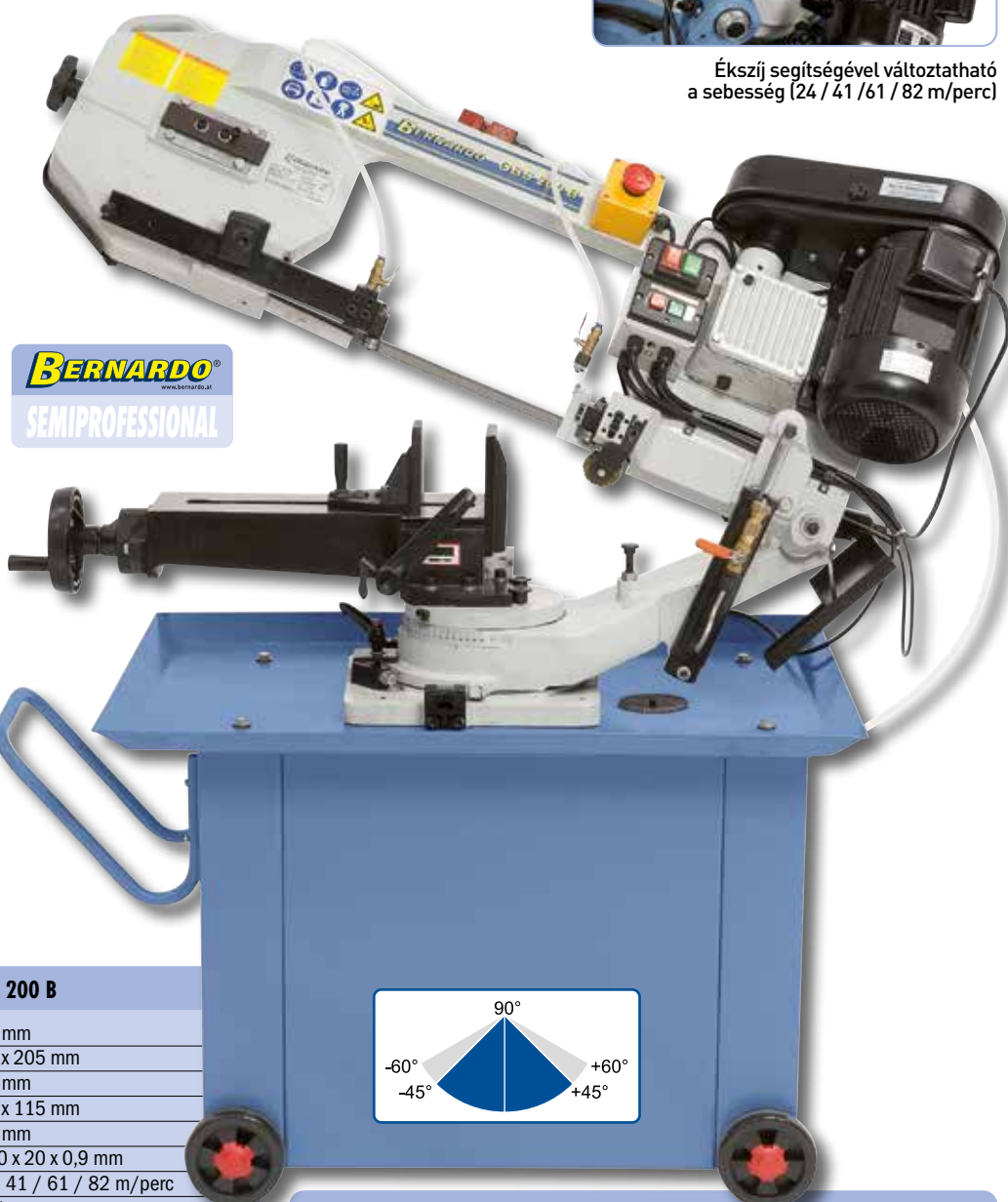
Elfordítható fűrészkeggyel sarokvágáshoz -45^\circ -tól +45^\circ -ig állítható
