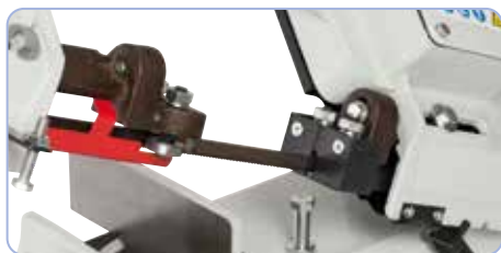
Golyóscsapágyas fűrészszalag vezető a precíz vágásokért
