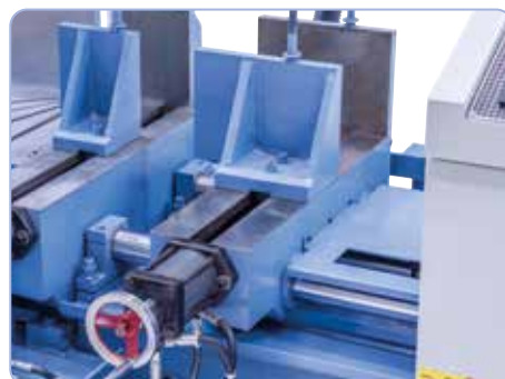
Anyagelőtolás hidraulikus feszítőszerkezeten és precíz körvezetőn keresztül
