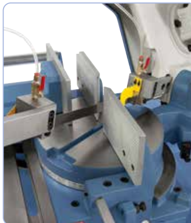
A fűrészrés a forgótányérban egyidejűleg mozog a fűrészkenyvel.
