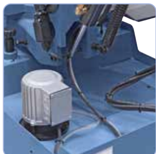
Sorozatszerűen nagyteljesítményű hűtőanyag-szivattyúval
