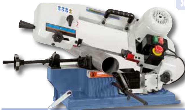
A fűrészkegely felfekvési nyomása hármass beállítású
