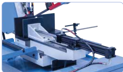
Robusztus satu szűrkeöntvényből hidraulikus szorítással
