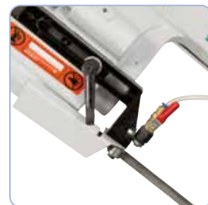
Golyóscsapágyazott fűrészszalag-vezető, a mindenkori munka-darab-szélességhez beállítható
