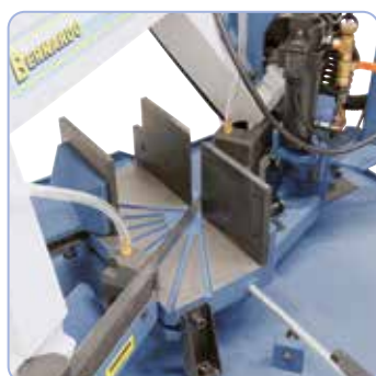
A fűrészkenyel sarkalóvágásokhoz 90°-tól 60°-ig beállítható
