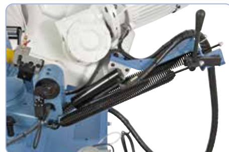
Húzórugó beállítókarrel kézi üzemeltetésre való átváltáshoz
