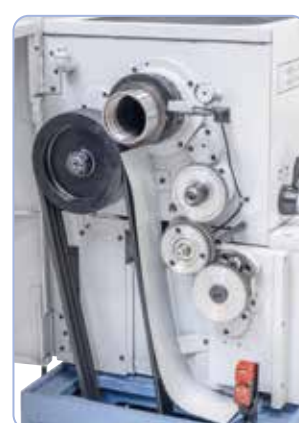
Edzett főorsó precíziós kúpos csapággal a körmozgás nagy pontosságáért, optimális erőátvitel a fogazott Optibelt-ékszíj által.
