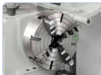
Síktárcsa 320 mm (opció) ideális aszimmetrikus munkadarabok befogásához
