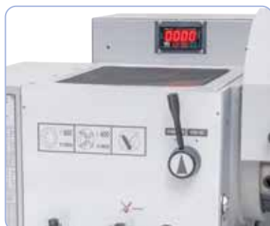
Elektronikus, fokozatmentes fordulatszám-szabályozás, könnyű leolvasás digitális mutató segítségével.
