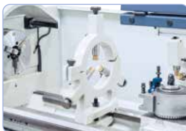
Rögzített lünetta a hosszú munkadarabok stabilizálására
