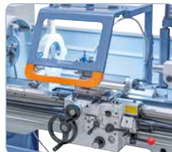
A szán hosszanti- és keresztmozgásához, ill. a felsőszupportnak 17 szabadon választható előretolás áll rendelkezésre
