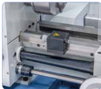
Mikrométer hosszanti-ütköző és csúszókuplung a szállítási terjedelemben
