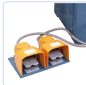
Alapfelszereltségben lámpedállal a befogópofák szorításához, ill. nyereg szeghüvellyel mozgathatóhoz.
