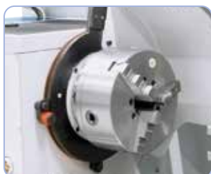
A Bernardo-pofás tokmány előnye P03-200 mm / D5: Monoblokk-, alap-, fordító- és feltépfák szállíthatók
