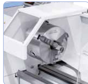
3-pofás tokmány 125 mm, eszterga- és fúrópofákkal a szállítási terjedelemben
