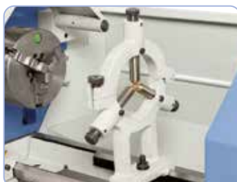
Rögzített lünetta bronz-vezetővel hosszú munkadarabok stabilizálására
