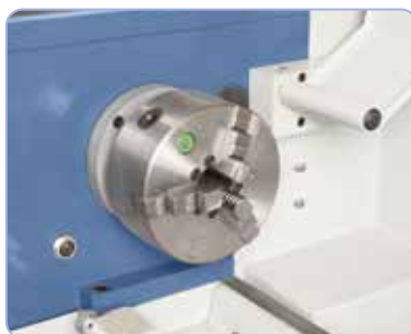
A Bernardo-pofás tokmány előnye DK11-160 mm: szállítható monoblokk-, alap-, fordító- és feltépfókák
