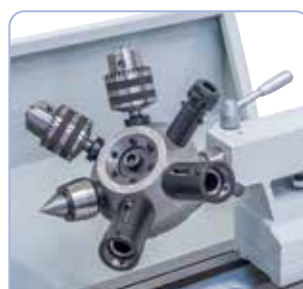
Hatékony munkavégzéshez a gépet fel lehet szerelni revolverfejjel
