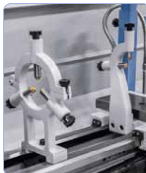
Hosszú munkadarabok stabilizálására sorozatszerűen egy rögzített, ill. együttfutó lünettával felszerelt
