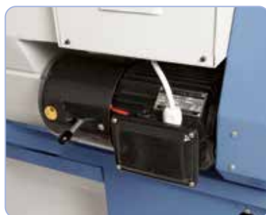
Erős teljesítményű hajtómotor mágneses fékkel CE-norma szerint
