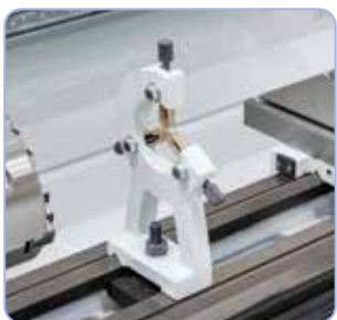
Rögzített lünetta bronz-vezetővel a hosszú munkadarabok stabilizálásához
