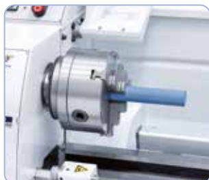
Nagy tengelyátmérők megmunkálására sorozatszerűen 38 mm-es orsófurattal felszerelve
