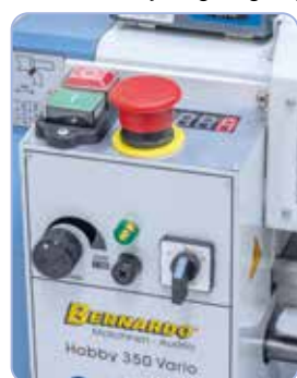
Elektronikus, fokozatmentes fordulatszám-szabályzás, könnyű leolvasás digitális mutató által
