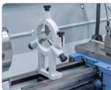
Rögzített lünetta bronz-vezetővel hosszú munkadarabok stabilizálására
