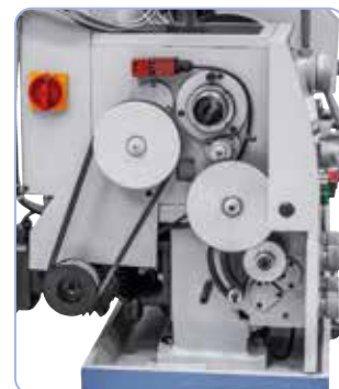
Szállítási terjedelemben komplett váltókerekkel menetvágáshoz
