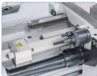
Mikrométer hosszanti- és revolverütőkötő a szállítási terjedelem tartalmazza.
