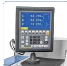
A gép sorozatszerűen egy digitális helyzetmutatóval (Bernardo ES-12 V) van felszerelve
