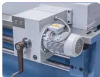
Motorosan állítható szegnyereg (3000 mm csúcshossztól)
