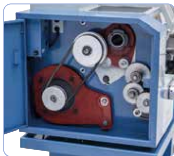
Sorozatszerűen váltókerékkel menetvágáshoz felszerelt
