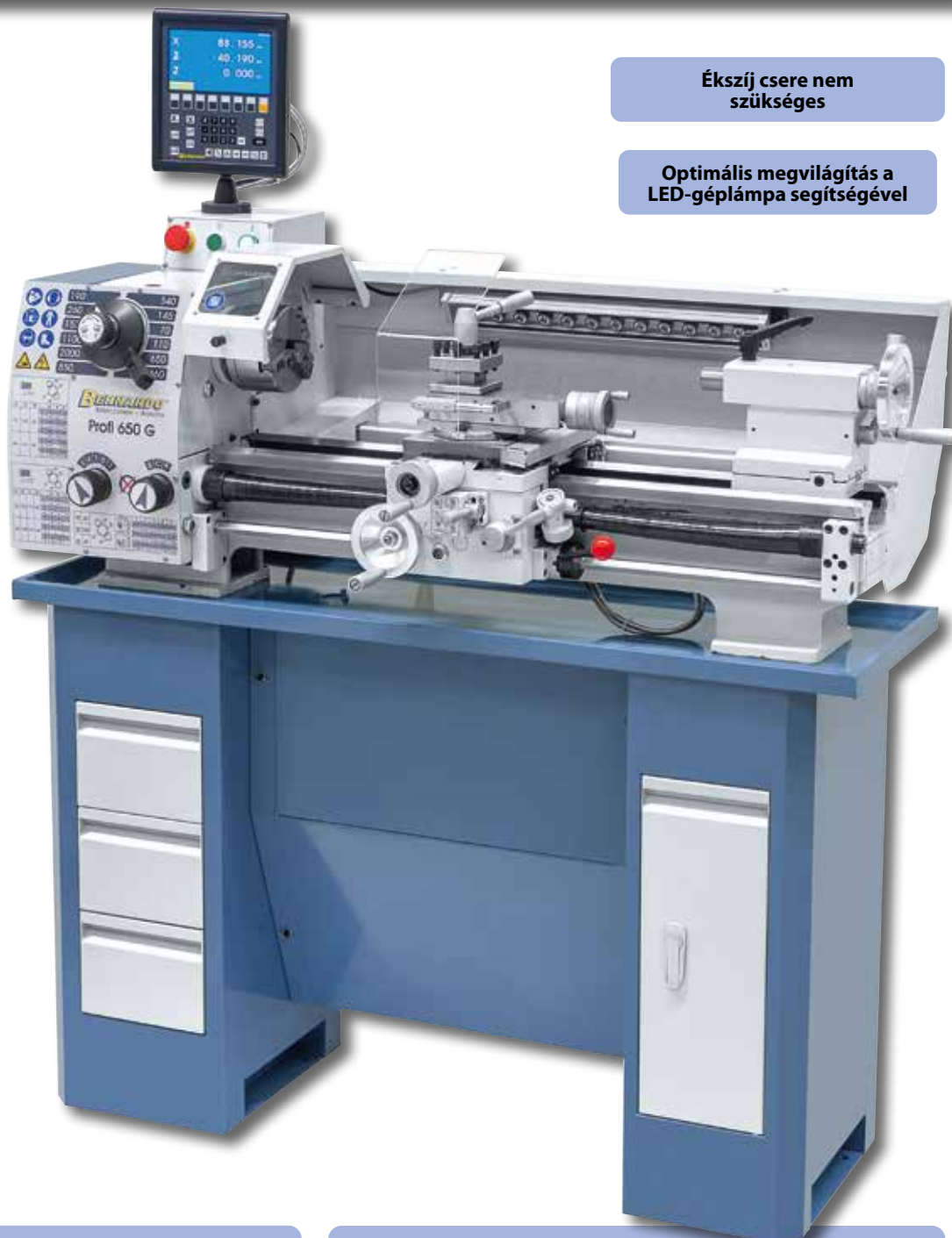
A nyeregszeg egykaros-szorítással kúpesztergáláshoz beállítható, kérés esetén központozókúppal szállítható
