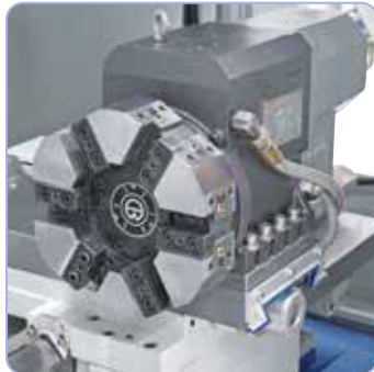
Robusztus szerszámrevolver 6 állomással.
