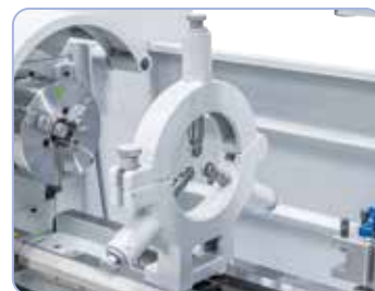
Rögzített lünetta hosszú és vékony munkadarabok megtámasztására
