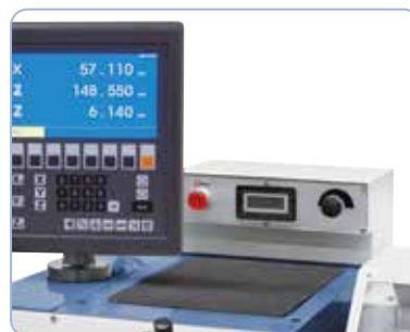
Elektronikus, fokozatmentes fordulatszám-szabályzás, könnyű leolvasás digitális mutató segítségével.
