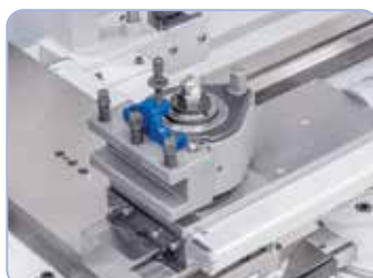
A hatékony munka érdekében a gép egy gyorsváltó-szerszámtartóval felszerelt.
