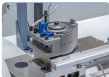
A gép felszerelhető egy gyorsváltó-szerszámtartóval a hatékony munka érdekében
