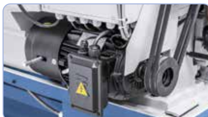
Nagy teljesítményű hajtómotor mágneses fékkel CE-norma szerint
