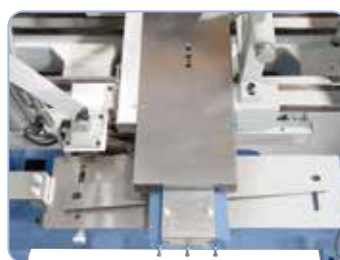
Kúpszterga-berendezés opcionálisan kapható, esztergahossz 455 mm, beállítási szög \pm 8^\circ
