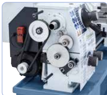
Sorozatszerűen váltókerékkel menetvágáshoz felszerelt
