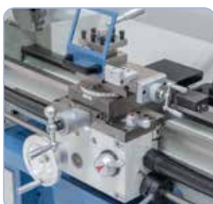
Könnyű menetű szán felső-szuporttal és négyes-szerszámtartóval, kézikerekek beállítható metrikus finom-skálabeosztással
