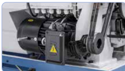
Nagy teljesítményű hajtómotor mágneses fékkel CE-norma szerint
