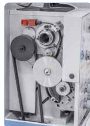
Sorozatszerűen váltókerékkel menetvágáshoz felszerelve
