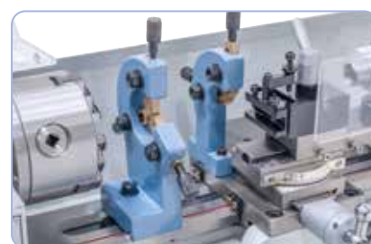
A lünetták megkönnyítik a hosszabb munkadarabok megmunkálását
