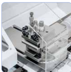
Könnyű menetű szán felső -szuporttal és négyes-szerszámtartóval, kézikerekek beállítható metrikus finom-skálabeosztással
