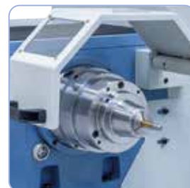
Opciósan szállítható: szorítófogó-tokmány 5C, befogási tartomány 3 - 26 mm
