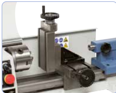
Opciósan szállítható: függőleges szupport 64 x 130 mm-es befogófelülettel
