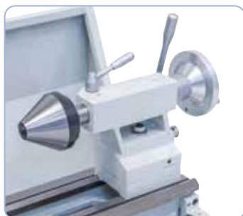
A nyereg szeg egykaros-szorítóval kúpesztergáláshoz beállítható, kérés esetén központozókúppal szállítható
