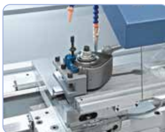
A gyorsváltó-szerszámtartó a mellékidők csökkentését teszi lehetővé és nagy ismétlődő pontosságot biztosít
