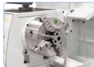
Centrikus szorítású 4-pofás tokmány 200 mm, optimális négyélű-munkadarabokhoz (opció)
