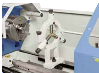
Rögzített lünetta bronz-vezetővel hosszú munkadarabok stabilizálására
