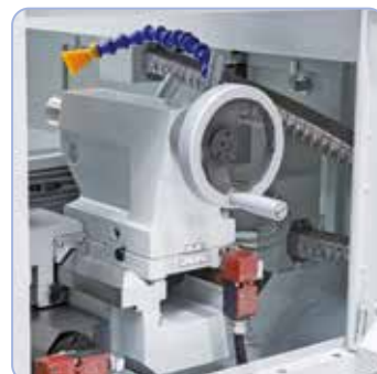
A robusztus nyeregszeg MK 4 szegnyereg felvételével kúpesztergáláshoz beállítható
