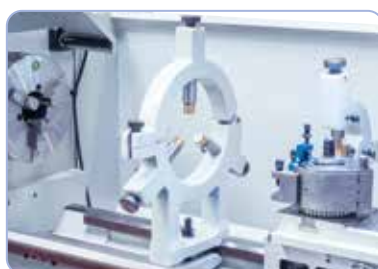
Rögzített lünetta a hosszú munkadarabok stabilizálására
