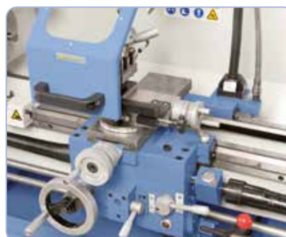
Könnyű menetű és precíz szán felsőszupporral és négyes-szerszámtartóval, kézikerek beállítható metrikus finom-skálabeosztással
