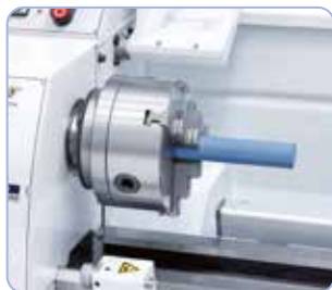
Nagy tengelyátmérők megmunkálásához sorozatszerűen 38 mm-es orsófurattal felszerelt (700 Top)
