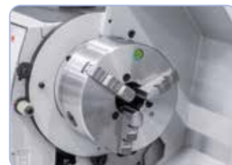
A Bernardo-pofás tokmány előnye DK11-200 mm / D5: Monoblokk-, alap-, fordító- és feltépfóákkal szállítható
