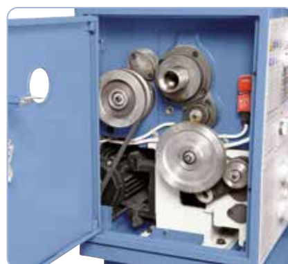
Szállítási terjedelem komplett váltókerekekkel menetvágáshoz
