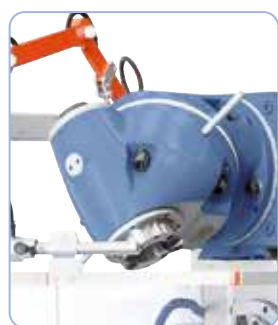
Az univerzális marófej a legkülönbözőbb szöghelyzetbe beállítható
