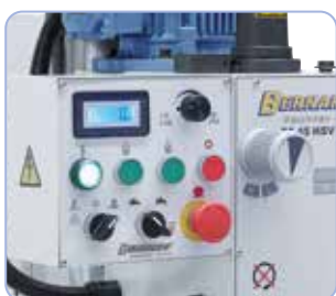
A fordulatszám-fokozat egyszerű kiválasztása hajtómű-választókapcsolóval, a kívánt fordulatszám beállítása potméterrel történik
