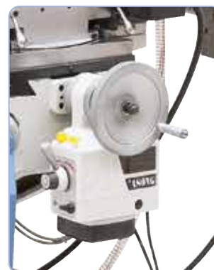
Sorozatszerűen fokozatmentes előretolással az y-tengelyen
