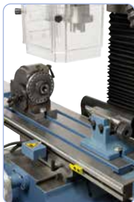
Fél-univerzális-osztófej BS-0: optimális tengelyek megmunkálására
