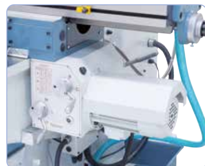
Sorozatszerűen 9-fokozatú előretolással az x- és y-tengelyen.
