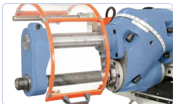
Vízszintes helyzetben történő maráshoz sorozatszerűen ellencsapággal és hosszú marótüskével
