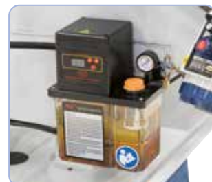
Elektromos központi kenés a szállítási terjedelemben
