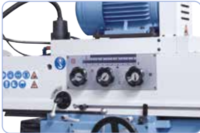
A felső karon egyszerűen beállítható orsó-fordulatszám.
