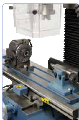
Fél-univerzális-osztófej BS-0: optimális tengely- megmunkáláshoz
