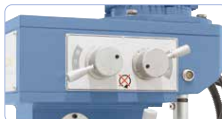
A kapcsolók egyszerű kezelése a fordulatszám változtatásához
