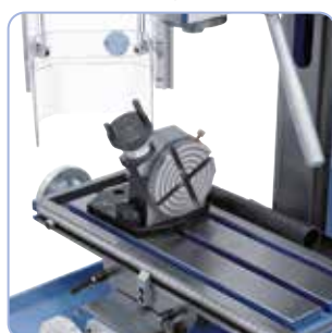
Opcionálisan szállítható kerekasztal további alkalmazási lehetőségek bővítéséhez
