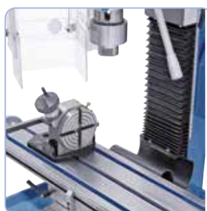
Opciósan szállítható kerekasztal további alkalmazási lehetőségek bővítéséhez
