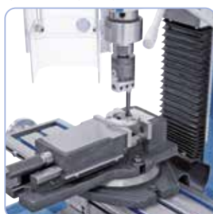
Igény szerint a gép kiesztergálófejjel is felszerelhető
