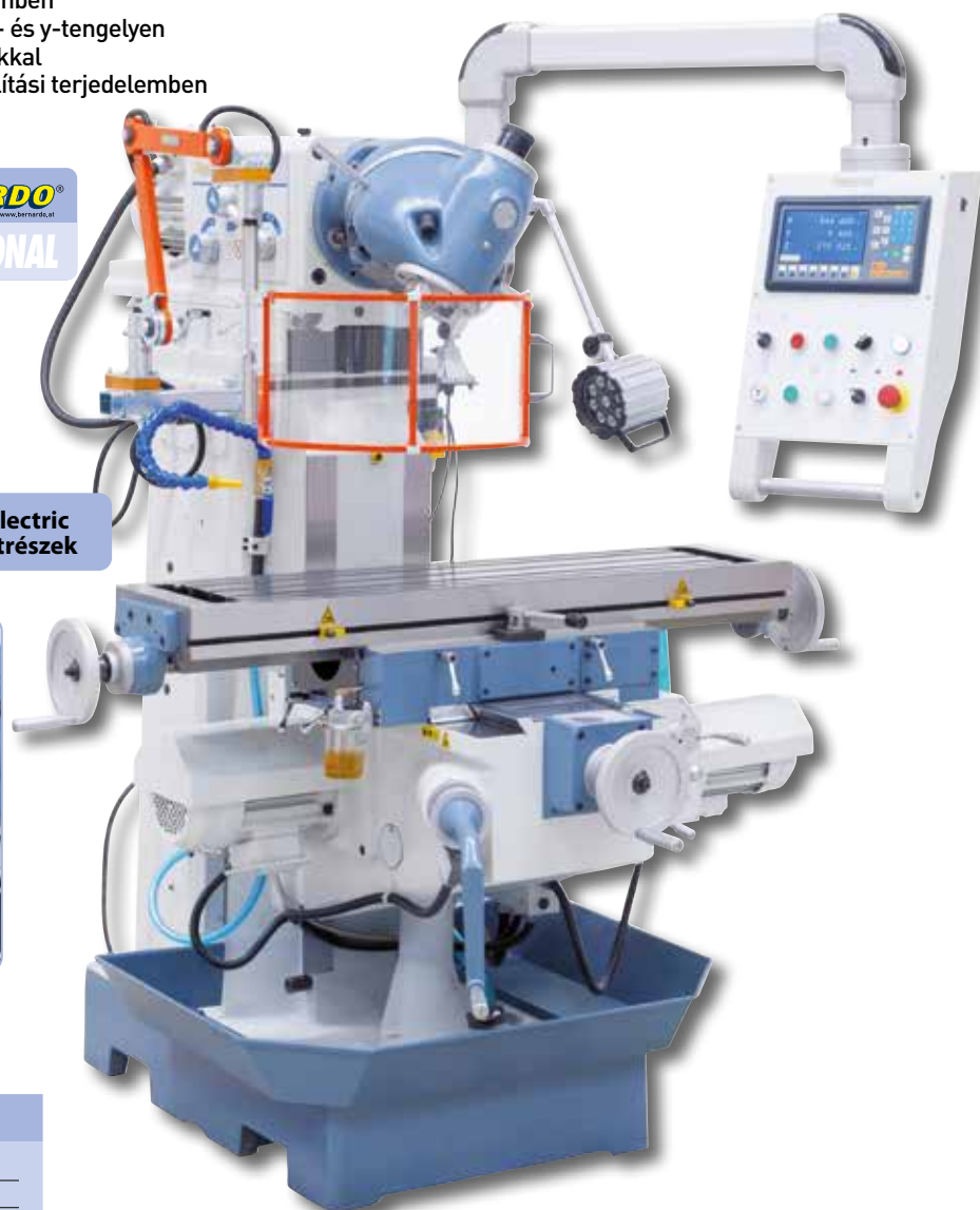
Vízszintes helyzetben történő maráshoz sorozatszerűen ellencsapággal és hosszú marótüskével
