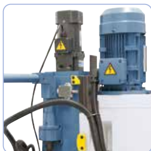
Marófej beállítás egyszerűen a szériászerű emelőmotor által történik
