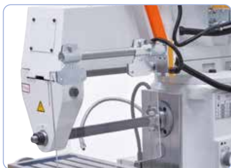
Sorozatszerűen ellencsapággal és hosszú marótüskével a vízszintes marómunkákhoz
