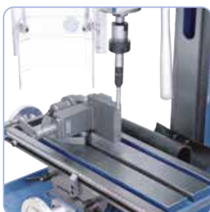
Szállítható kültartozék: Eltapító fénykijelzővel MK 2
