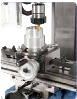
Opcionálisan szállítható kerekasztal további alkalmazási lehetőségek bővítéséhez
