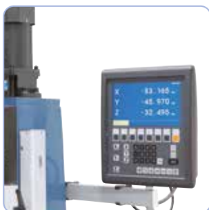
Sokrétű funkciókkal - mint pl.: lyukkör megmunkálás, zsebmarás-funkció... - rendelkező digitális kijelző ES-12 V
