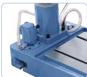
Erős teljesítményű hűtőanyag-pumpa a szállítási terjedelemben
