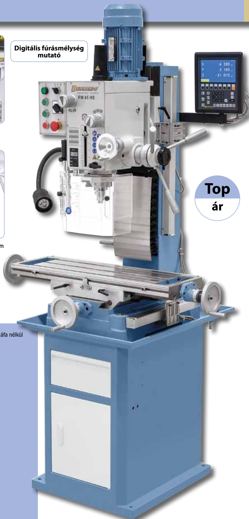
Áttekinthetően elhelyezett kapcsolók és kezelőelemek (menetfűrés, Start-Stop,...)
