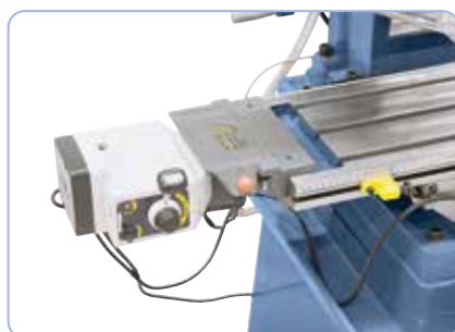
Az orsóhüvely-előretolás választható módon 0,10 / 0,18 vagy 0,26 mm/fordulatra beállítható
