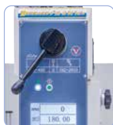
Az előtételhajtás révén egyszerű a hajtóműfokozat megválasztása, a kívánt fordulatszám a kijelzőn beállítható.
