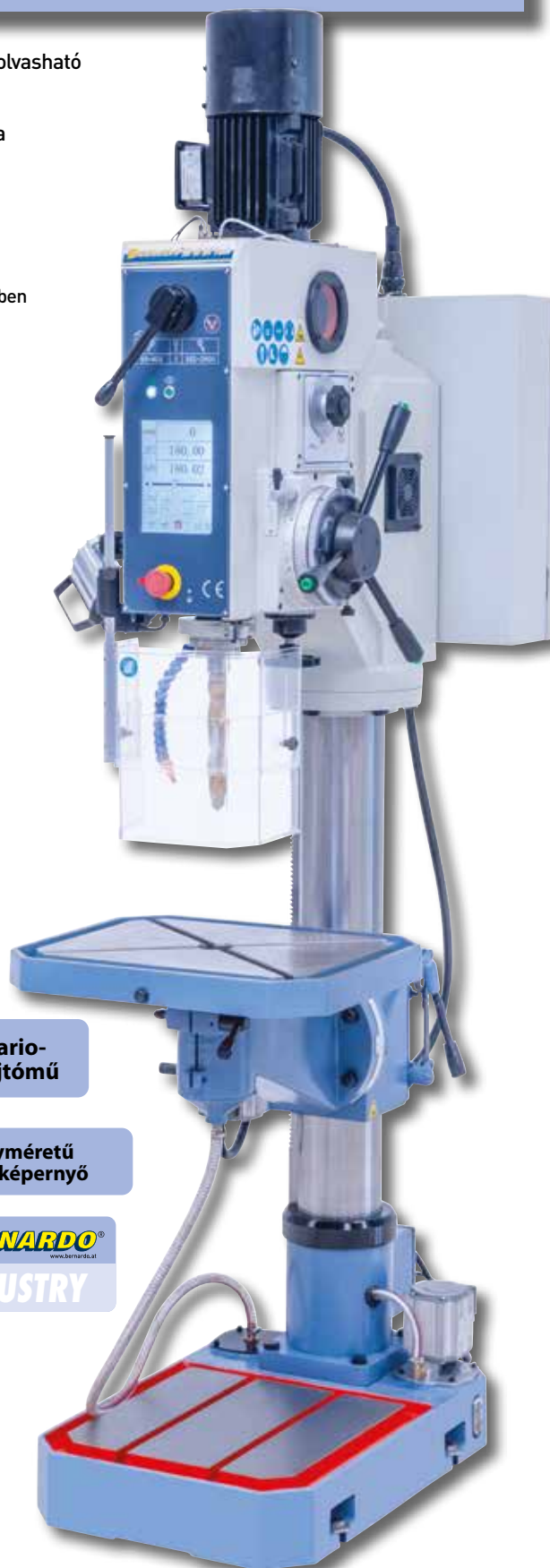
Az előtételhajtás révén egyszerű a hajtóműfokozat megválasztása, a kívánt fordulatszám a kijelzőn beállítható.
