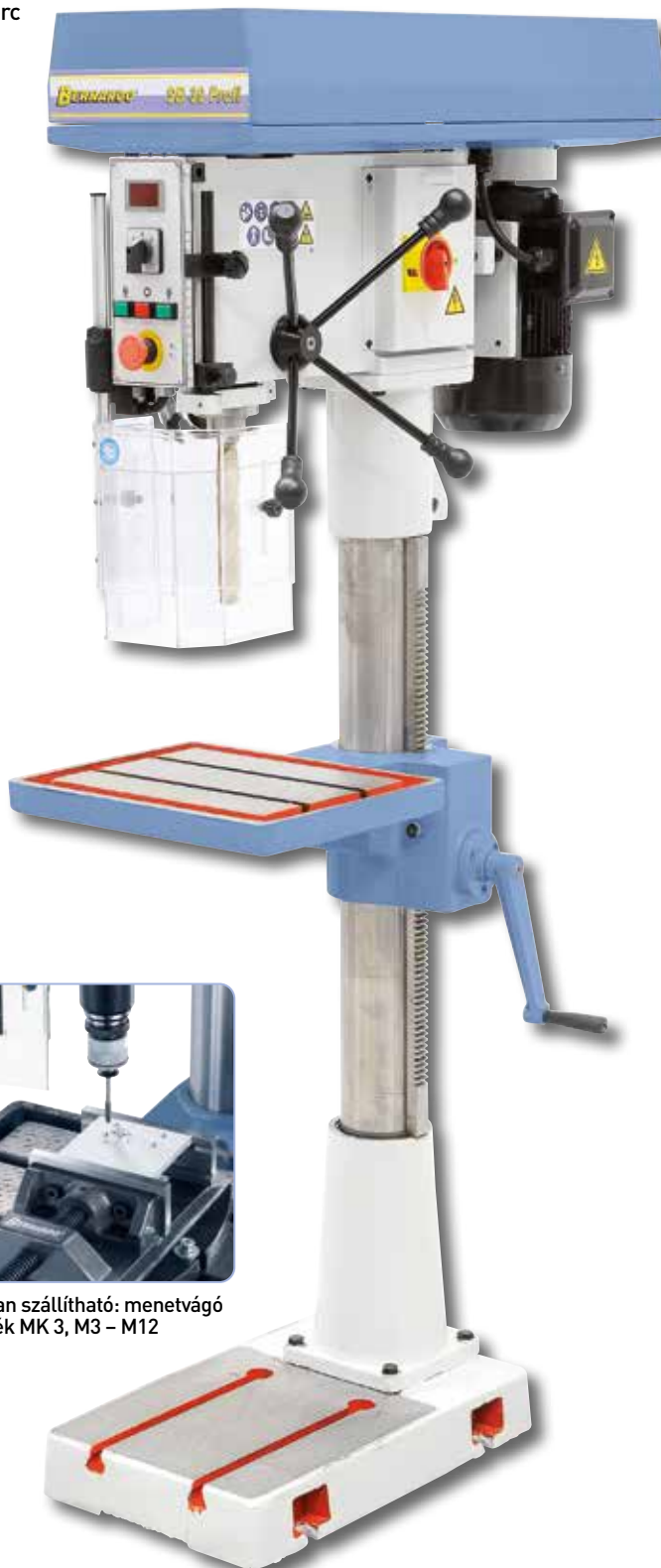
Sorozatszerűen digitális fordulatszám mutatóval felszerelve. Ergonomikusan kialakított kapcsolási és kezelői elemek a gép elején
