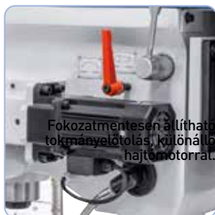
Fokozatmentesen állítható tokmányelőtolás, különálló hajtómotorral.
