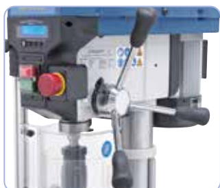
Könnyű menetű fűrásmélység állítás az ergonomikusan hozzárendelt kézfogantyúk által
