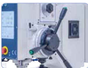
A precíz munka érdekében a gép sorozatszerűen automatikus orsó előretolóval, valamint digitális fúrásmélység mutatóval felszerelt
