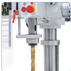
Erősre szabott orsóhüvely kúpögörs-csapággal a körmozgás nagy pontosságáért
