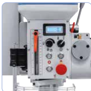
Sorozatszerűen digitális fordulatszám mutatóval felszerelve. Ergonomikusan kialakított kapcsolási és kezelő elemek a gép elején (DMT 25 PFV).
