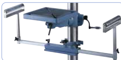
Hosszú munkadarabok felhelyezéséhez a gép felszerelhető egy kihúzható fúrószupporttal
