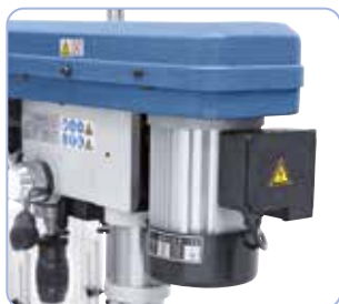
Nagy teljesítményű és nyugodt menetű alumínium-motor
