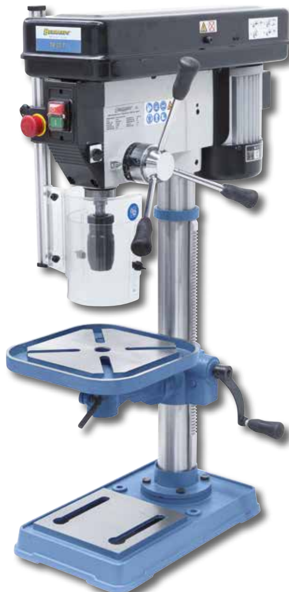
Szériászerűen gyorszorító-fúrótokmánnal 1 - 16 mm/ B 16 felszerelve
