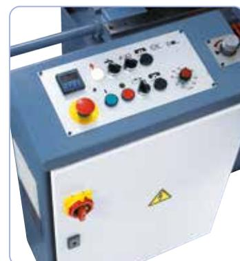
Disposition ergonomique des éléments de commande.
