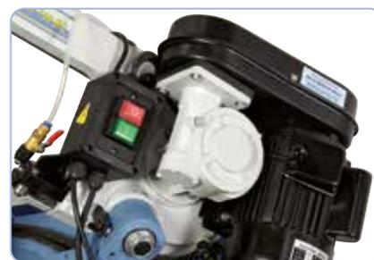
Changement de vitesse de coupe (23 / 33 / 52 m/min) par courroie trapézoïdale
