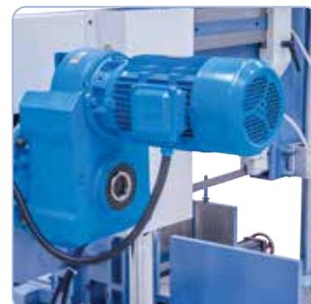
Puissant moteur d'entraînement avec réducteur à denture oblique, puissance d'entraînement de 3,0 kW à 7,5 kW
