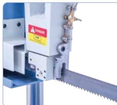
Guidage du ruban par un système de guidage mors-rouleau combiné avec inserts en métal dur
