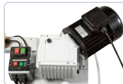
Boîte de vitesses avec arbre à vis sans fin trempé et rectifié, et roue en bronze
