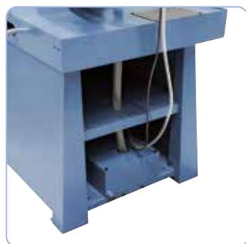
Dispositif d'arrosage puissant intégré dans le socle.
