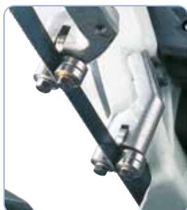
Guide-lame à roulement à billes avec réglage rapide selon la largeur des pièces, garantit un résultat optimal
