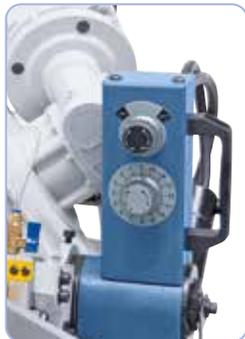
Descente de l'archet réglable en continu par une vanne de commande
