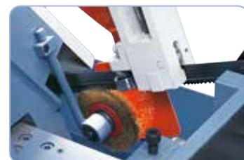
Guide-lame à roulements et brosse à copeaux pour une découpe optimale
