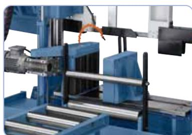
Avance par rouleaux motorisés pour un défilement optimal du matériau
