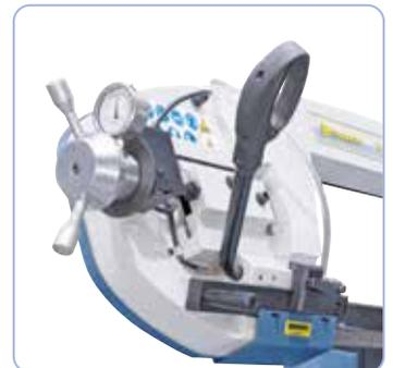
Poignée ergonomique, réglage de la tension du ruban au moyen d'une manivelle.
