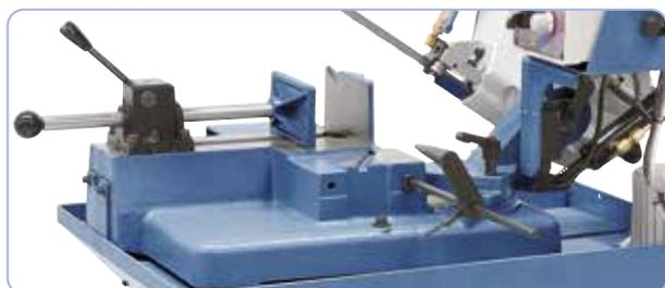
Réglage simple de l'étau par levier de serrage rapide.
