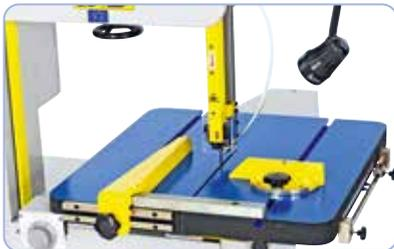
De série avec guide longitudinal pour les coupes droites et guide d'onglet pour les coupes en biais
