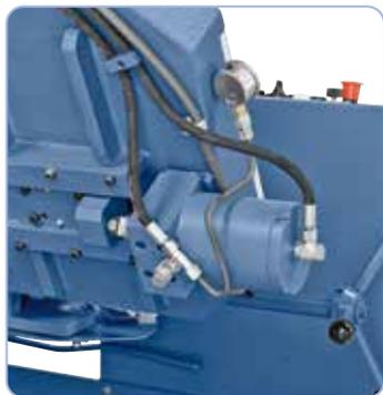
En option avec régulateur hydraulique de tension du ruban
