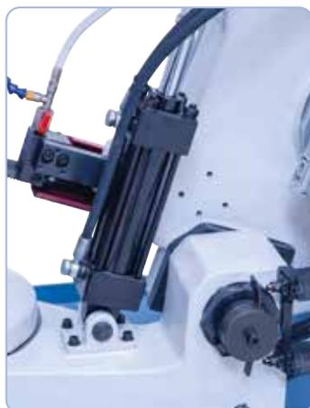
De série avec vérin hydraulique pour descente progressive de l'archet et coupure automatique en fin de course
