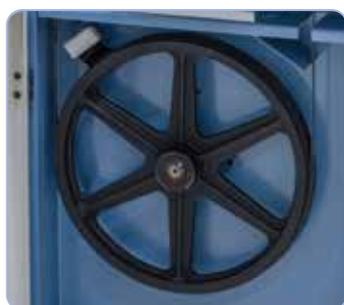
Le volant est doté d'un bandage en caoutchouc special assurant un fonctionnement silencieux et augmentant la durée de vie de la lame.
