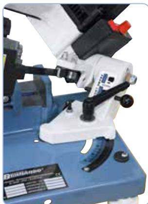
Archet verrouillable pour une manipulation plus facile dans les applications mobiles
