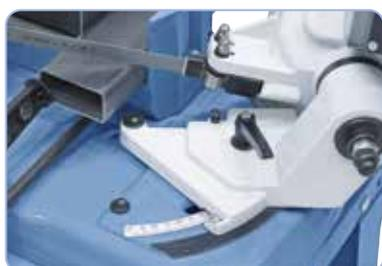
Archet verrouillable pour une manipulation plus facile dans les applications mobiles
