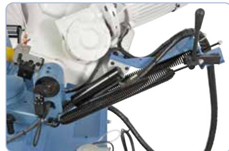
Ressort à levier de réglage pour le passage en mode manuel
