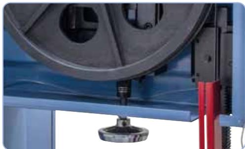
Réglage de tension du ruban par manivelle
