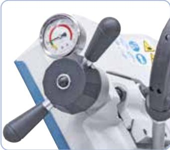
Réglage optimal de la tension de lame par manomètre
