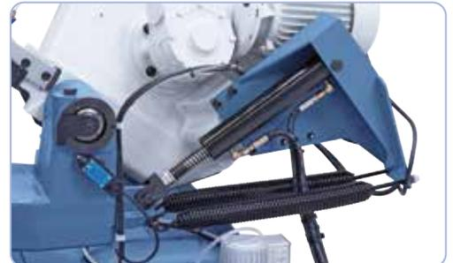
De série avec vérin hydraulique pour une descente souple de l'archet
