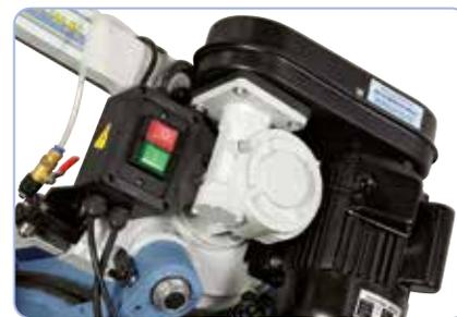
Changement de vitesse de coupe (24 / 41 / 61 / 82 m/min) par courroie trapézoïdale
