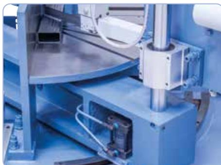
Réglage automatique de l'angle de coupe avec serrage hydraulique.
