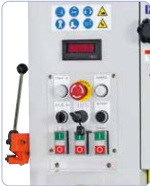
Complet avec affichage LED pour permettre un réglage facile de la vitesse.
