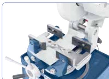
Étau à serrage concentrique avec réglage longitudinal des mors
