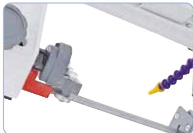
Guide-lame à roulements à billes pour un résultat précis
