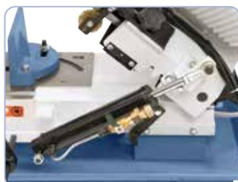
De série avec vérin hydraulique pour une descente souple de l'archet
