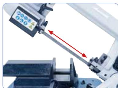
Guide-lame adaptable à la largeur du matériau
