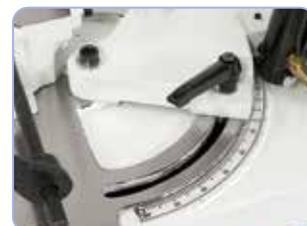
De série avec coupure automatique en fin de course, interrupteur marche/arrêt IP 54
