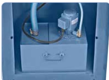
Dispositif d'arrosage puissant intégré dans le socle
