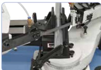
Archet inclinable pour les coupes en onglet de  $-45^\circ$  à  $45^\circ$
