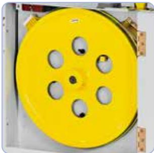
Le volant est doté d'un bandage en caoutchouc special assurant un fonctionnement silencieux et augmentant la durée de vie de la lame.
