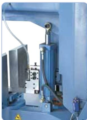
Descente de l'archet à vitesse constante assurée par le robuste vérin hydraulique
