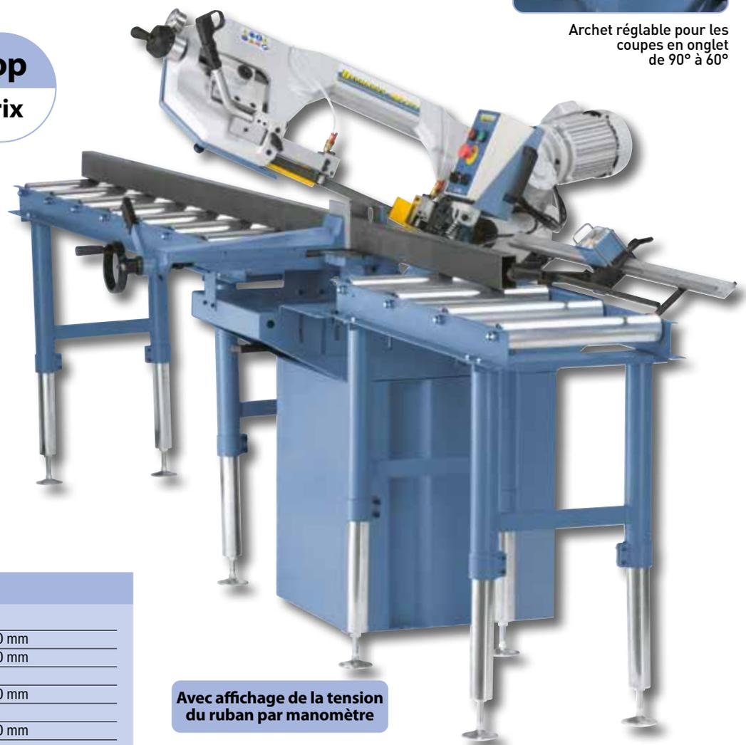
**Avec affichage de la tension du ruban par manomètre**
