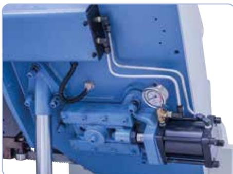
Équipé en série avec une tension de ruban hydraulique (NC Pro)
