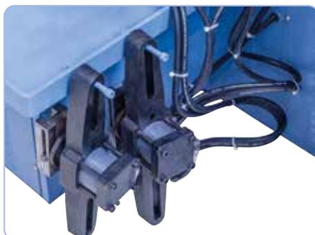
Dispositif de serrage de faisceau hydraulique pour les deux étaux fournis.
