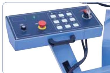
Console de commande ergonomique à l'avant de la machine pour un travail confortable
