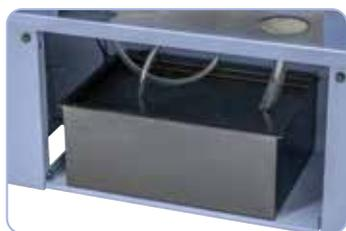
Dispositif d'arrosage puissant intégré dans le socle.
