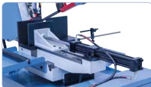
Robuste étau en fonte grise à serrage hydraulique
