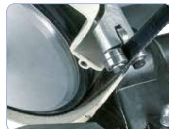
Volant d'inertie en aluminium de qualité à bandage caoutchouc pour un fonctionnement silencieux.
