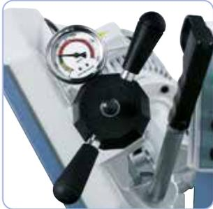
Contrôle de la tension du ruban par manomètre.
