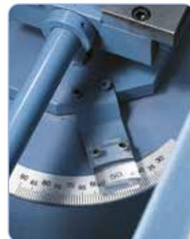
Réglage simple et rapide de l'angle de coupe sur la graduation
