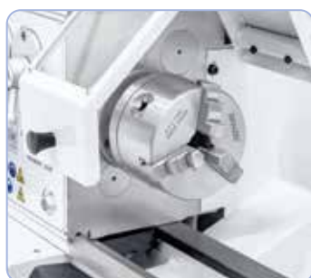
Mandrin 3 mors 100 mm inclus avec mors de perçage et tournage
