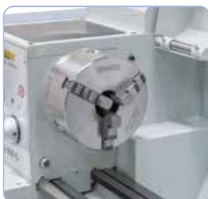
Mandrin 3 mors 160 mm inclus avec mors de perçage et tournage
