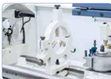
Lunette fixe pour stabiliser les pièces longues
