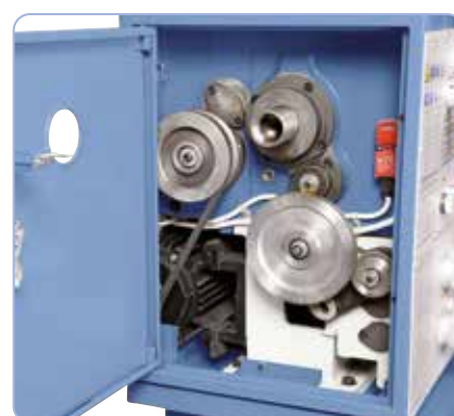
Pignons interchangeables pour taraudage inclus de série
