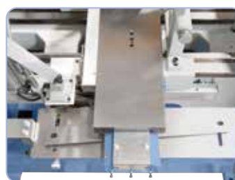
Dispositif pour tournage conique en option, longueur de tournage 455 mm, angle réglable \pm 8^\circ
