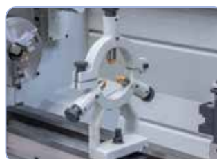
Lunette fixe avec guidage en bronze pour stabiliser les pièces longues
