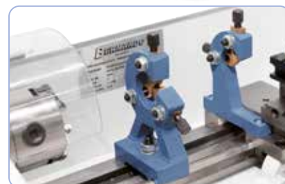
Les lunettes facilitent l'usinage des pièces longues
