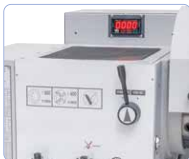
Variateur électronique de vitesse avec affichage digital très lisible
