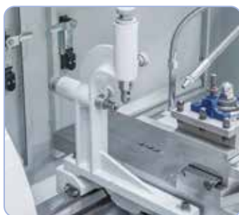
Lunette mobile pour empêcher le flambage des arbres de petit diamètre
