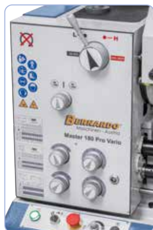
Disposition ergonomique des éléments de commande sur la tête, pignons trempés et rectifiés pour un fonctionnement silencieux
