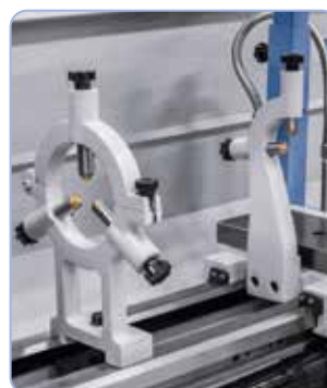
De série avec lunette fixe ou mobile pour stabiliser les pièces longues
