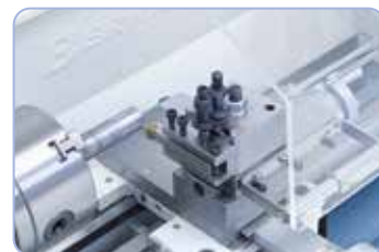
Pour réduire les temps morts, la machine peut être équipée d'une tourelle à changement rapide Bernardo taille 10
