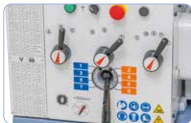
Vitesse d'avance facile à changer, pignons rectifiés pour un fonctionnement silencieux
