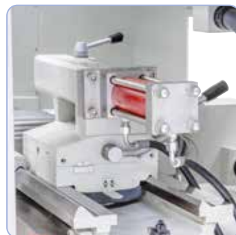
Réglage hydraulique de série du fourreau à contre-pointe.
