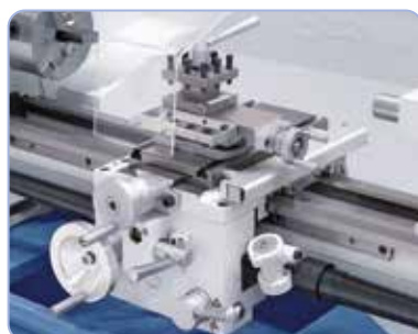
Levier ergonomique pour le réglage d'avance longitudinale et transversale
