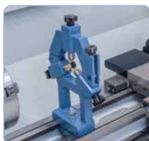
Lunette fixe avec guidage en bronze pour stabiliser les pièces longues
