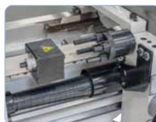
4 butées réglables et une butée longitudinale micrométrique, idéal pour les travaux de série
