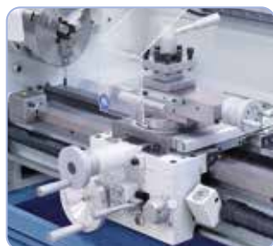
Levier ergonomique pour le réglage d'avance longitudinale et transversale
