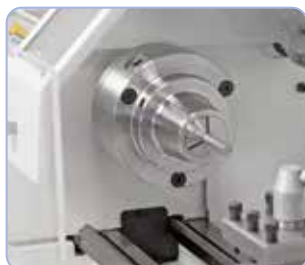
En option: mandrin porte-pince 5C, plage de serrage 3 - 26 mm
