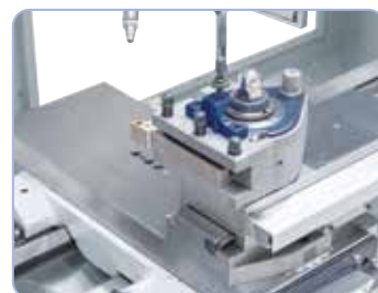
Machine équipée d'une tourelle à changement rapide pour un travail plus efficace
