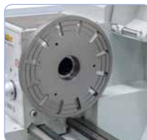
Pour le bridage de pièces aux formes spécifiques, la machine peut être équipée d'un flasque de montage de 250 mm
