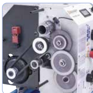
Broche trempée, grande précision de concentricité du nez de broche ( \leq 0,015 mm) grâce aux roulements de précision
