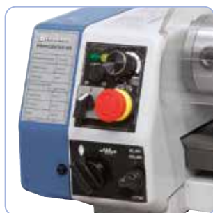
Éléments de commande (régulation de vitesse, sélecteurs, avance, etc.) regroupés sur la poupée fixe
