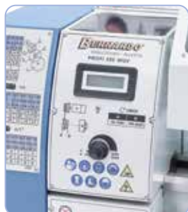
Variateur électronique de vitesse avec affichage digital très lisible
