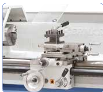
Chariot avec tourelle porte-outils, précis et facile à manœuvrer ; grande durée de vie grâce aux cales de rattrapage de jeu
