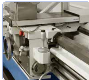
Avance rapide incluse pour la course longitudinale et transversale du chariot
