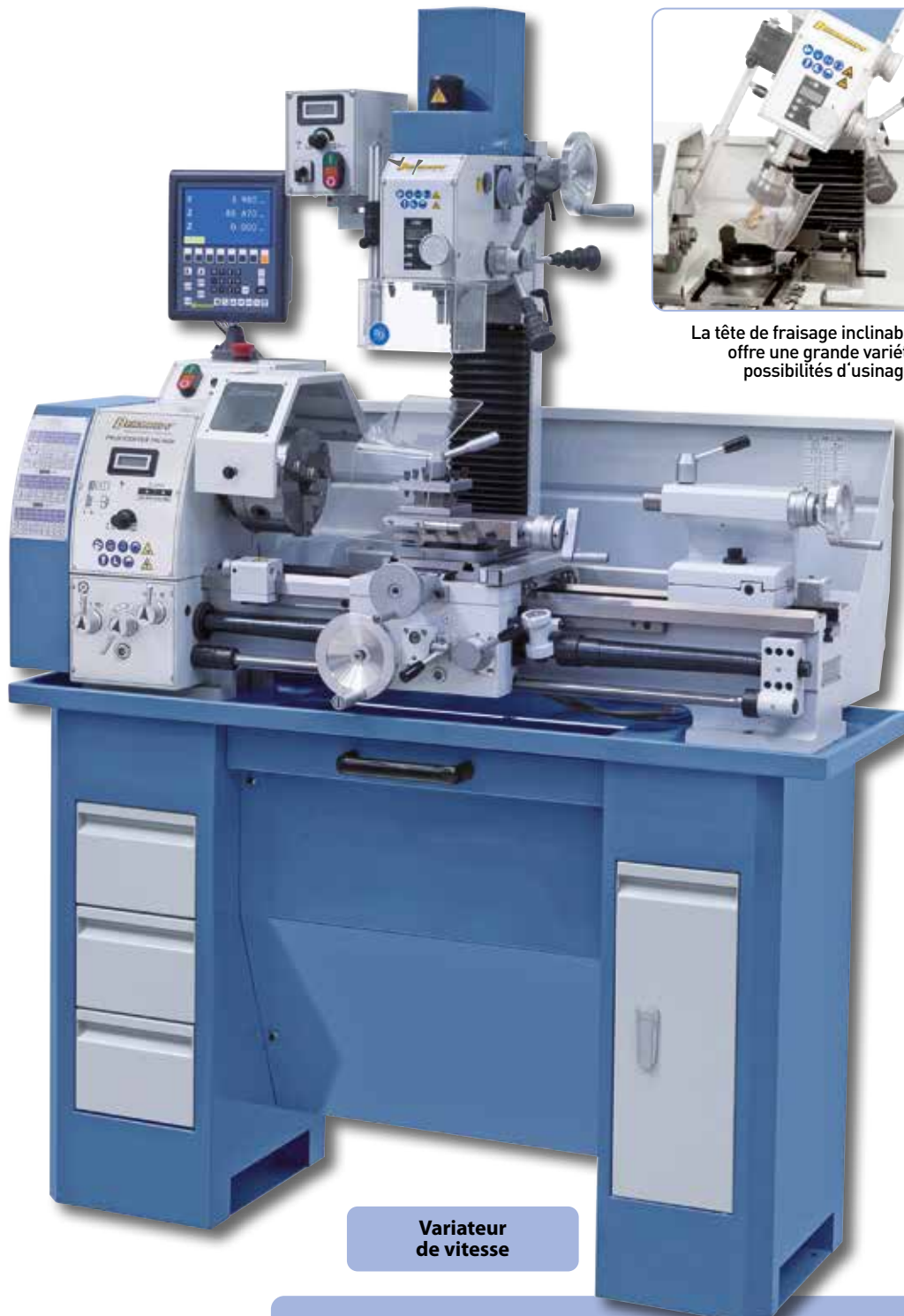
Chariot à manivelle avec graduation fine. Ce modèle est également équipé d'une avance transversale économique.
