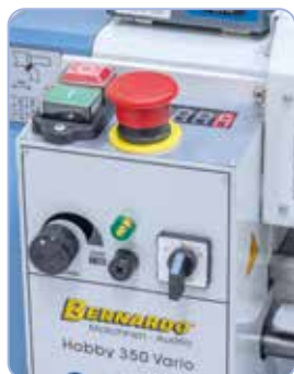
Variateur électronique de vitesse avec affichage digital très lisible
