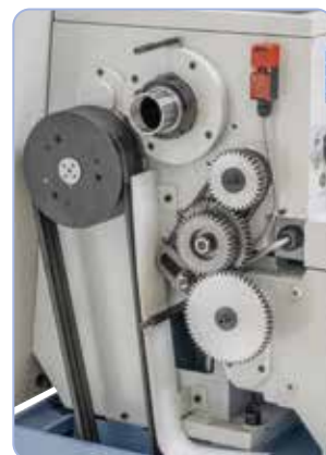
De série avec roues dentées pour filetage
