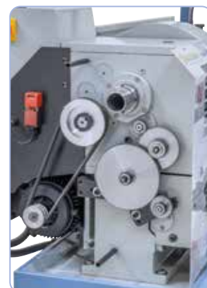
De série avec roues dentées pour filetage
