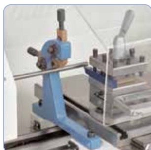
Lunette mobile pour empêcher le flambage des arbres de petit diamètre
