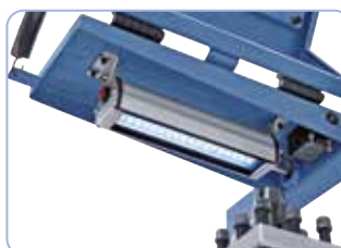
Lampe à LED intégrée dans le couvercle de protection pour un éclairage optimal durant le travail.
