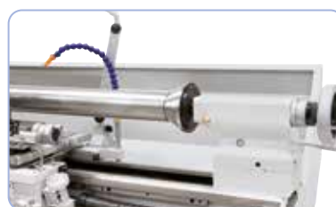
Cône de centrage diam. 125 mm, idéal pour le bridage des tubes et corps creux (en option)
