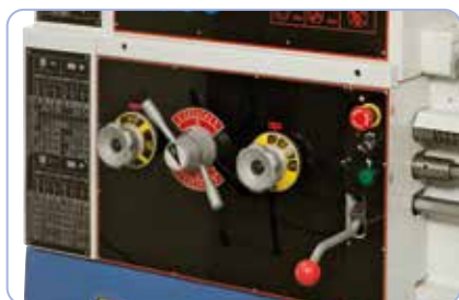
Vitesse d'avance facile à changer, pignons rectifiés pour un fonctionnement silencieux
