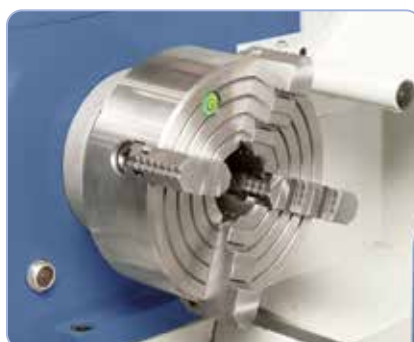
Mandrin indépendant 200 mm (standard) idéal pour le bridage des pièces asymétriques
