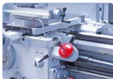
Avances rapides de série pour réduire les temps morts
