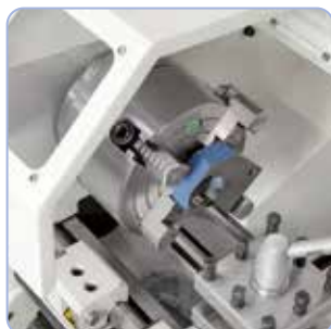
Mandrin indépendant 160 mm (en option) pour le bridage des pièces asymétriques
