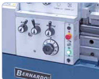
Vitesse d'avance facile à changer, pignons rectifiés pour un fonctionnement silencieux
