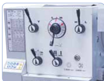
Utilisation simple, disposition ergonomique des éléments de commande sur la tête
