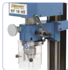
Descente de la broche par cabestan ou descente fine par volant d'avance
