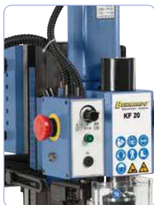
Régulation de vitesse par transmission intermédiaire et moteur à courant continu avec régulateur électronique
