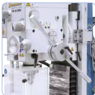
Descente de broche réglable au choix à 0,10 / 0,18 ou 0,26 mm/tr
