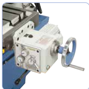
Réglage de la table sur l'axe x au moyen de 8 vitesses d'avance au choix (24 - 720 mm/min)
