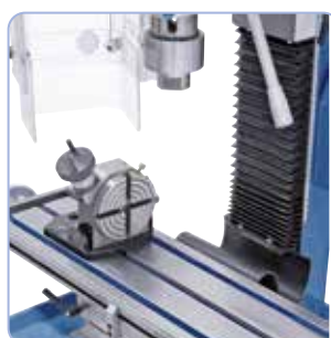
Plateau diviseur disponible en option pour une multitude d'autres utilisations possibles
