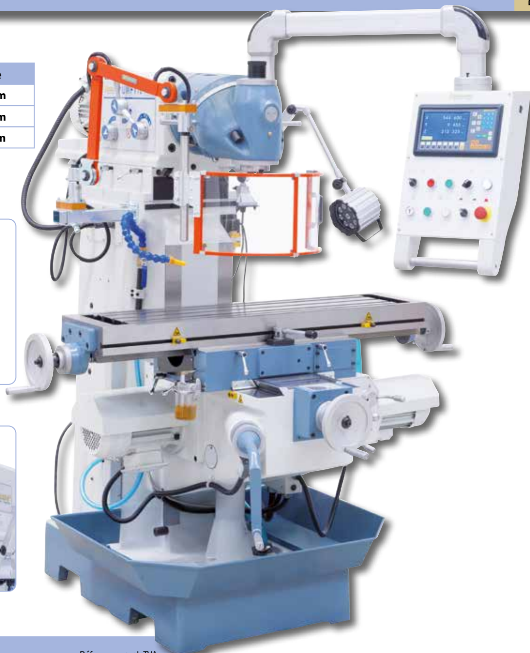
Visu dynamique 3 axes pour réduire les temps de réglage
