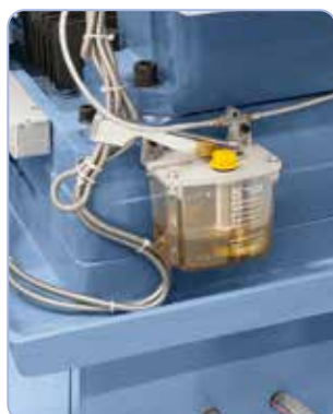
De série avec graissage centralisé des guidages
