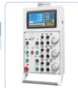
Pupitre de commande clair avec affichage digital intégré et manivelles électroniques
