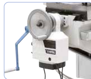
De série avec avance automatique de la table de fraisage sur l'axe y
