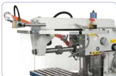
Fraisage horizontal avec contre-support
