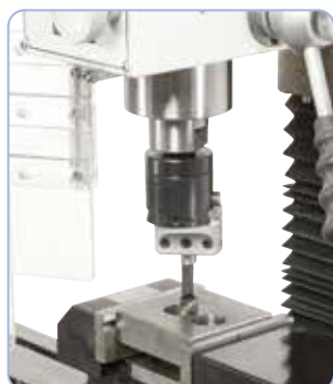
Sur demande, la machine peut être équipée d'une tête à aléser
