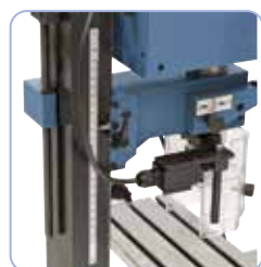
Règle graduée de précision sur l'axe Z
