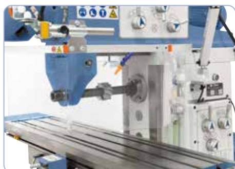
Broche horizontale pour une grande polyvalence, réglage de vitesse par embrayage
