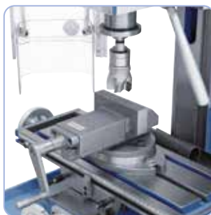
Fraisage avec fraiseuse d'angle et pour dresser (réf. 42-1057)
