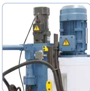
Réglage de hauteur de la tête de fraisage aisé par moteur de série
