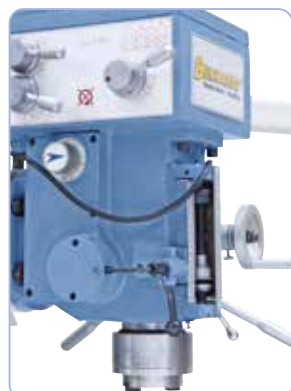
Machine équipée de série d'une descente de broche automatique (0,08 / 0,15 / 0,25 mm/tr)
