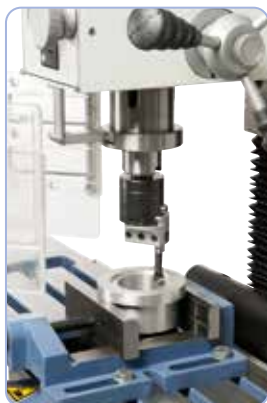
Sur demande, la machine peut être équipée d'une tête à aléser
