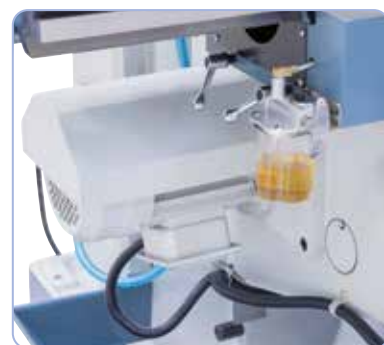
Avec moteur de positionnement pour la table sur l'axe z
