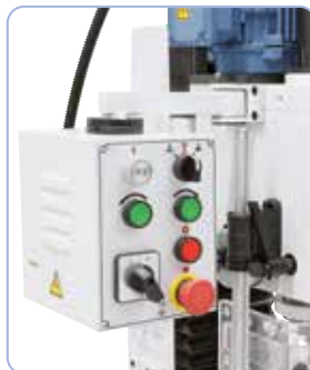
Disposition ergonomique des éléments de commande, de série avec dispositif de taraudage
