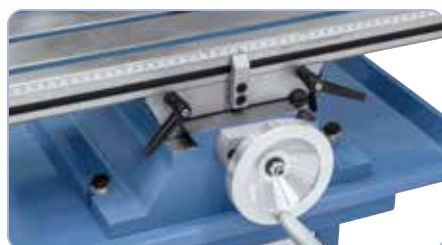
Guidage en queue d'aronde en x, y et z, ajustable par cale de réglage
