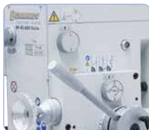
Descente de broche réglable au choix à 0,10 / 0,18 ou 0,26 mm/tr
