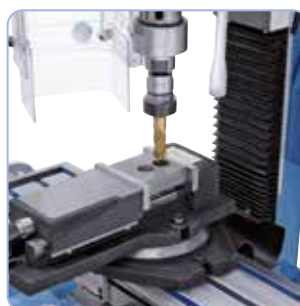
Fraisage avec étau large de la machine FJ 100
