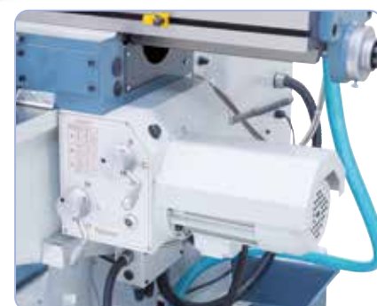
De série avec 9 vitesses d'avance des axes x et y
