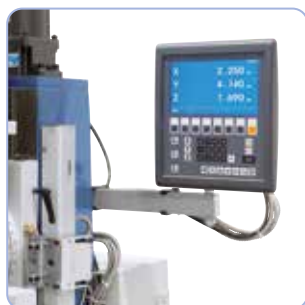
Affichage digital de position sur les 3 axes permettant jusqu'à 50 % de gain de productivité
