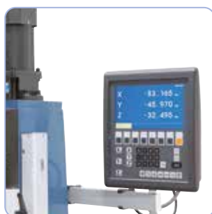
Le indicateur digital ES-12 V avec écran LCD avec de multiples fonctions comme par exemple les coordonnées circulaires, les fonctions de fraisage en poche, ...
