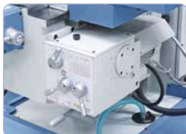
L'avance de table de série avec fonction d'avance rapide sur les 3 axes réduit nettement les temps morts
