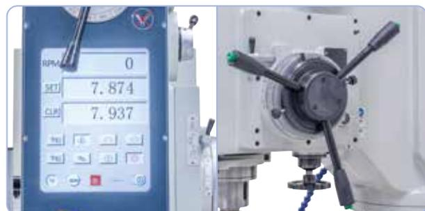
Pour un travail de précision, cette machine est équipée de série d'une avance automatique de broche et d'un affichage digital de profondeur de perçage
