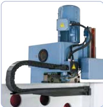
Contrepoids pour le fourreau de broche et la chaîne porte-câbles à l'arrière de la tête de perçage
