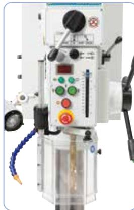
Présélection de l'étage de vitesse par transmission intermédiaire, réglage de la vitesse de rotation par potentiomètre
