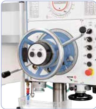
Commandes ergonomiques, le blocage de la tête de perçage s'effectue directement sur la manivelle
