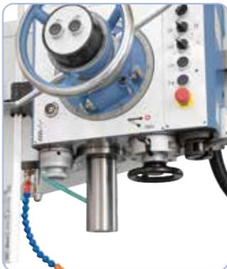
Réglage de la vitesse de rotation ou de l'avance sous la tête de perçage
