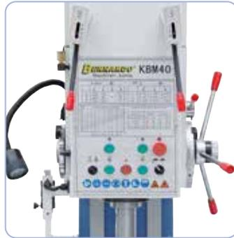
Éléments de commande ergonomiques sur la tête de perçage.
