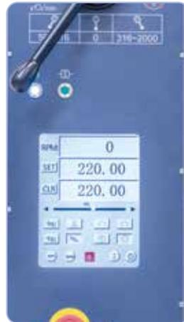
Écran tactile de grandes dimensions pour toutes les opérations de réglage, par exemple la vitesse, le perçage, rotation droite/gauche, le réglage de la hauteur de la table, .....
