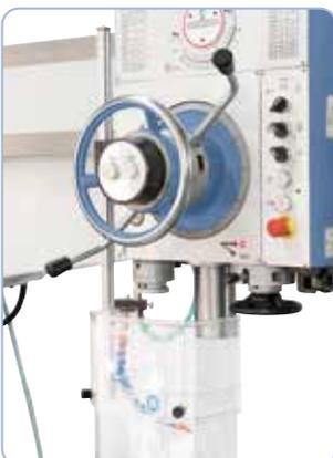
Broche à roulements de précision pour un travail de qualité, table cubique et dispositif d'arrosage de série
