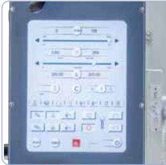
Écran tactile de grandes dimensions pour toutes les opérations de réglage, par exemple la vitesse, le perçage, rotation droite/gauche, le réglage de la hauteur de la table, .....
