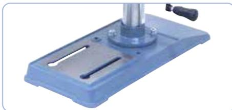
Socle usiné pour le bridage de pièces volumineuses
