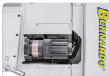
Livré en standard avec un servomoteur pour une alimentation automatique de la plume.
