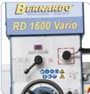
Réglage de la vitesse de rotation ou de l'avance à l'avant de la tête de perçage
