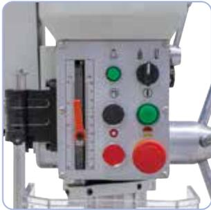
Disposition ergonomique des éléments de commande à l'avant
