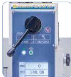
Sélection aisée du rapport d'engrenage grâce à la transmission intermédiaire, réglage de la vitesse de rotation désirée sur l'écran d'affichage.
