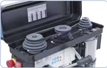
Poulies équilibrées en fonte grise pour un fonctionnement silencieux, et courroie de qualité pour une transmission optimale
