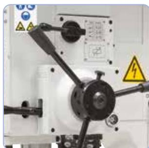
Descente de broche manuelle ou par avance mécanique (0,1 / 0,2 / 0,3 mm/tr)
