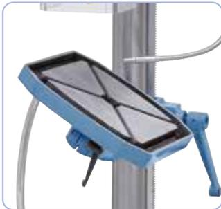
Table de perçage massive à rainures en T diagonales, orientable de  $-45^\circ$  à  $+45^\circ$
