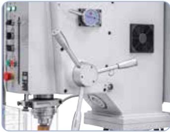
Pour un travail de précision, la machine est équipée de série d'une descente automatique de broche et d'un éclairage
