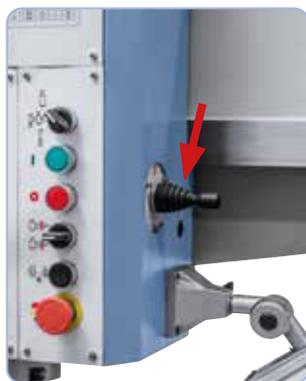
Inversion du sens de rotation et embrayage/débrayage de la broche par interrupteur pilote
