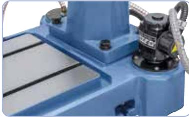
Socle usiné de précision, de série avec pompe d'arrosage intégrée
