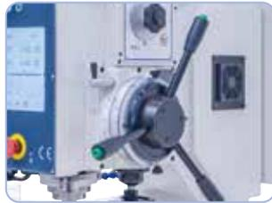
Pour un travail de précision, cette machine est équipée de série d'une avance automatique de broche et d'un affichage digital de profondeur de perçage
