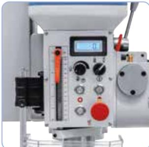
De série avec affichage digital de vitesse. Disposition ergonomique des éléments de commande à l'avant (DMT 25 PFV).
