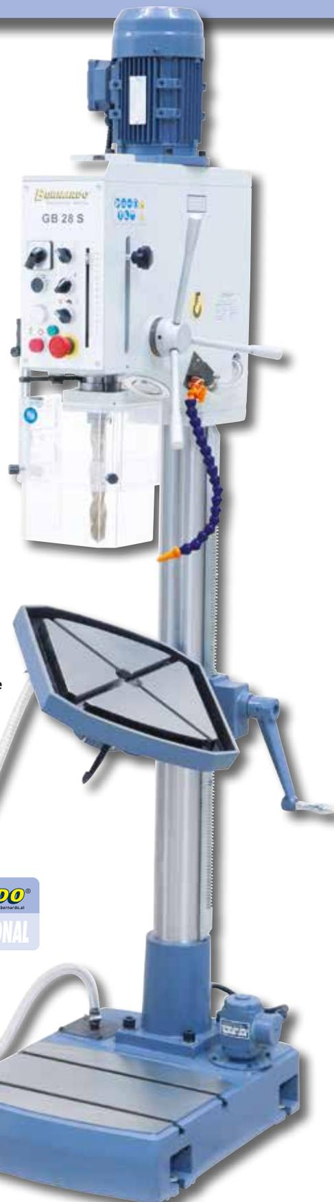
Table de perçage pivotante à 360°, idéale pour le perçage en coordonnées
