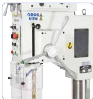
Pour un travail de précision, la machine est équipée de série d'une descente automatique de broche et d'un éclairage
