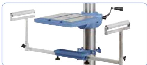
Pour les pièces longues, la machine peut être équipée d'un support de perçage télescopique.
