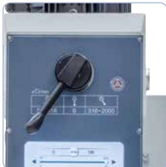
Sélection aisée du rapport d'engrenage grâce à la transmission intermédiaire, réglage de la vitesse de rotation désirée sur l'écran d'affichage.
