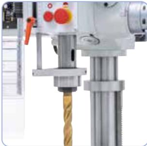
Fourreau de broche largement dimensionné, à roulements coniques pour une excellente concentricité
