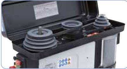
Poulies équilibrées en fonte grise pour un fonctionnement silencieux, et courroie de qualité pour une transmission optimale
