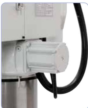
Moteur hydraulique de série pour le blocage du bras de potence et de la tête de perçage
