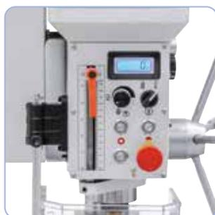
De série avec affichage digital de vitesse. Disposition ergonomique des éléments de commande à l'avant
