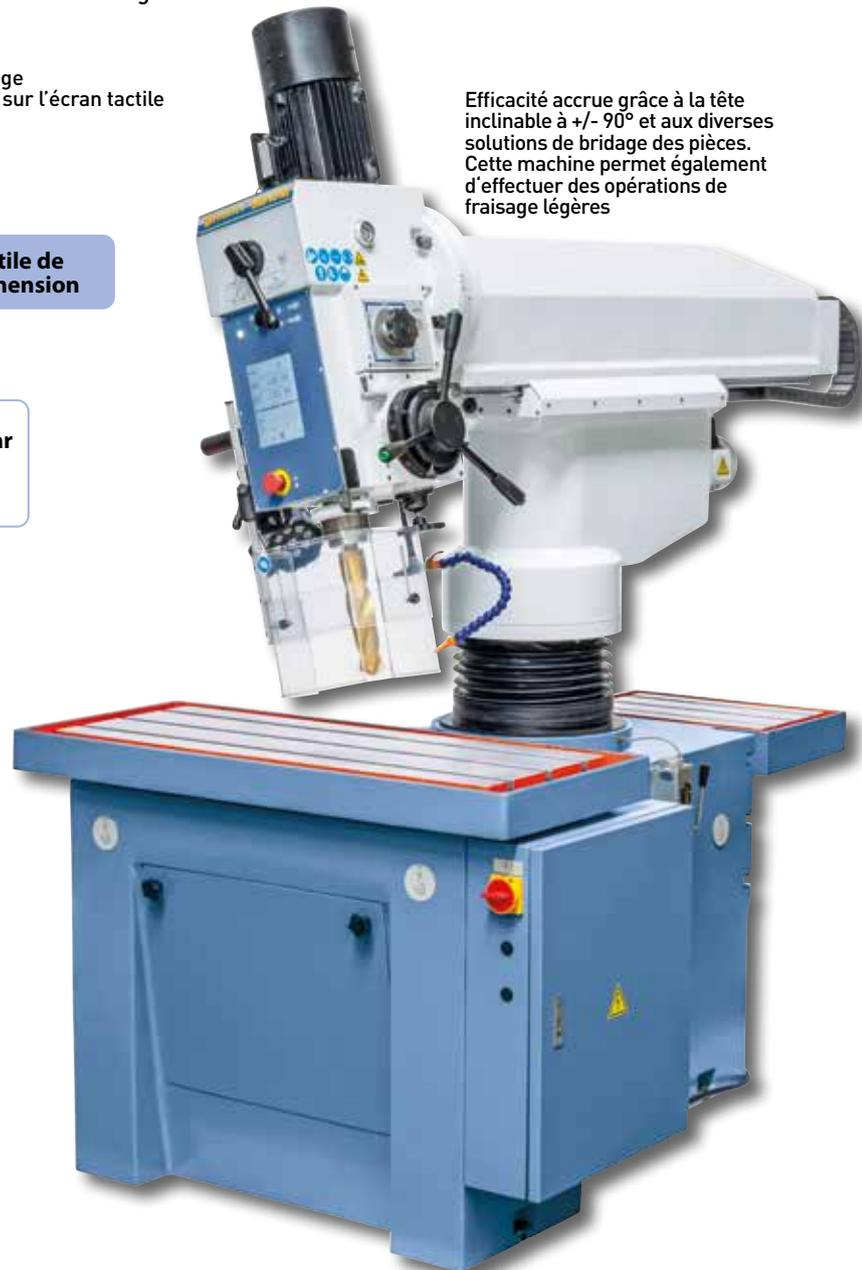
Efficacité accrue grâce à la tête inclinable à +/- 90° et aux diverses solutions de bridage des pièces. Cette machine permet également d'effectuer des opérations de fraisage légères
