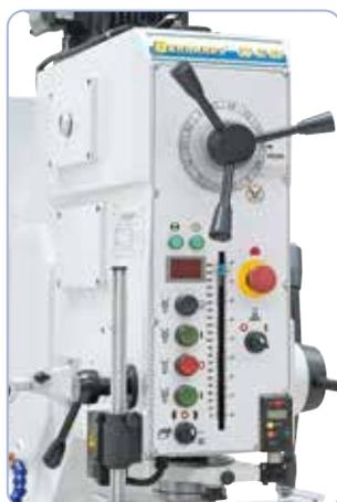
Disposition ergonomique des éléments de commande
