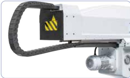
Moteur du groupe hydraulique et chaîne porte-câbles à l'arrière de la machine
