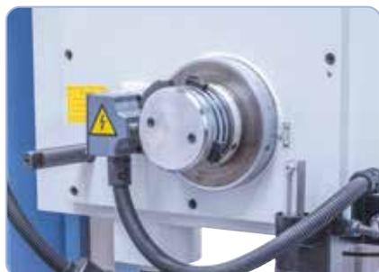
Dispositif de taraudage avec descente rapide et normale et remontée rapide (à KBM 63).
