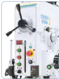
Tête massive avec éléments de commande ergonomiques. Affichage digital de la profondeur de perçage et de la vitesse de rotation de série
