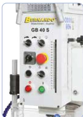
Disposition ergonomique des éléments de commande sur la tête
