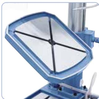
Table de perçage massive à rainures en T diagonales, orientable de -45° à +45°
