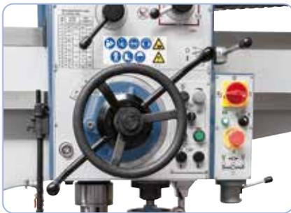
Trois moyens de déplacer la broche: avance rapide par levier, réglage fin par manivelle ou avance automatique
