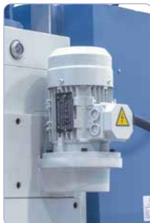
Moteur d'avance pour réduire les temps de positionnement de la broche (à KBM 63)
