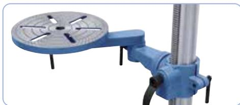
Table de perçage pivotante à  $360^{\circ}$ , idéale pour le perçage en coordonnées
