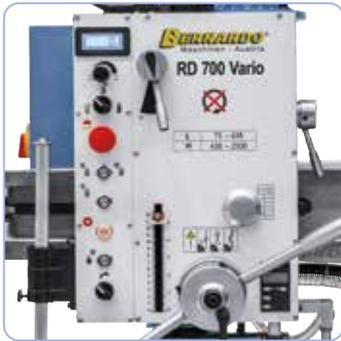
Travail confortable grâce aux éléments de commande centralisé
