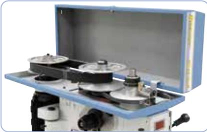
La transmission du moteur au fourreau de broche s'effectue par un robuste variateur
