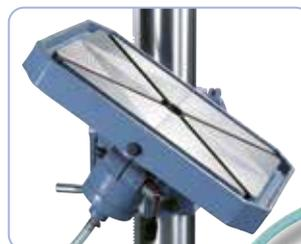
Table massive en fonte grise à rainures en T et rigole d'évacuation du fluide de coupe
