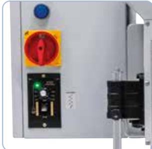
La vitesse d'avance souhaitée est réglée à l'aide d'un potentiomètre.
