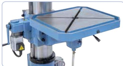
Table inclinable et pivotante (grattée à la main), de série avec moteur de positionnement
