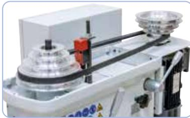
Poulies équilibrées en aluminium pour un fonctionnement silencieux, et courroie de qualité pour une transmission optimale.
