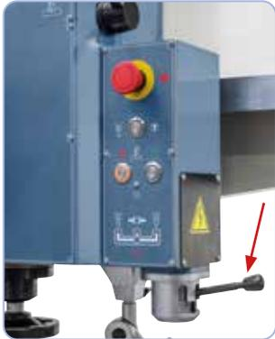
Inversion du sens de rotation et embrayage/débrayage de la broche par interrupteur pilote sous la tête de perçage
