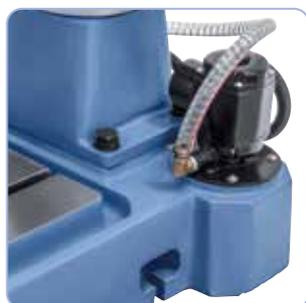
Socle usiné de précision, de série avec pompe d'arrosage intégrée (DMT 32 PFC).
