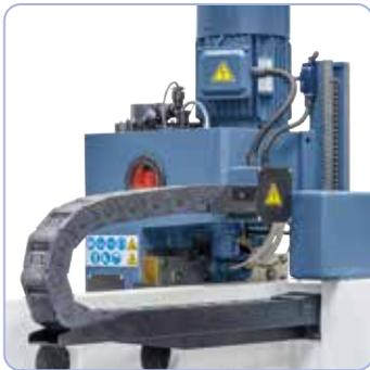
Contrepoids pour le fourreau de broche et la chaîne porte-câbles à l'arrière de la tête de perçage
