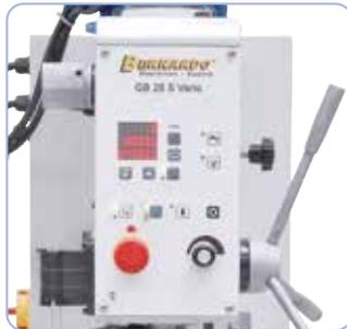
Présélection de l'étage de vitesse par transmission intermédiaire, réglage de la vitesse de rotation par potentiomètre
