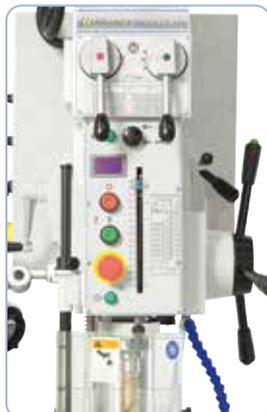
Réglage simple et rapide de la vitesse par commande à l'avant. Affichage digital de la vitesse de rotation
