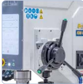
Pour un travail de précision, cette machine est équipée de série d'une avance automatique de broche et d'un affichage digital de profondeur de perçage
