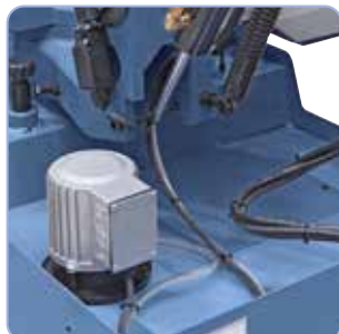
Vakiona tehokas jäähdytuspumppu.
