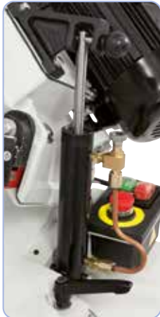
Vakiovarusteena hydraulisylinteri sahakaaren pehmeää laskemista varten.
