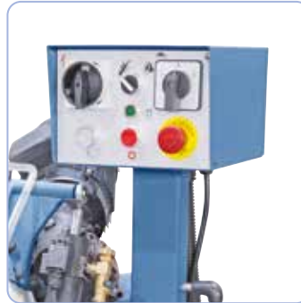
Selkeästi asennettu kytkentäkaappi koneen etupuolessa helpottaa työskentelyä.
