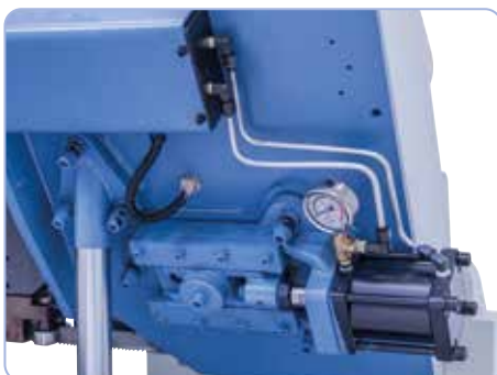
Varustettu vakiona sahanterän hydraulisella kiristimellä (NC Pro)
