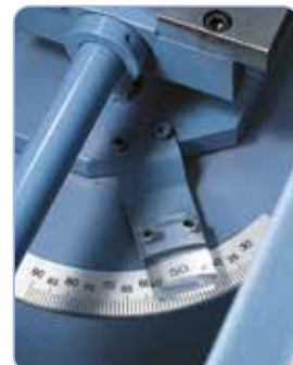
Toivotun sahauskulman säätö voidaan tehdä nopeasti ja helposti mitta-asteikon avulla.
