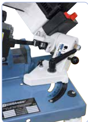
Sahakaaren lukituslaite mahdollistaa koneen paremman käsittelyn, kun konetta kuljetetaan mukana
