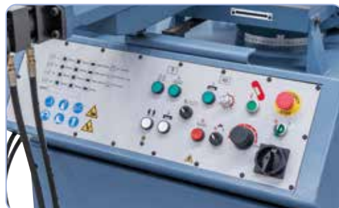
Portaattoman sahausnopeuden kytkin ja sahakaaren paineen säätöventtiili ovat ergonomisesti sijoitetussa käyttöpaneelissa.
