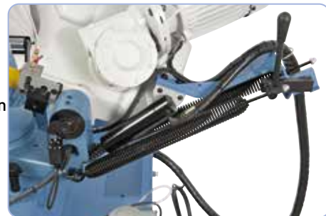
Vetojousella voi säätää manuaaliseen käyttöön.
