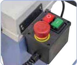
Alijännitelaukaisimella varustettu turvakytin ja erillinen hätäseis-kytkin. Automaattinen päältä pois -kytkentä sahaustoiminnon päätyttyä
