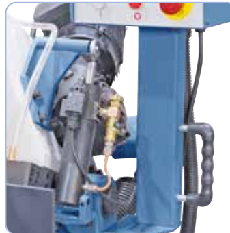
Iso hydraulisylinteri sahakaaren portaattomaan laskemiseen
