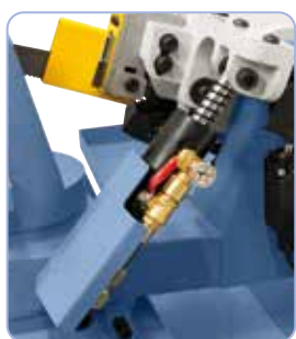
Vakiovarusteena hydraulisylinteri sahakaaren portaatonta laskemista varten.
