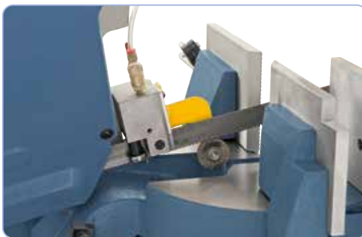
Yhdistetyt rulla-carbidihoiteet estää liiallisen teränpainamisen
