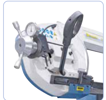
Ergonominen kahva, teränsäilytyksen asettaminen käsikahvalla.
