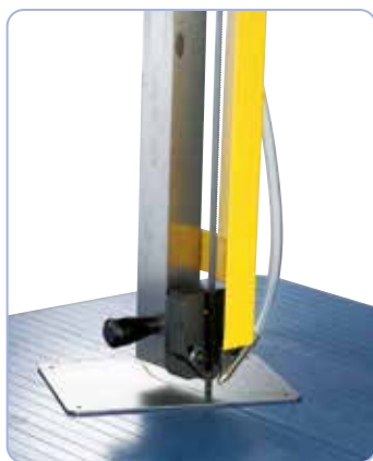
Kuulalaakeroitu teräohjain, säädettävissä kulloisenkin työkappaleen korkeuden mukaan.
