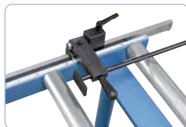
Millimetriasteikko mahdollistaa sahauspituuden tarkan säädön ja on helppo lukea
