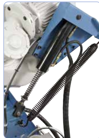
Vakiovarusteena hydraulisylinteri sahakaaren pehmeää laskemista varten.
