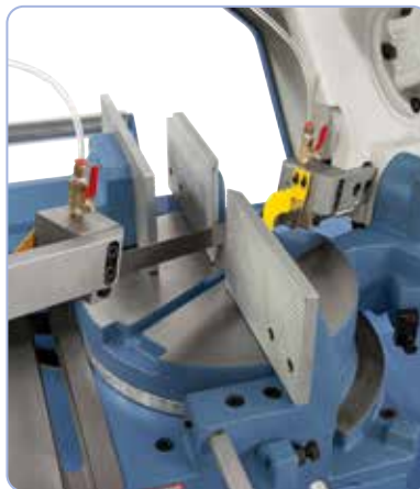
Kääntöalustassa oleva sahausrako liikkuu samanaikaisesti sahakaaren kanssa.
