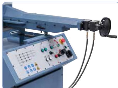
Siirrettävä ruuvipuristin, kiinnitys manuaalisesti tai hydraulisesti.
