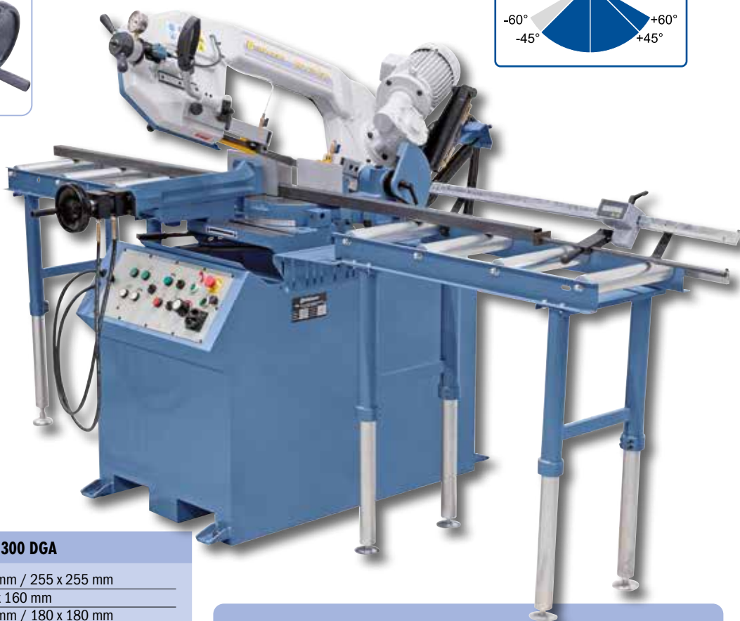
Vakiona hydraulinen laskusylinteri sahakaaren portaattonta laskua varten ja automaattinen poiskytkentä, kun materiaali on leikattu.
