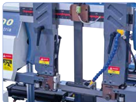
Säädettävä teränohjain estää sen, että terä liikkuu tai kallistuu sivusuunnassa.
