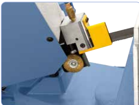
Kovametalliterillä varustettu teräohjain yhdistetyn rulla-leukaohjainjärjestelmän yläpuolella
