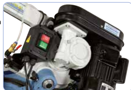
Sahausnopeutta (24 / 41 / 61 / 82 m/min) voidaan vaihtaa nopeasti ja helposti kiilahihnan avulla
