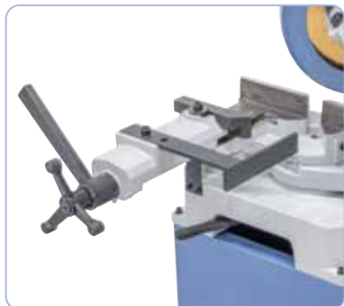
Suuri ruuvipuristin, jossa on pikakiinnitysvipu ja jäysteettömiin sahauksiin
