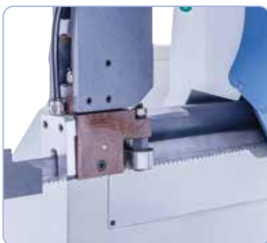
Yhdistetyt rulla-carbidijohteet estää liiallisen teränpainamisen
