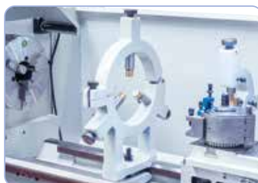
Kiinteä tukipylkkä pitkien työkappaleiden vakauttamiseen
