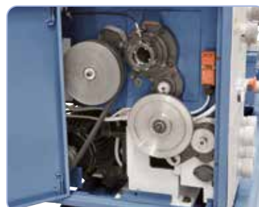
Karkaistu pääkara, hyvä karanpään pyörimistarkkuus ( \leq 0,015 mm) tarkkuuskuulalaakerin ansiosta
