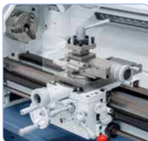
Pehmeästi liikkuva yläkelkka ja neliteränpidin käsipyörällä säädettävissä
