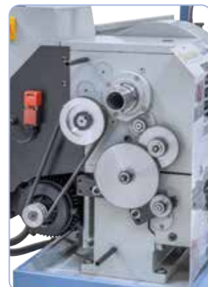
Vakiovarusteena vaihtopyörät kierteitykseen.
