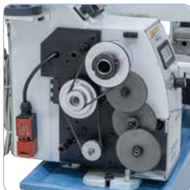
Vakiovarusteena vaihtopyörät kierteitykseen
