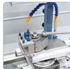
Koneeseen voidaan asentaa pikavaihtoteränpidin.
