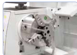
Keskele kiinnitettävä 4-leukaistukka 200 mm, optimaalinen nelikulmaisille työkaluille (lisävaruste).
