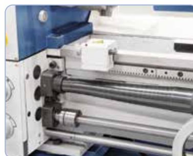
Vakiona mikrometri pitkittäisvasteessa ja johtoruuvien suojus
