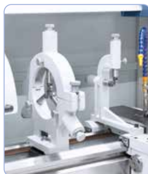
Vakiona kiinteä tai liikkuva tukipytkä pitkien työkalujen vakauttamiseen.
