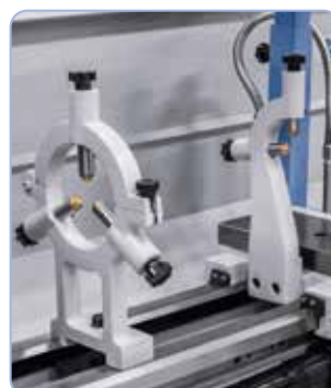
Vakiona kiinteä tai liikkuva tukipylkkä pitkien työkalujen vakauttamiseen.
