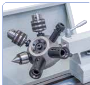
Koneeseen voidaan asentaa revolveripää työskentelyn tehostamiseksi
