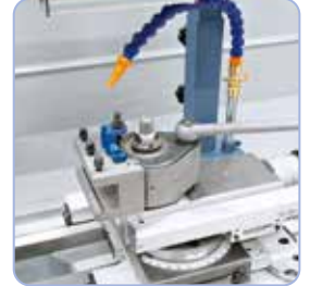
Koneeseen voidaan asentaa pikavaihtoteränpidin.
