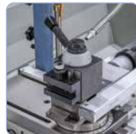
Pikavaihtoteränpidin mahdollistaa koneen käyttämiseen tarvittavan ajan lyhenemisen ja takaa hyvän toistotarkkuuden.
