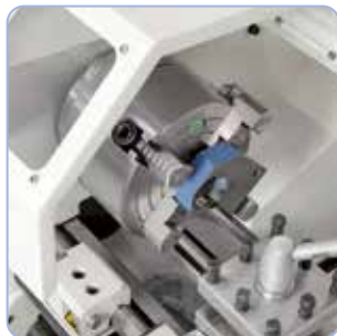
4-leukaistukka 160 mm (lisävaruste) ihanteellinen epäsymmetristen työkappaleiden kiinnittämiseen
