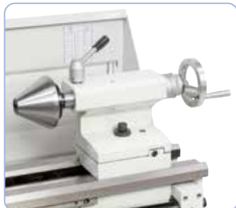
Takapylkkä pikalukituksella. Lisävarusteena saatavilla keskityskartio.
