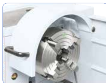
4-leukaistukka 250 mm (lisävaruste) ihanteellinen epäsymmetristen työkappaleiden kiinnittämiseen.
