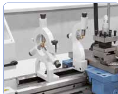
Vakiona kiinteä tai liikkuva tukipylkkä pitkien työkalujen vakauttamiseen.
