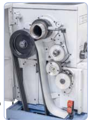
Tarkkuuskuulalaakeroitu, karkaistu pääkara takaa hyvän pyörimistarkkuuden, optimaalinen voimansiirto hammastettujen Optibelt -kiilahihnojen ansiosta
