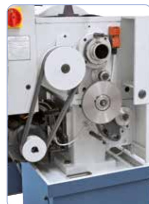
Vakiovarusteena vaihtopyörät kierteitykseen.
