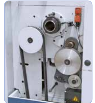
Vakiovarusteena täysi sarja vaihtopyöriä kiertettykseen.
