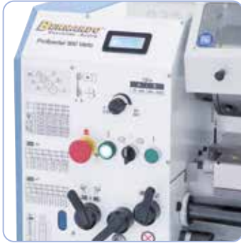
Elektroninen, portaaton kierrosluvun säätö, digitaalinäyttö helpottaa lukemista.
