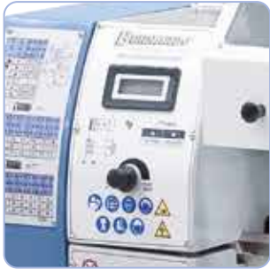
Elektroninen, portaaton kierrosluvun säätö, digitaalisyöttö helpottaa lukemista
