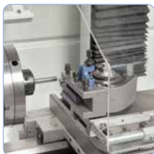
Koneeseen voidaan asentaa pikavaihtoteränpidin.
