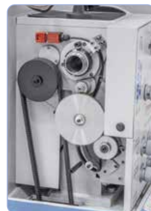
Vakiovarusteena vaihtopyörät kierteitykseen.
