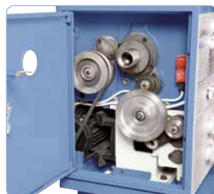
Vakiovarusteena täysi sarja vaihtopyöriä kierteitykseen
