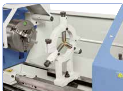
Kiinteä tukipylkkä, jossa pronssijohde pitkien työkalupaleiden vakauttamiseen
