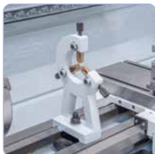
Kiinteä tukipylkkä, jossa pronssijohde pitkien työkappaleiden vakauttamiseen.
