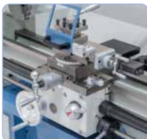
Pehmeästi liikkuva yläkelkka ja neliteränpidin käsipyörällä säädettävissä
