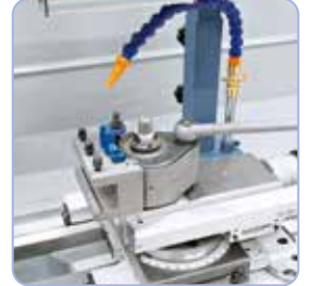
Koneeseen voidaan asentaa pikavaihtoteränpidin.
