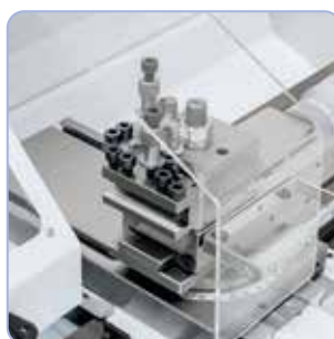
Koneeseen voidaan asentaa pikavaihtoteränpidin
