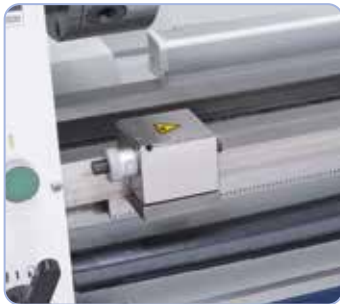
Vakiona mikrometri pitkittäisvasteessa ja johtoruuvin suojus
