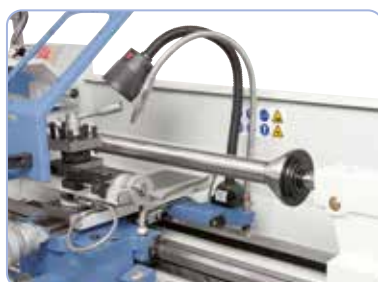
Kartion halkaisija 100 mm, ihanteellinen putkien ja onttojen kappaleiden kiinnittämiseen (lisävaruste)
