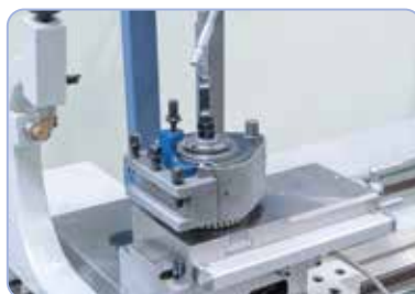
Koneessa on vakiona pikavaihtoteränpidin.
