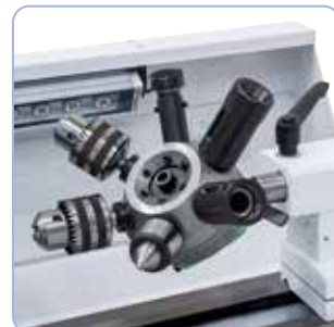
Koneeseen voidaan asentaa revolveripää työskentelyn tehostamiseksi
