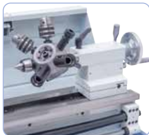
Koneeseen voidaan asentaa revolveripää.
