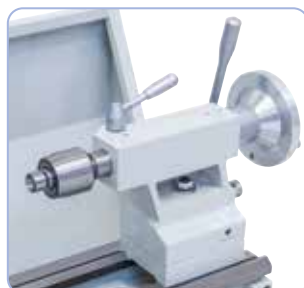
Yleiskäyttöön on saatavilla lisävarusteena pyörivä keskiökärki, tyyppi SMA, johon kuuluu 7 vaihdettavaa pidintä.
