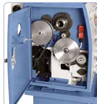
Vakiovarusteena täysi sarja vaihtopyöriä kierteitykseen
