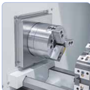
Hydraulinen 3-leukaistukka, halkaisija 200 mm
