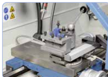
Vakiona pikavaihtoteränpidin, Multifix-järjestelmä (Standard 165 Top)
