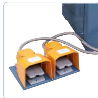
Vakiona poljin leukaistukan kiinnitykseen tai kärkipylkkäkaran siirtoon.
