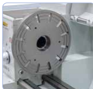
Erityismuotoisten työkalupaleiden kiinnittämiseksi voidaan koneeseen asentaa kiinnityslaikka 250 mm.
