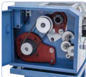
Vakiovarusteena vaihtopyörät kierteitykseen.
