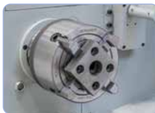
4-leukaistukka 160 mm (vakio) ihanteellinen epäsymmetristen työkalujen kiinnittämiseen
