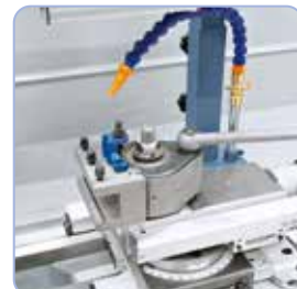
Koneeseen voidaan asentaa pikavaihtoteränpidin.
