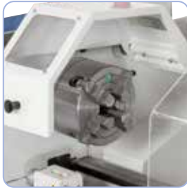
4-leukaistukka (lisävaruste) epätasaisen työkalupäiden kiinnittämiseen
