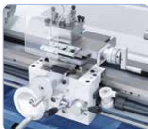
Pehmeästi liikkuva yläkelkka ja neliteränpidin käsipyörällä säädettävissä
