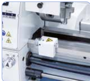
Vakiona johtoruuvien suojaus ja mikrometri pitkittäisvasteessa (700 Top)
