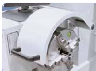
Keskele kiinnitettävä 4-leukaistukka 200 mm, optimaalinen nelikulmaisille työkalupaleille (lisävaruste).
