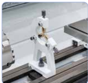
Kiinteä tukipylkkä, jossa pronssijohde pitkien työkappaleiden vakauttamiseen.
