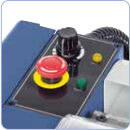
Portaaton pääkaran kierrosluvun säätö potentiometrillä.
