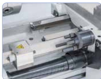
Vakiona mikrometri-pitkittäis- ja revolverivaste.
