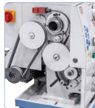
Vakiovarusteena täysi sarja vaihtopyöriä kierteitykseen.
