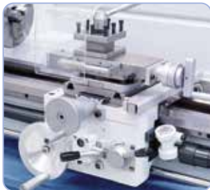
Kytkinvipu pitkittäis- ja poikittaissyötön säätämiseen.
