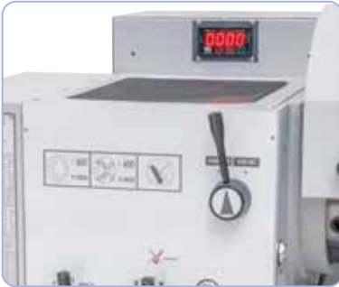
Elektroninen, portaaton nopeudensäätö, digitaalinäyttö mahdollistaa vaivattoman nopeudensäädön.
