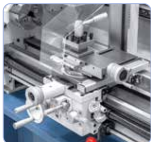
Pehmeästi liikkuva yläkelkka ja neliteräspidin käsipyörällä säädettävissä
