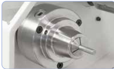
Lisävaruste: kiristysolkisarja 5C, kiristysalue 3 - 26 mm.
