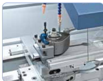
Pikavaihtoteränpidin mahdollistaa koneen käyttämiseen tarvittavan ajan lyhenemisen ja takaa hyvän toistotarkkuuden.
