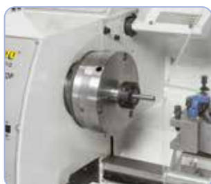
Kiristysholkki-istukka ER 25 takaa hyvän pyörimistarkkuuden kiinnitetyille työkaluille, kiristysalue 1 - 16 mm.
