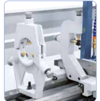
Vakiona kiinteä tai liikkuva tukipylkkä pitkien työkalupäiden vakauttamiseen.
