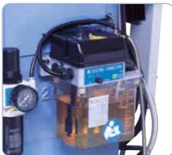
Sähköinen keskusvoitelu kaikille ohjainkiskoille ja karoille
