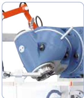
Yleisjyrsinpää, säädettävissä erilaisiin kulma-asentoihin.
