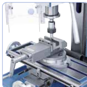
Valinnaisesti toimitettavissa: varsijyrsin ja KM-kääntöterät
