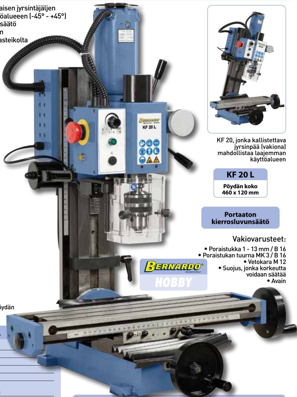
Mekaaninen kierrosluvun säätö ja portaattomasti säädettävä tasavirtamoottori
