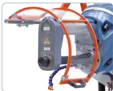
Vakiona vastalaakeri ja pitkä jyrsintuurna vaakajyrsintään.
