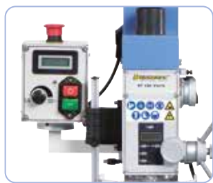
Toimitukseen sisältyy digitaalinen kierrosluvun ja poraussyvyyden näyttö
