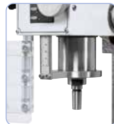
Erittäin iso, kuulalaakeroitu kara takaa hyvän pyörimistarkkuuden
