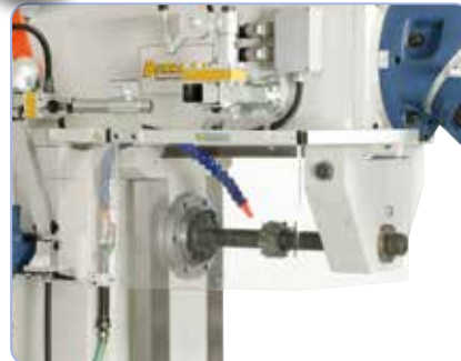
Vakiona vastalaakeri ja pitkä jyrsintuurna vaakajyrsintään
