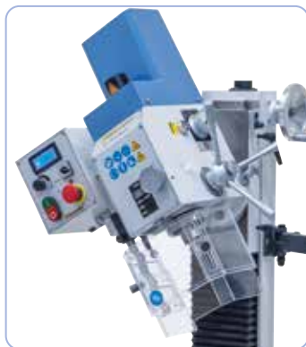
Molemmipuolisesti kallistettava jyrsinpää -90° - +90°
