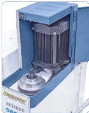
Erittäin tasainen käynti tasapainotettujen vetopyörien ansiosta
