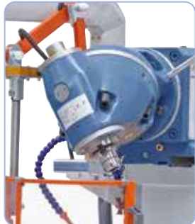
Yleisjyrsinpää, säädettävissä erilaisiin kulma-asentoihin
