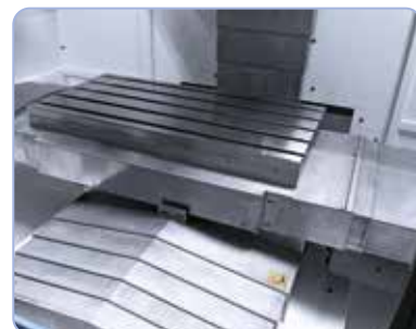
Tarkkuushiottu työpöytä ja teleskooppisuojaus kaikissa akseleissa.
