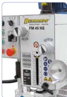
Helppo ja nopea kierrosluvun vaihto valintakytkimen avulla
