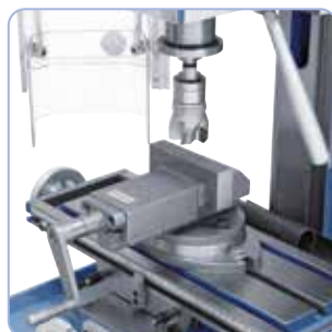
Jyrsintä taso- ja kulmajyrsimellä (tuotenro 42-1057)
