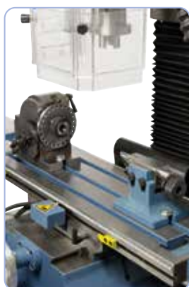
Jakopää BS-0: optimaalinen akselityöstöön
