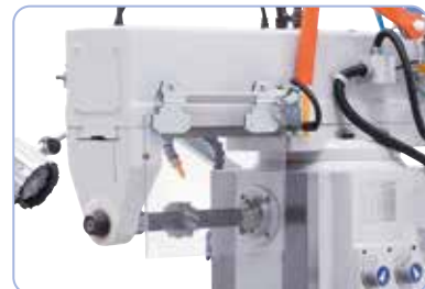
Vakiona vastalaakeri ja pitkä jyrsintuurna vaakajyrsintään.
