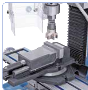
Jyrsintä taso- ja kulmajyrsimellä (tuotenro 42-1058)
