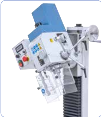
Molemmipuolisesti kallistettava jyrsinpää -90° - +90°
