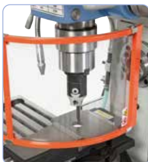
Lisävaruste: avarruspää halkaisija 75 mm ja ruuvipuristin FJ 125
