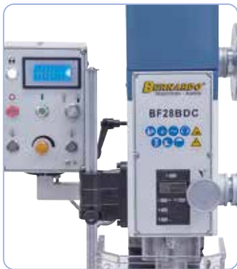
Toimitukseen sisältyy digitaalinen kierrosluvun ja poraussyvyyden näyttö
