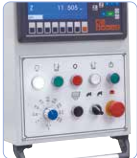
Haluttu syöttönopeus voidaan säätää nopeasti ja helposti suoraan ohjauspaneelista.
