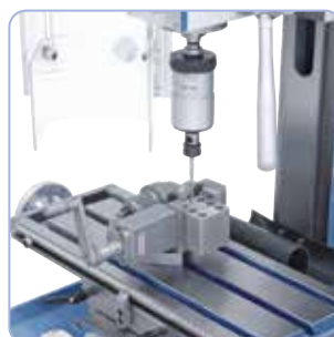
Kone voidaan varustaa kierteitystä varten M5 - M12 kierteityslaitteella.
