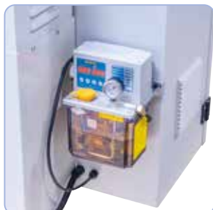
Vakiovarusteena sähköinen keskusvoitelu
