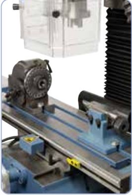
Jakopää BS-0: optimaalinen akselityöstöön
