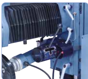
Sis. hydraulinen työkalukiinnike vetokaralla (DIN 69872)
