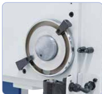
Kierteityslaitteessa on kiertosuunnan vaihto, ihanteellinen sarjavalmistuksessa (että KBM 50).
