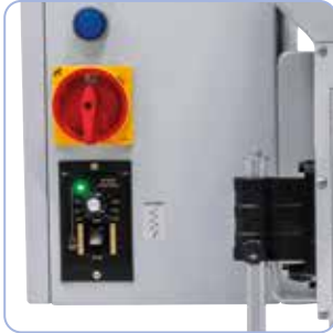
Haluttu syöttönopeus asetetaan potentiometrillä.
