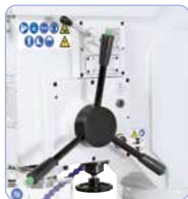
Massiivinen porapöytä, jota voidaan kiertää ja kääntää, sopii yleisiin kiinnitystapoihin
