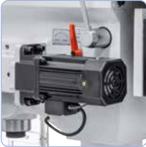
Portaattomasti säädettävä karan syöttö erillisellä käyttömoottorilla.
