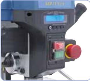
Vakiona digitaalinen kierrosluvun ja poraussyvyyden näyttö
