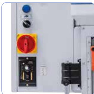
Haluttu syöttönopeus asetetaan potentiometrillä.
