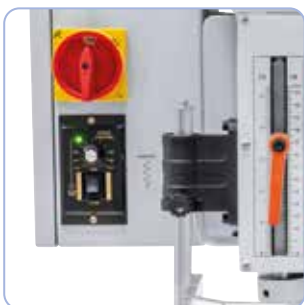
Haluttu syöttönopeus asetetaan potentimetrillä.
