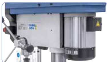
IP 54 mukainen tehokas alumiinimoottori
