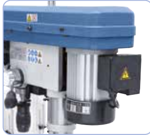
Tehokas ja korkealaatuinen alumiinimoottori käy tasaisesti.
