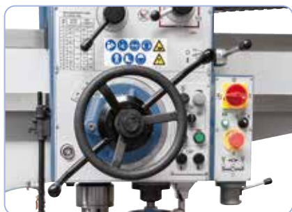
Karaa voi käsitellä 3 eri tavalla: pikaliike käsivivun avulla, hienosyöttö käsipyörällä tai automaattinen syöttö
