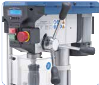
Helppo karan säätö ergonomisesti sijoitettujen kädensijojen ansiosta
