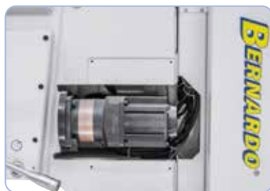
Vakiona servomoottori automaattista langansyöttöä varten.
