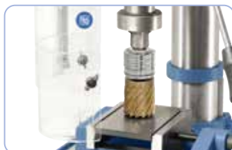
Lisävarusteena pikakiinnitys tuurna kernaporille
