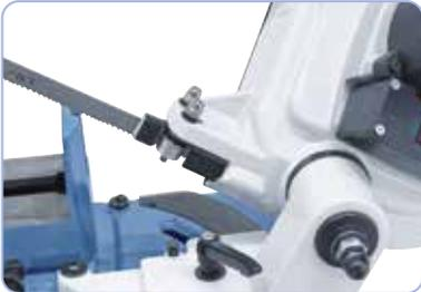
Óptimos resultados de corte gracias al guiado de la cinta mediante rodamientos a bolas
