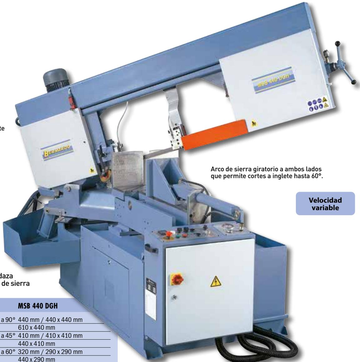
Arco de sierra giratorio a ambos lados que permite cortes a inglete hasta 60°.
