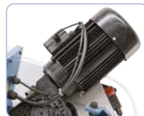
Potente motor de fundición gris según IP 54
