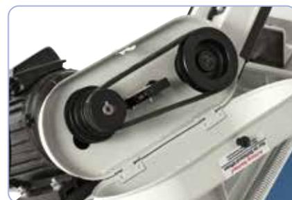
Mediante una correa trapezoidal puede cambiarse de forma rápida y sencilla la velocidad de la cinta.
