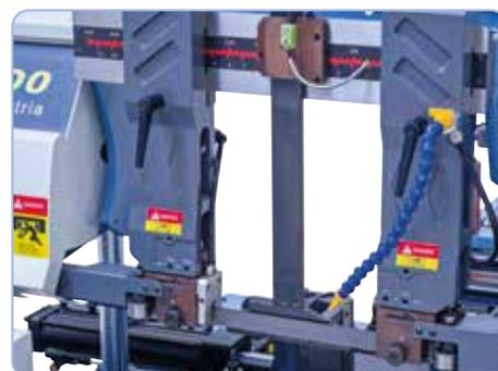
El guiado de cinta de sierra ajustable evita que la cinta de la sierra se desplace lateralmente o se incline.
