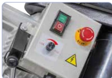
Velocidad de corte variable para una adaptación óptima a la pieza de trabajo correspondiente, consola de control fácil de usar.
