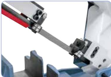
El guiado de la cinta con rodamientos a bolas y ajuste rápido para adaptarlo al ancho de la pieza de trabajo garantiza unos resultados óptimos.
