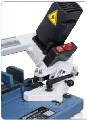
Motor con control de velocidad electrónico
