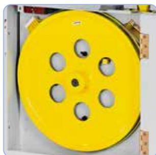
Los volantes de arrastre tienen una banda de goma especial para asegurar un funcionamiento suave e incrementar la vida útil de la hoja de sierra.
