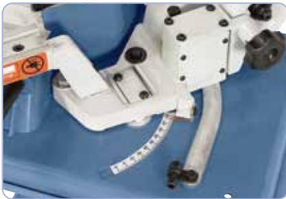
Arco de sierra ajustable para efectuar cortes a inglete
