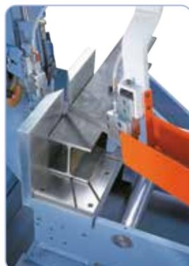
El guiado de la cinta de la sierra con ajuste rápido para adaptarlo al ancho de la pieza de trabajo garantiza un resultado de corte óptimo.
