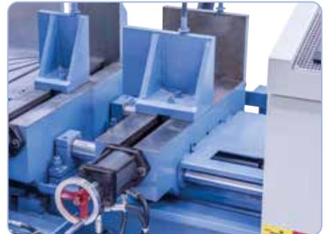
Avance de material mediante dispositivo de sujeción hidráulico y guía redonda de precisión
