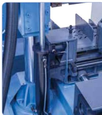
Para una bajada sensible del arco de sierra, dispone de un cilindro hidráulico.
