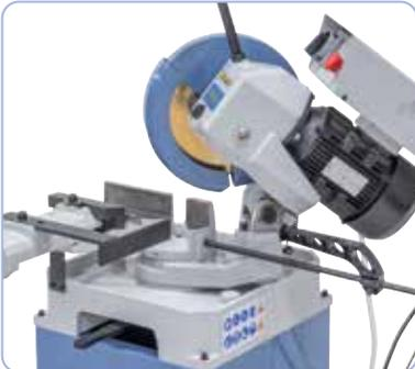
Cabezal de engranajes inclinable (45° izquierda / derecha), óptimo para corte a inglete
