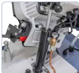
De serie con cilindro hidráulico para una bajada continua del arco de sierra.
