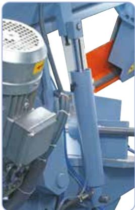
Para una bajada sensible del arco de sierra, dispone de un cilindro hidráulico.
