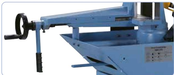
La mordaza de fundición gris está equipada con un ajuste rápido, óptimo para trabajos en serie.
