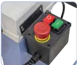
Interruptores de seguridad con desactivación en caso de caída de tensión y un botón de parada de emergencia independiente, desconexión final automática después de la finalización de proceso de corte
