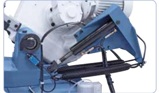
De serie con cilindro hidráulico para un descenso suave del arco de sierra.
