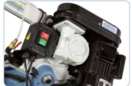
Mediante una correa trapezoidal puede cambiarse la velocidad de corte (23 / 33 / 52 m/min)
