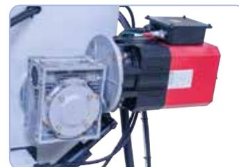
Velocidad de corte regulable de forma continua y elevado par de giro gracias al potente servomotor
