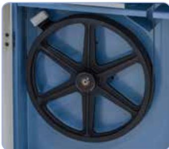
Los volantes de arrastre tienen una banda de goma especial para asegurar un funcionamiento suave e incrementar la vida útil de la hoja de sierra.
