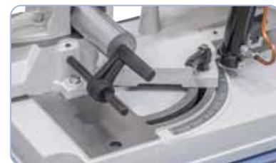
El arco de sierra puede girarse en los cortes a inglete de +45° a -60°.
