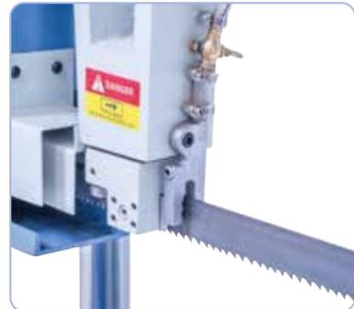
Guiado de la cinta mediante un sistema combinado de rodillos y piezas de carburo.
