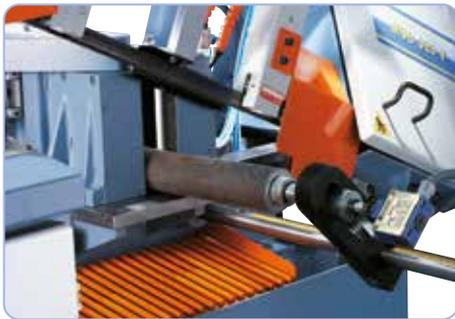
El tope de la pieza de trabajo con desconexión final del avance de los rodillos es la solución perfecta para trabajos en serie.
