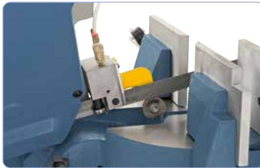
La combinación de guías de rodillos y placas de carburo previene el excesivo desgaste de la cinta
