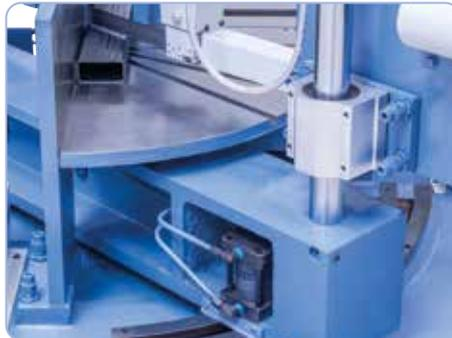
Ajuste automático del ángulo de corte con sujeción hidráulica.
