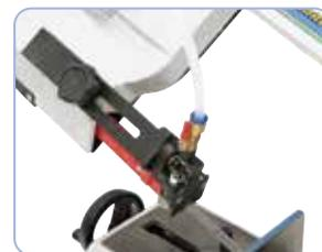
Guiado de la cinta con rodamientos a bolas, ajustables a cada uno de los anchos de la pieza de trabajo
