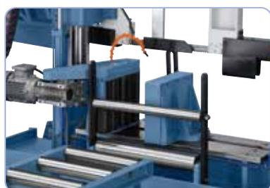
Avance por rodillos accionado por motor para un transporte óptimo del material.
