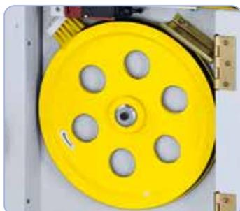
Los volantes equilibradas dinámicamente y de fundición gris garantizan un funcionamiento silencioso de la máquina.
