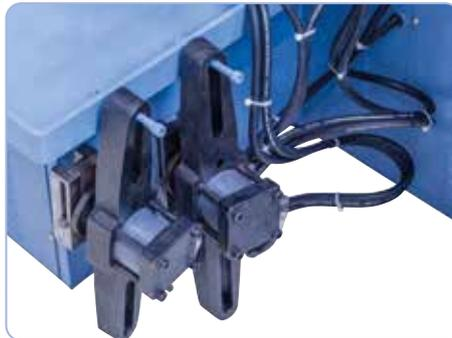
Dispositivo hidráulico de sujeción superior para ambos tornillos de banco incluido en la entrega.
