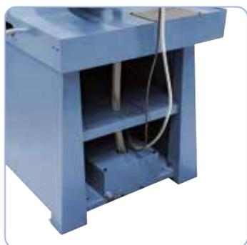
Potente dispositivo de refrigeración, integrado en el banco armario para reducir espacio.
