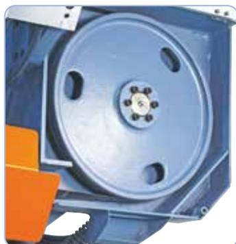
Los volantes equilibrados dinámicamente son de fundición gris y garantizan un funcionamiento silencioso.
