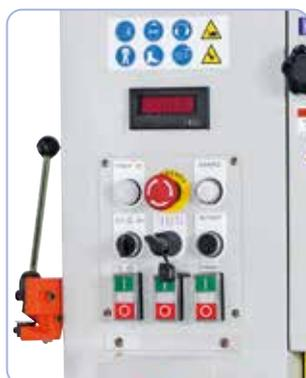
Completa con pantalla LED para un sencillo ajuste de revoluciones.
