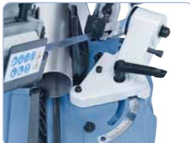
Arco de sierra ajustable para efectuar cortes a inglete
