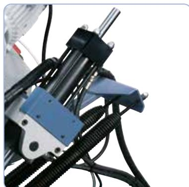
Cilindro hidráulico bien dimensionado, para trabajo continuado.
