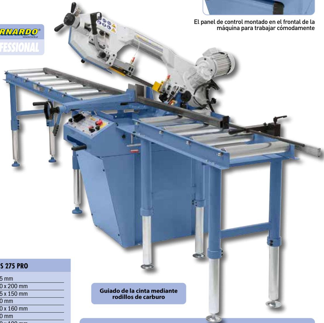
Guiado de la cinta mediante rodillos de carburo
