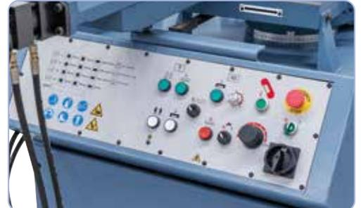
Conmutador giratorio para regular la velocidad de corte y válvula de control de la presión del soporte en el ergonómico panel de mandos
