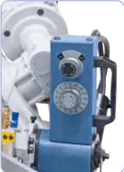
Descenso con ajuste continuo del arco de sierra mediante válvula de regulación.
