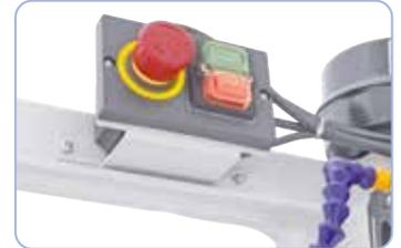
Interruptores de seguridad con desactivación en caso de caída de tensión y un botón de parada de emergencia independiente
