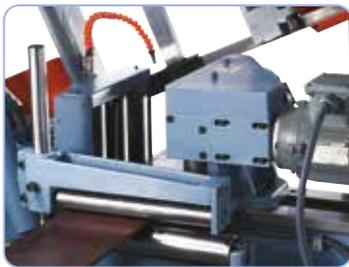
La mordaza está equipada de serie con rodillos accionados por un motor para el avance de las piezas a cortar.
