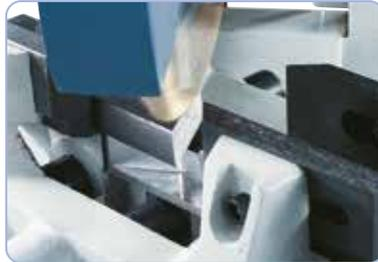
Cabezal de engranajes inclinable (45° izquierda / derecha), óptimo para corte a inglete.
