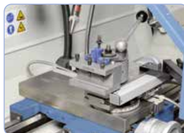
Portaherramientas de acero de cambio Multifix, incluido en el equipo base. (Standard 165 Top)
