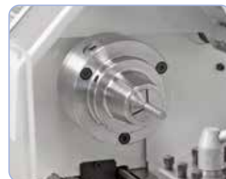
Opcional: portapinzas 5C, capacidad de sujeción 3 - 26 mm
