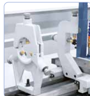
Luneta fija y móvil de serie para la sujeción de piezas de trabajo
