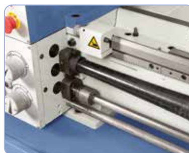
De serie con tope longitudinal micrométrico y embrague de seguridad
