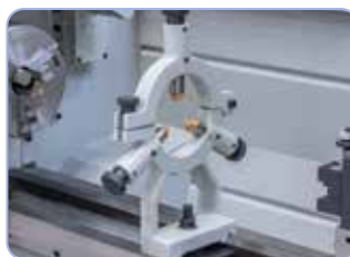
Luneta fija con guías de bronce para la sujeción de piezas de trabajo largas
