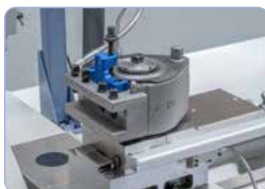
Para aumentar la eficiencia en el trabajo, la máquina está equipada de serie con un portaherramientas de cambio rápido
