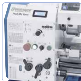
Regulación de revoluciones electrónica continua, fácil lectura mediante visualizador digital.
