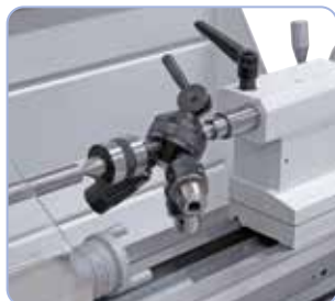
Para un trabajo más rentable, la máquina puede equiparse con una torreta portátiles.
