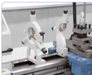
Luneta fija y móvil para la sujeción de piezas de trabajo
