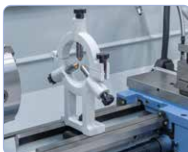
Luneta fija con guías de bronce para la sujeción de piezas de trabajo largas
