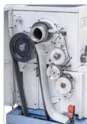
Husillo principal templado con rodamientos cónicos de alta precisión para una elevada concentricidad: una transmisión óptima de la potencia mediante correas trapezoidales dentadas Optibelt
