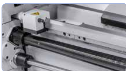
De serie con tope longitudinal micrométrico y embrague de seguridad
