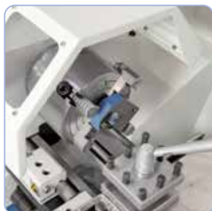
Plato de 4 garras independientes de 160 mm (opcional) ideal para el amarre de piezas asimétricas.
