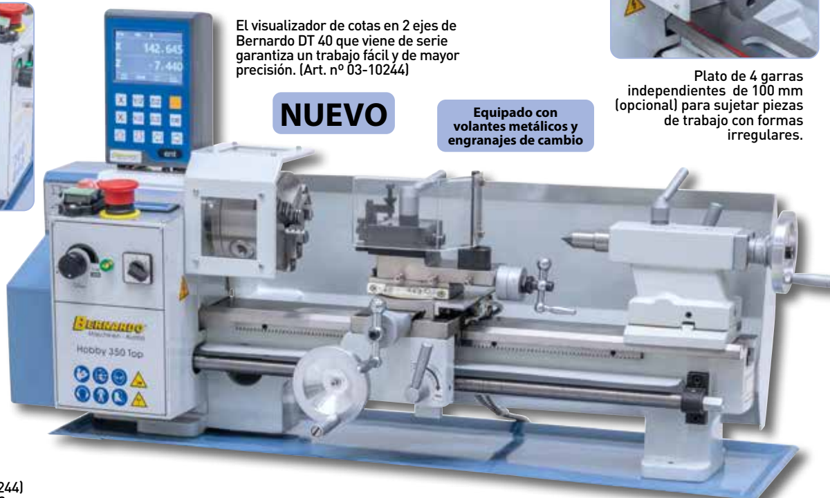
De serie con engranajes metálicos para el tallado de roscas métricas
