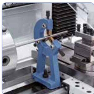
Luneta fija con dedos de bronce para evitar el pandeo de piezas largas y finas
