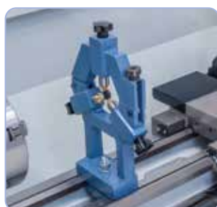
Luneta fija con guías de bronce para la sujeción de piezas largas.
