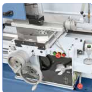
Equipado de serie con posicionado rápido para reducir tiempos muertos.
