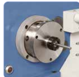
El portapinzas ER25 asegura una alta concentricidad de sujeción, entre 1 y 16mm
