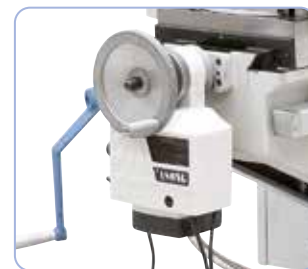
Avance automático del eje Y de serie
