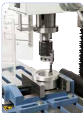
Si lo desea, la máquina se puede equipar con un cabezal de mandrinado.
