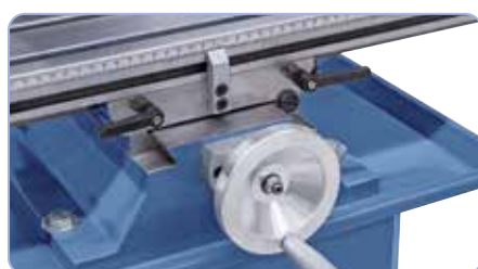
Guías en cola de milano ajustables con regletas en todos los ejes
