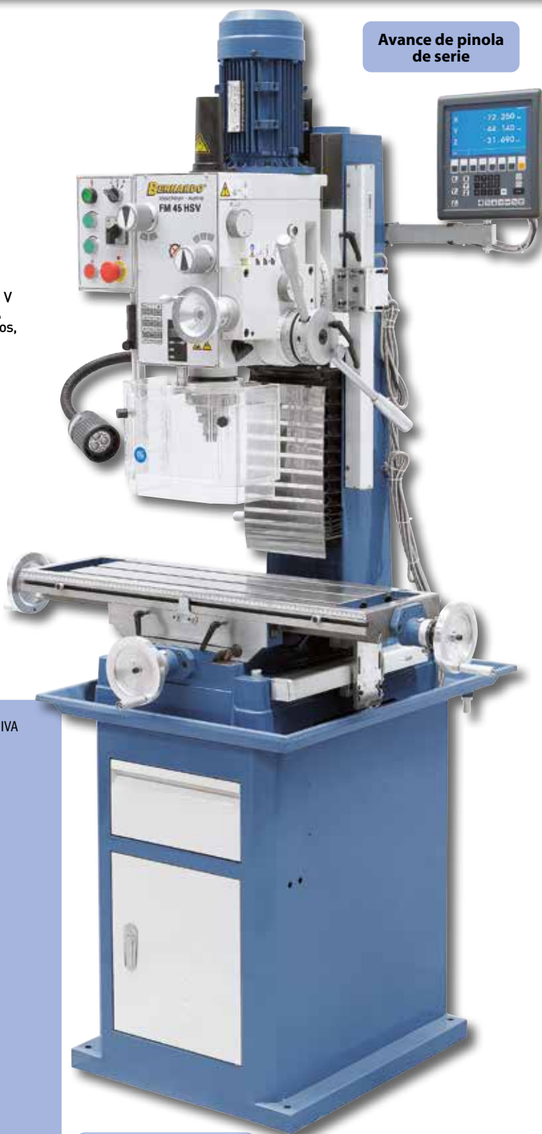
Indicador digital de profundidad de taladro
