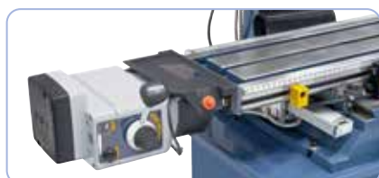
Avance automático de la mesa, regulable continuamente (Ref: 02-10231 / 02-10240).
