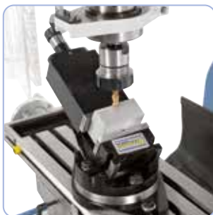
Fresado con tornillo de banco de 2 ejes
