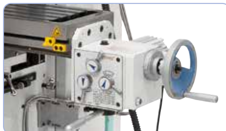
Avance longitudinal en el eje X con marcha rápida de serie
