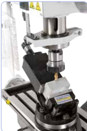
Fresado con mordaza inclinable y giratoria
