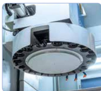
Cambiador automático de 16 herramientas con cambio rápido.
