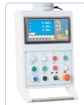
Panel de control amigable. Equipado de serie con visualizador de cotas.
