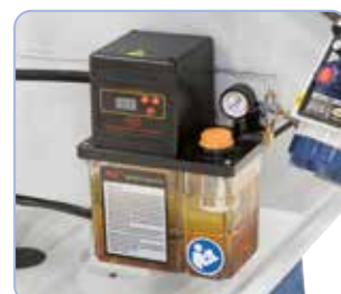
Lubricación central automática incluida en el equipo base
