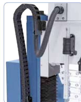
Incluye cadena para guiado de cables
