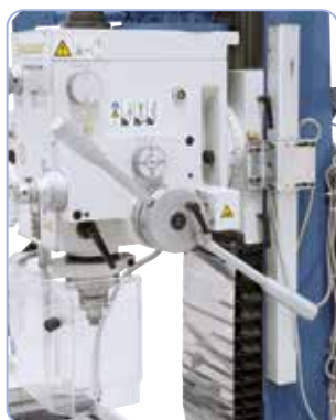
El avance de pínola se puede ajustar a 0,10 / 0,18 o a 0,26 mm/r, según se desee
