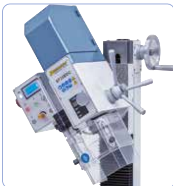
Cabezal inclinable a ambos lados +/-90°
