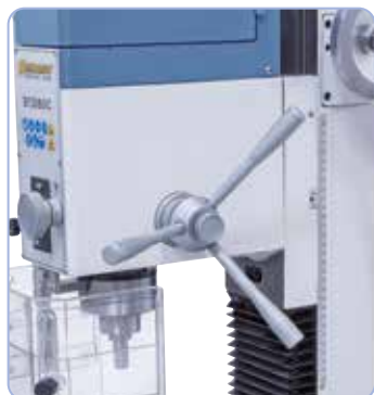
Grandes manetas para el movimiento de la pinola. Volante con nonius para ajuste fino.
