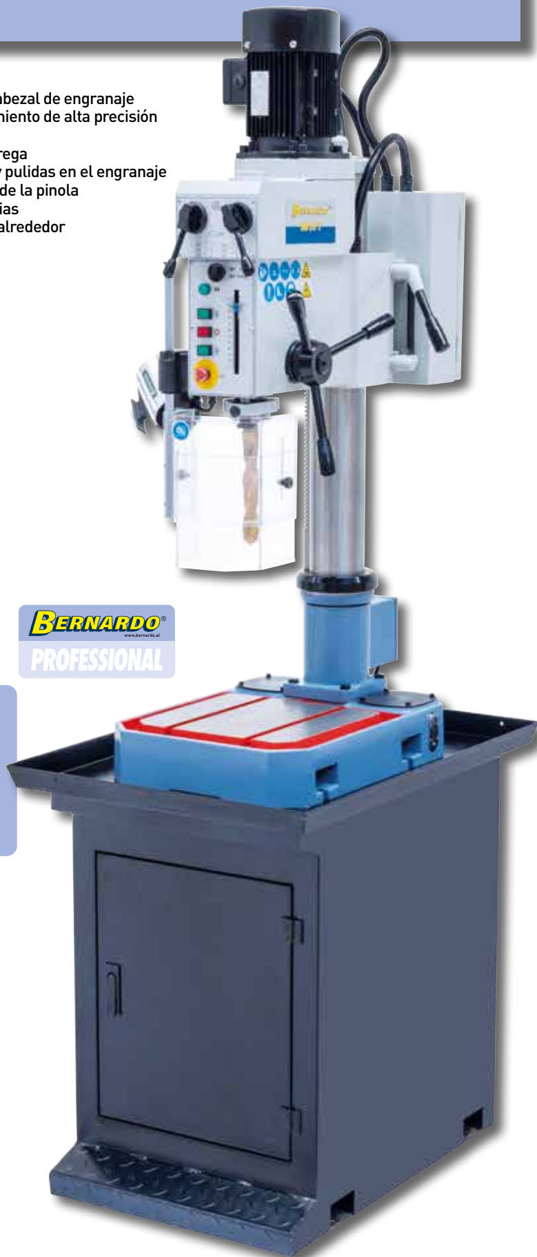
Mesa de trabajo maciza de grandes dimensiones con ranuras en T. GB 30T con dispositivo de refrigeración opcional
