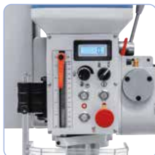
De serie equipada con regulación digital de revoluciones. Elementos de conmutación y de operación dispuestos de forma ergonómica en la parte frontal (DMT 25 PFV).
