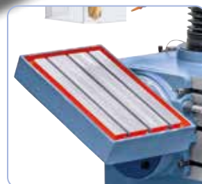
Campo de aplicación ampliado gracias a la mesa horizontal inclinable de -50° a +50°
