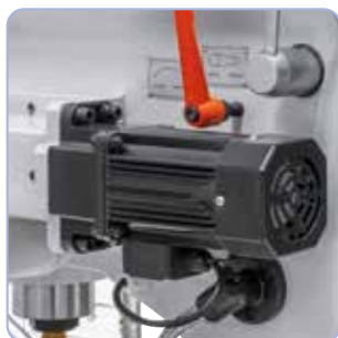
Avance ajustable continuo de la pinola con motor independiente.
