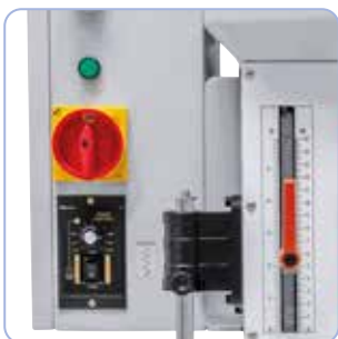
La velocidad de alimentación deseada se ajusta mediante un potenciómetro.
