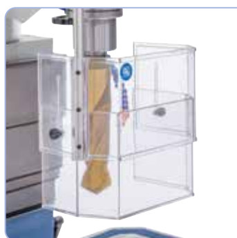
Cubierta de protección conforme a la normativa de la CE ajustable a la longitud de taladrado
