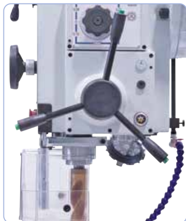
6 avances de taladrado automáticos activables mediante acoplamiento electromagnético.
