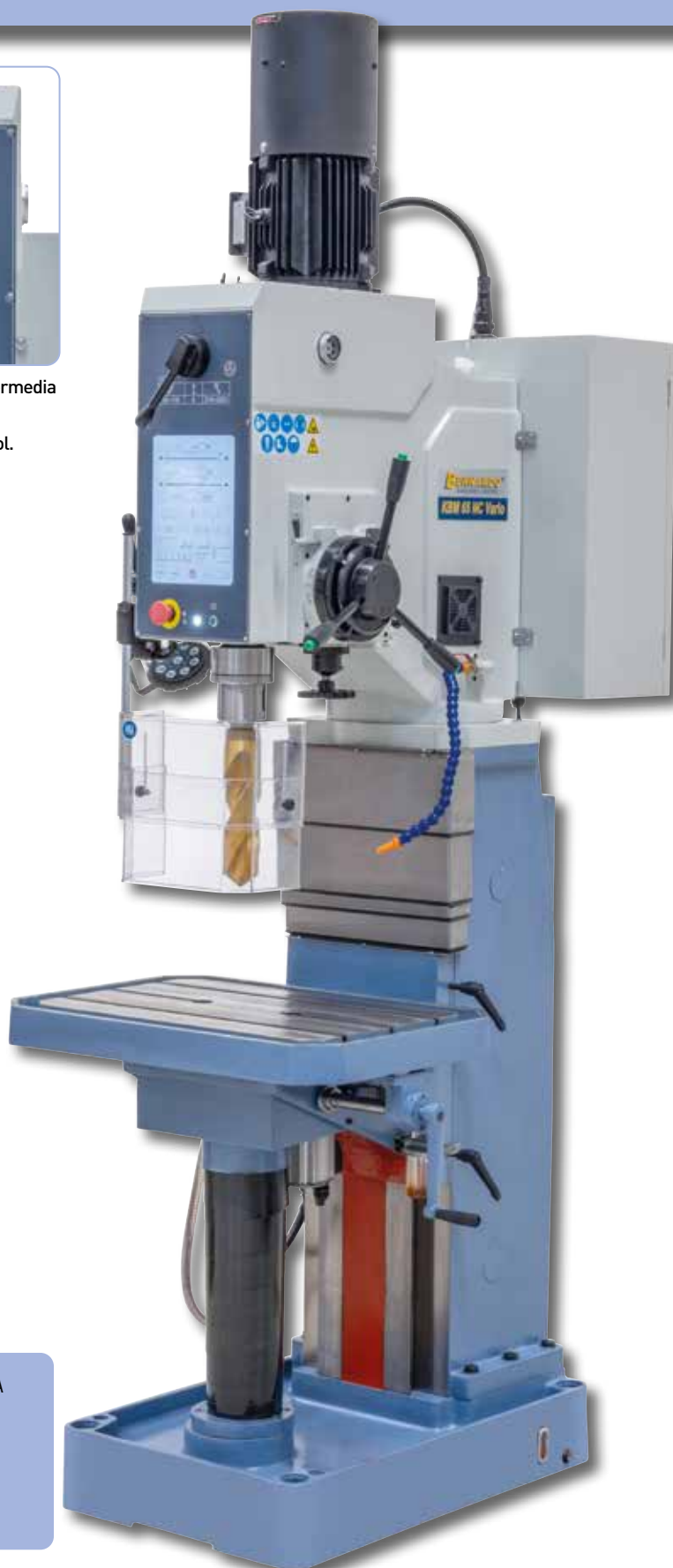
Pantalla táctil de gran tamaño con control Bohrtronic.
