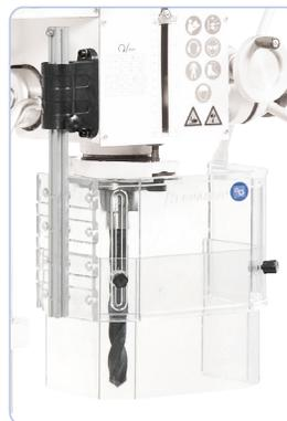
Schutzeinrichtung mit teleskopisch einstellbarem Schutzglas und vertikaler Einstellmöglichkeit.
