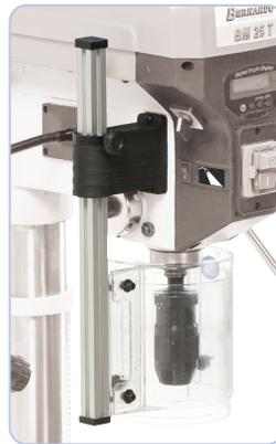
Schutzeinrichtung mit teleskopisch einstellbarem Schutzglas und vertikaler Einstellmöglichkeit.
