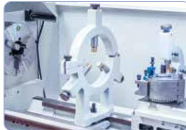
Feststehende Lünette zum Stabilisieren von langen Werkstücken
