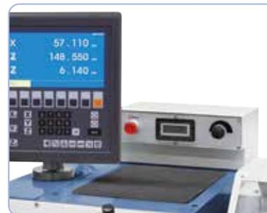
Elektronisch, stufenlose Drehzahlregelung, leichtes Ablesen mittels Digitalanzeige.
