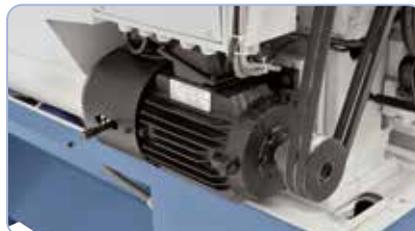
Leistungsstarker Antriebsmotor mit Magnetbremse nach CE-Norm.
