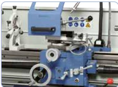
Leichtgängiger und präziser Schlitten mit Obersupport und Vierfachstahlhalter, Handräder mit einstellbarer metrischer Feinskalierung
