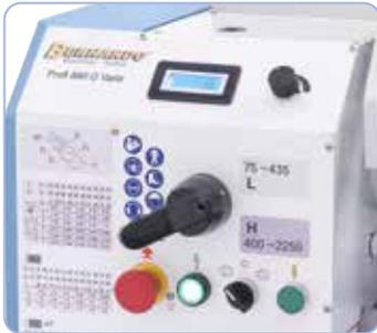
Einfache Vorwahl der Getriebestufe mittels Vorgelege, Einstellen der gewünschten Drehzahl mittels Potentiometer.
