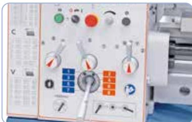
Vorschubgetriebe leicht und präzise schaltbar, geschliffene Zahnräder sorgen für einen ruhigen Lauf.
