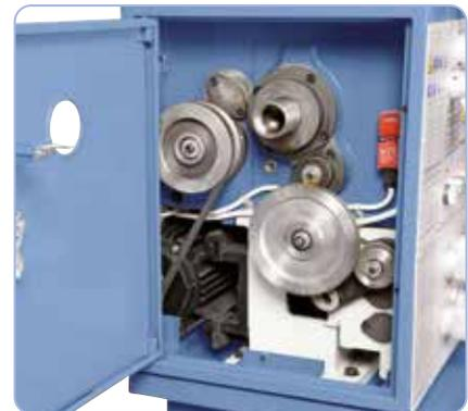
Lieferumfang komplett mit Wechselräder zum Gewindeschneiden
