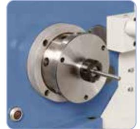
Das Spannzangenfutter ER 25 gewährleistet eine hohe Rundlaufgenauigkeit beim Spannen von Werkstücken, Spannbereich 1 - 16 mm
