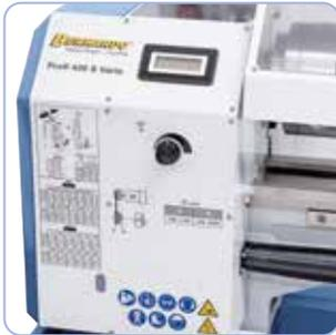
Elektronisch, stufenlose Drehzahlregelung, leichtes Ablesen mittels Digitalanzeige.
