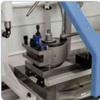
Der Schnellwechselstahlhalter ermöglicht eine Reduzierung der Nebenzeiten und gewährleistet eine hohe Wiederholgenauigkeit.
