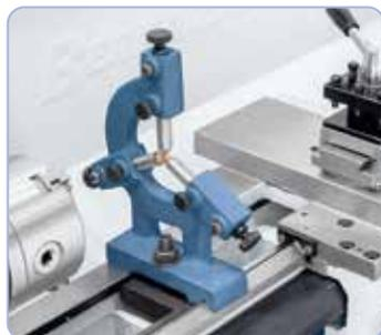
Feststehende Lünette mit Bronzeführung zum Stabilisieren von langen Werkstücken.
