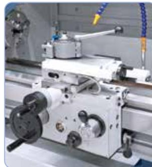
Für die Längs- und Querbewegung des Schlittens bzw. dem Ober-support stehen 20 frei wählbare Vorschübe zur Verfügung.
