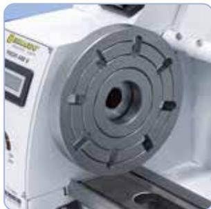
Zum Aufspannen von speziell geformten Werkstücken kann die Maschine mit einer 170 mm Aufspannscheibe ausgerüstet werden.
