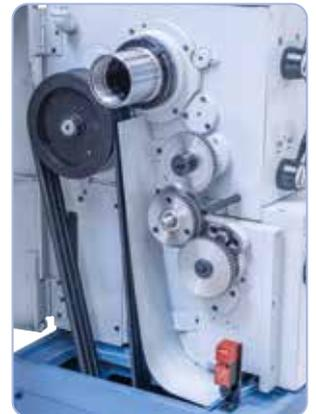
Gehärtete Hauptspindel mit Präzisionskegellager für hohe Rundlaufgenauigkeit, optimale Kraftübertragung durch verzahnte Optibelt-Keilriemen
