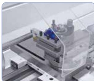
Der Schnellwechselstahlhalter Multifix ermöglicht eine Reduzierung der Nebenzeiten und gewährleistet eine hohe Wiederholgenauigkeit (Option).
