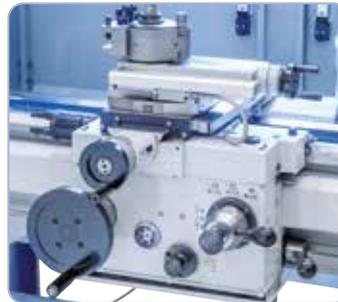
Leichtgängiger und präziser Schlitzen mit Obersupport und Schnellwechselstahlhalter, Handräder mit einstellbarer metrischer Feinskalierung
