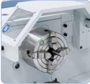
Planscheibe (Option) zum Spannen von unregelmäßig geformten Werkstücken
