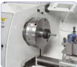
Das Spannzangenfutter ER 25 gewährleistet eine hohe Rundlaufgenauigkeit beim Spannen von Werkstücken, Spannbereich 1 - 16 mm.
