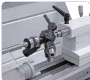
Zum wirtschaftlichen Arbeiten kann die Maschine mit einem Revolverkopf ausgestattet werden.
