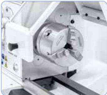
3-Backenfutter 100 mm mit Dreh- und Bohrbacken im Lieferumfang enthalten
