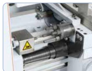
4 einstellbare Anschläge und Mikrometerlängsanschlag, ideal für Serienarbeiten
