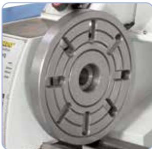
Zum Aufspannen von speziell geformten Werkstücken kann die Maschine mit einer 240 mm Aufspannscheibe ausgerüstet werden.
