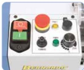
Die Spindeldrehzahl ist stufenlos einstellbar, serienmäßig mit Rechts-Linkslauf ausgestattet.
