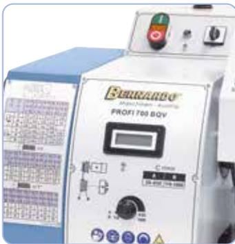
Elektronisch, stufenlose Drehzahlregelung, leichtes Ablesen mittels Digitalanzeige.
