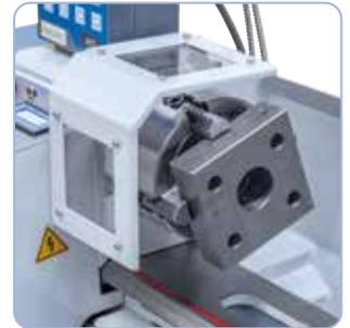
Planscheibe 100 mm (Option) zum Spannen von unregelmäßig geformten Werkstücken.
