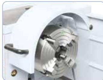
Planschibe 250 mm (Option) ideal zum Aufspannen von asymmetrischen Werkstücken.
