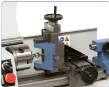
Vertikal-Frässupport mit montierter Kugeldreheinrichtung (Option)
