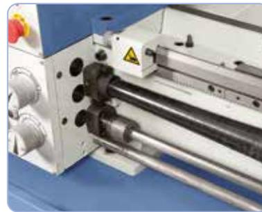
Mikrometerlängsanschlag und Rutschkupplung im Lieferumfang enthalten
