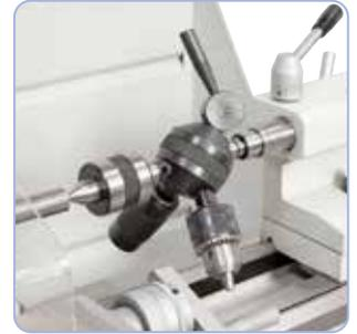
Zum wirtschaftlichen Arbeiten kann die Maschine mit einem Revolverkopf ausgestattet werden
