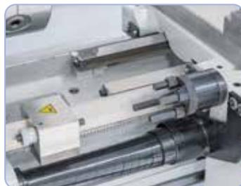
Mikrometerlängs- und Revolveranschlag im Lieferumfang enthalten.
