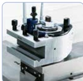
Zum rationellen Arbeiten kann die Maschine mit einem Schnellwechselstahlhalter ausgerüstet werden
