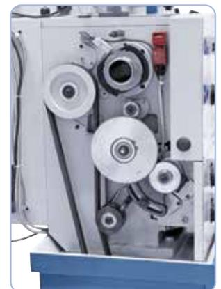
Serienmäßig ausgestattet mit Wechselrädern zum Gewindeschneiden.
