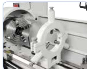
Feststehende Lünette zum Abstützen von langen und dünnen Werkstücken.
