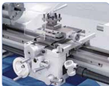
Ergonomisch angebrachter Schalthebel zur Einstellung des Längs- und Quervorschubes.
