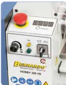
Elektronische, stufenlose Drehzahlregelung, leichtes Ablesen mittels Digitalanzeige.
