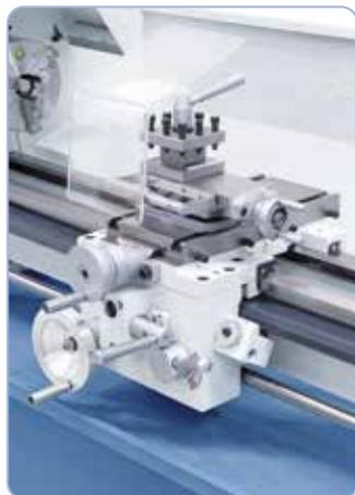
Für die Längs- und Querbewegung des Schlittens bzw. dem Ober-support stehen 6 frei wählbare Vorschübe zur Verfügung.
