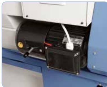
Leistungsstarker Antriebsmotor mit Magnetbremse nach CE-Norm
