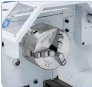
3-Backenfutter 125 mm mit Dreh- und Bohrbacken im Lieferumfang enthalten
