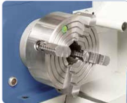
Planscheibe 200 mm (Standard), ideal zum Spannen von asymmetrischen Werkstücken
