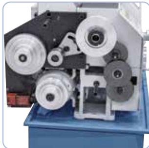
Wechselräder zum Gewindeschneiden im Lieferumfang enthalten.
