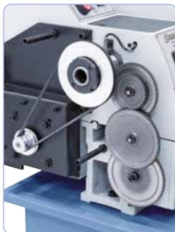
Gehärtete Hauptspindel, hohe Rundlaufgenauigkeit der Spindelnahe ( $\leq 0,009$  mm) aufgrund Präzisionskegellager.
