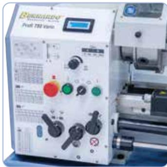
Elektronisch, stufenlose Drehzahlregelung,
