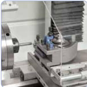
Zum rationellen Arbeiten kann die Maschine mit einem Schnellwechselhalter ausgerüstet werden.
