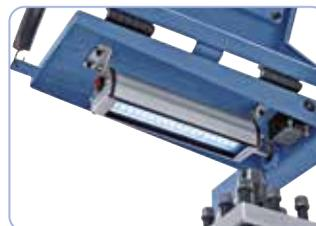
Integrierte LED-Maschinenlampe im Stahlhalterschutz für optimale Beleuchtung beim Arbeiten.
