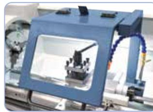
Integrierte LED-Maschinenlampe im Stahlhalterschutz für optimale Beleuchtung beim Arbeiten.
