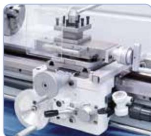
Ergonomisch angebrachte Schalthebel zur Einstellung des Längs- und Quervorschubes
