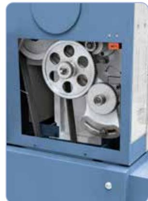
Lieferumfang komplett mit Wechselrädern zum Gewindeschneiden.
