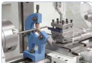
Feststehende Lünette mit Bronzeführung zum Stabilisieren von langen Werkstücken.
