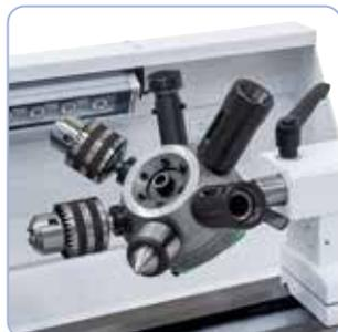
Zum wirtschaftlichen Arbeiten kann die Maschine mit einem Revolverkopf ausgestattet werden
