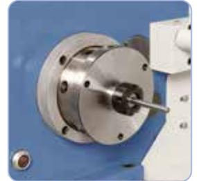
Das Spannzangenfutter ER 25 gewährleistet eine hohe Rundlaufgenauigkeit beim Spannen von Werkstücken, Spannungsbereich 1 - 16 mm
