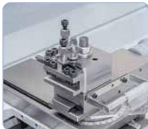
Zur Reduzierung der Nebenzeiten kann die Maschine mit einem Schnellwechselstahlhalter Bernardo Größe 20 ausgestattet werden.
