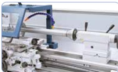
Zentrierkegel diam. 100 mm, ideal zum Spannen von Rohren und Hohlkörpern (Option).
