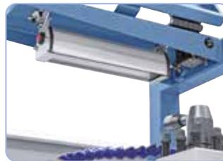
Integrierte LED-Maschinenlampe im Stahlhalterschutzhülse für optimale Beleuchtung beim Arbeiten.
