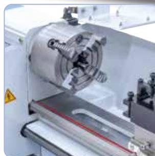
Planscheibe 100 mm (Option) zum Spannen von unregelmäßig geformten Werkstücken.
