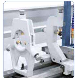
Zum Stabilisieren von langen Werkstücken serienmäßig mit einer feststehenden bzw. mitlaufenden Lünette ausgestattet.
