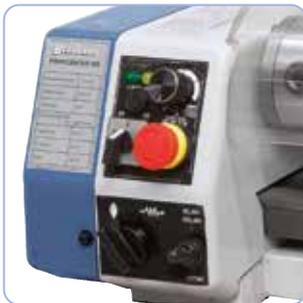
Schaltelemente (Drehzahlregelung, Wahlschalter, Vorschub, ...) am Spindelstock angebracht
