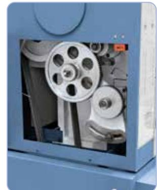
Lieferumfang komplett mit Wechselräder zum Gewindeschneiden.
