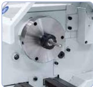
Das Spannzangenfutter ER 25 gewährleistet eine hohe Rundlaufgenauigkeit beim Spannen von Werkstücken, Spannungsbereich 1 - 16 mm.
