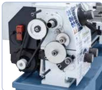
Serienmäßig ausgestattet mit Wechselrädern zum Gewindeschneiden.
