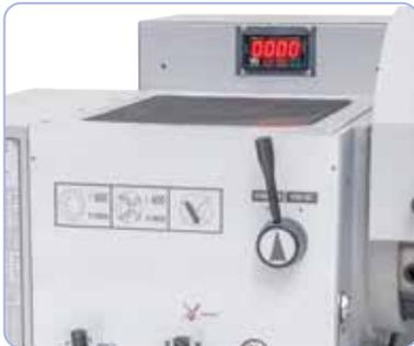
Elektronisch, stufenlose Drehzahlregelung, leichtes Ablesen mittels Digitalanzeige.
