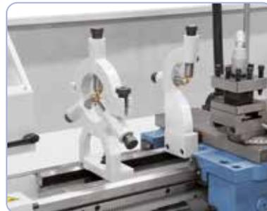
Zum Stabilisieren von langen Werkstücken serienmäßig mit einer feststehenden bzw. mitlaufenden Lünette ausgestattet.
