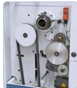
Lieferumfang komplett mit Wechselräder zum Gewindeschneiden.
