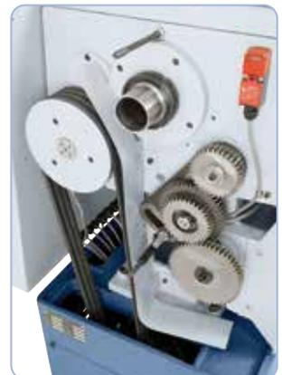
Serienmäßig ausgestattet mit Wechselrädern zum Gewindeschneiden.
