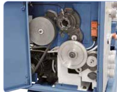
Gehärtete Hauptspindel, hohe Rundlaufgenauigkeit der Spindelnahe ( $\leq 0,009$  mm) aufgrund Präzisionskegellager.
