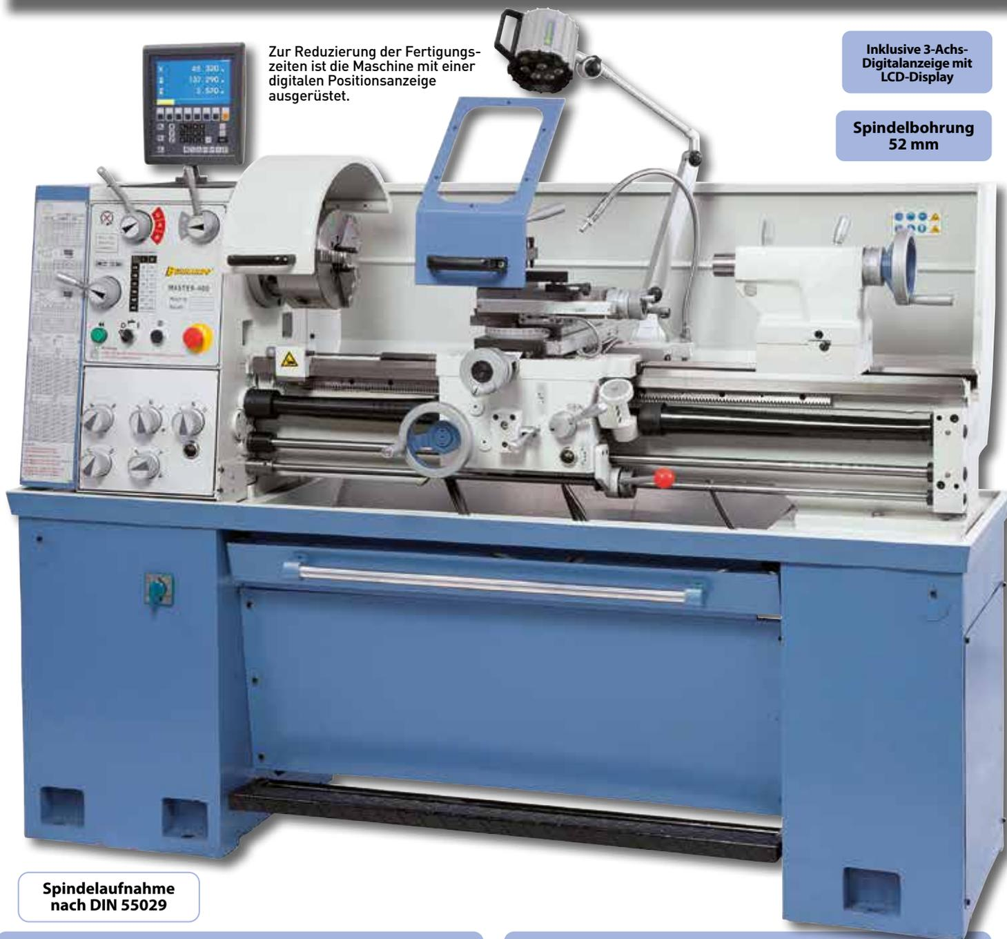
**Spindelaufnahme nach DIN 55029**
