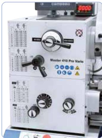
Leichtgängige Vorschub- und Drehzahlregelung am Getriebekopf, ruhiger Lauf durch gehärtete und geschliffene Zahnräder, im Ölbad laufend. Elektronisch, stufenlose Drehzahlregelung, leichtes Ablesen mittels Digitalanzeige.
