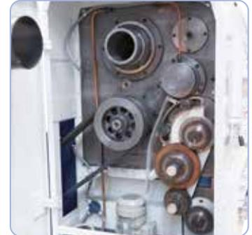
Die gehärtete Hauptspindel mit 130 mm Spindelbohrung lagert auf Kegelrollenlagern und Radialrollenlager.
