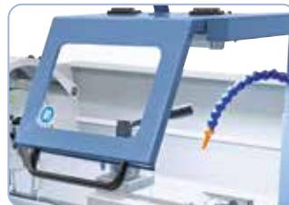
Integrierte LED-Maschinenlampe im Stahlhalterschut für optimale Beleuchtung beim Arbeiten.
