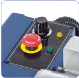
Stufenlose Drehzahlregelung der Hauptspindel mittels Potentiometer.
