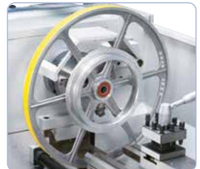
Herausnehmbare Brücke zum Bearbeiten von Werkstücken bis diam. 450 mm.
