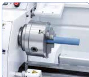
3-Backenfutter in Stahlausführung mit Dreh- und Bohrbacken im Lieferumfang enthalten
