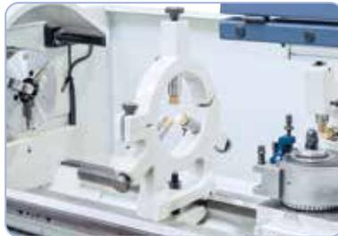
Feststehende Lünette zum Stabilisieren von langen Werkstücken
