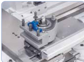
Zum rationellen Arbeiten ist die Maschine mit einem Schnellwechselstahlhalter ausgerüstet.
