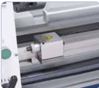
Mikrometerlängsanschlag und Rutschkupplung
