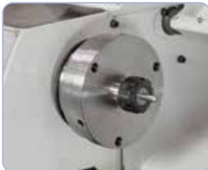
Das Spannzangenfutter ER 25 gewährleistet eine hohe Rundlaufgenauigkeit beim Spannen von Werkstücken, Spannbereich 1 - 16 mm.
