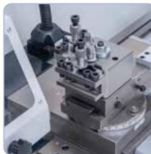
Zum rationalen Arbeiten kann die Maschine mit einem Schnellwechselstahlhalter ausgerüstet werden
