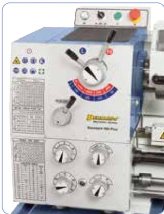
Leichtgängige Vorschub- und Drehzahlregelung am Getriebekopf, ruhiger Lauf durch gehärtete und geschliffene Zahnräder, im Ölbad laufend
