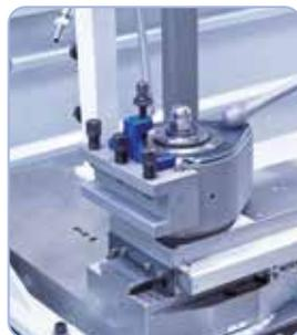
Zum rationellen Arbeiten ist die Maschine serienmäßig mit einem Schnellwechselstahlhalter ausgerüstet.
