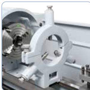
Feststehende Lünette zum Abstützen von langen und dünnen Werkstücken.
