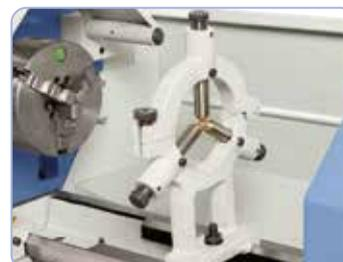
Feststehende Lünette mit Bronze-führung zum Stabilisieren von langen Werkstücken
