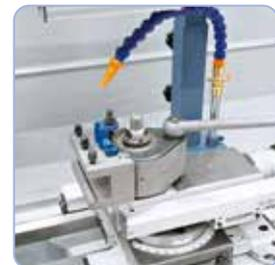
Zum rationalen Arbeiten kann die Maschine mit einem Schnellwechselstahlhalter ausgerüstet werden
