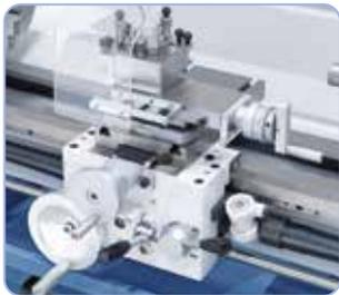
Leichtgängiger Schlitten mit Obersupport und Vierfachstahlhalter, Handräder mit einstellbarer metrischer Feinskalierung
