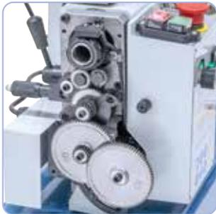
Serienmäßig ausgestattet mit Wechselrädern in Metallausführung zum Gewindeschneiden.
