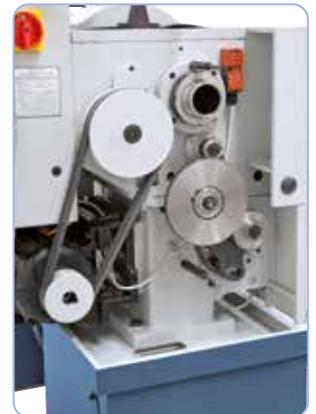
Serienmäßig ausgestattet mit Wechselrädern zum Gewindeschneiden.
