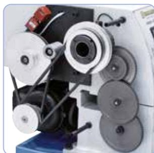
Einfaches Einstellen der Drehzahlstufe mittels Keilriemen
