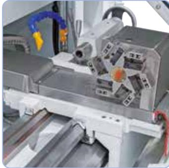
Automatischer 6-fach Werkzeugrevolver im Lieferumfang enthalten.
