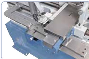
Kegeldreheinrichtung optional erhältlich, Drehlänge 300 mm, Einstellwinkel +/- 10°.
