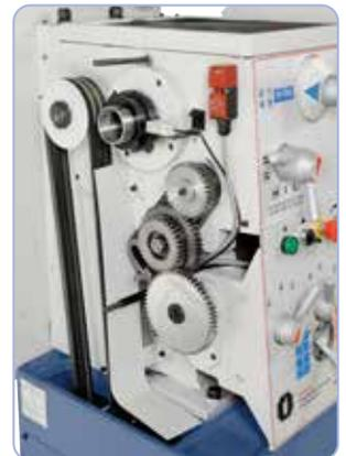
Serienmäßig ausgestattet mit Wechselräder zum Gewindeschneiden.
