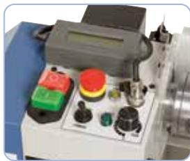
Zum exakten Einstellen der gewünschten Drehzahl kann die Maschine mit einer digitalen Drehzahlanzeige ausgestattet werden.
