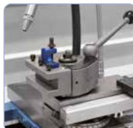
Zum rationellen Arbeiten ist die Maschine serienmäßig mit einem Schnellwechselstahlhalter ausgerüstet (Standard 165 V-Top).
