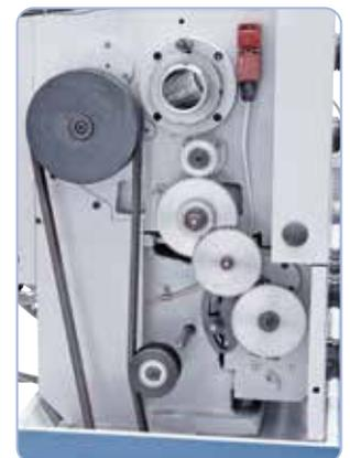
Serienmäßig ausgestattet mit Wechselrädern zum Gewindeschneiden.
