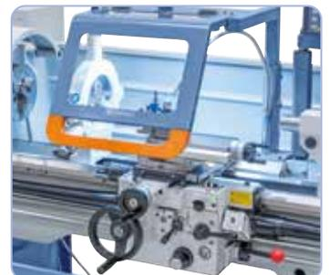
Für die Längs- und Querbewegung des Schlittens bzw. dem Ober-support stehen 17 frei wählbare Vorschübe zur Verfügung.
