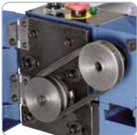
Nur ein Drehzahlbereich, kein Stufenwechsel notwendig.
