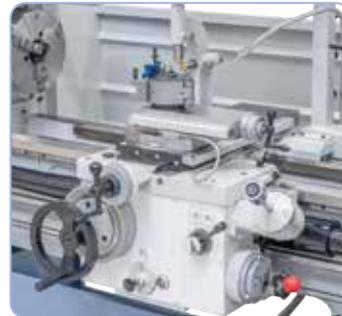
Für die Längs- und Querbewegung des Schlittens bzw. dem Obersupport stehen 4/2 frei wählbare Vorschübe zur Verfügung.
