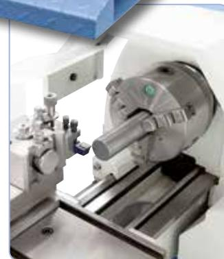
3-Backenfutter 125 mm mit Dreh- und Bohrbacken im Lieferumfang enthalten.
