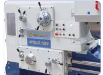
Übersichtlich angebrachte Schaltelemente am Getriebekopf, gehärtete und geschliffene Zahnräder sorgen für einen ruhigen Lauf.
