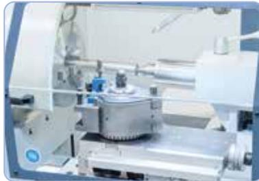
Zum rationellen Arbeiten ist die Maschine serienmäßig mit einem Schnellwechselstahlhalter ausgerüstet.
