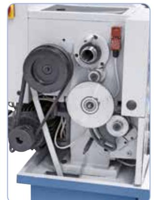
Serienmäßig ausgestattet mit Wechselrädern zum Gewindeschneiden.
