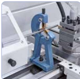
Feststehende Lünette mit Bronzeführung zum Stabilisieren von langen Werkstücken.
