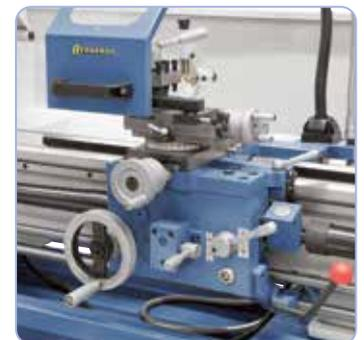
Leichtgängiger und präziser Schlitten mit Obersupport und Vierfachstahlhalter, Handräder mit einstellbarer metrischer Feinskalierung
