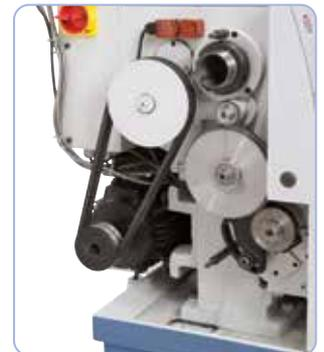
Lieferumfang komplett mit Wechselrädern zum Gewindeschneiden.
