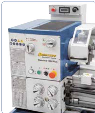
Einfache Bedienung, alle Schalt- und Bedienelemente übersichtlich am Getriebekopf angebracht. Vorschubgetriebe leicht und präzise schaltbar, im Ölbad laufend
