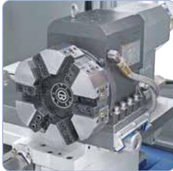
Robuster Werkzeugrevolver mit 6 Stationen.
