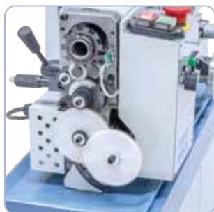
Wechselräder zum Gewindeschneiden im Lieferumfang enthalten.
