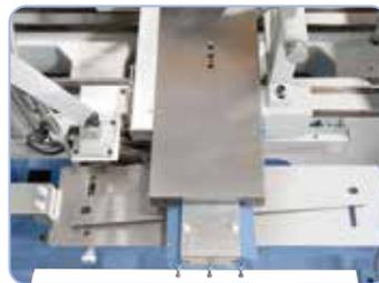
Kegeldreheinrichtung optional erhältlich, Drehlänge 455 mm, Einstellwinkel +/- 8°.
