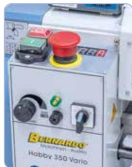
Elektronische, stufenlose Drehzahlregelung, leichtes Ablesen mittels Digitalanzeige.
