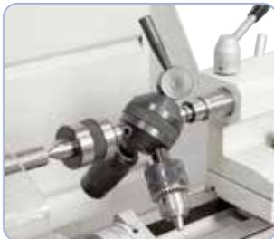
Zum wirtschaftlichen Arbeiten kann die Maschine mit einem Revolverkopf ausgestattet werden.
