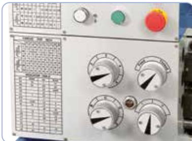
Vorschubgetriebe leicht und präzise schaltbar, im Ölbad laufend
