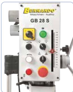
Übersichtlich angeordnete Schaltelemente, serienmäßig mit Gewindeschneideinrichtung.
