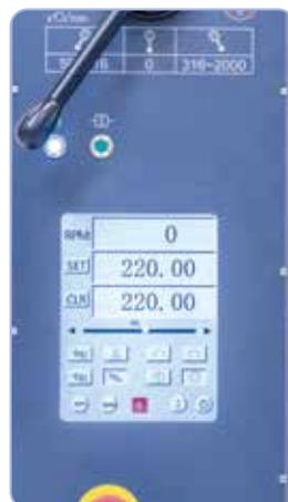
Großdimensionierter Touchscreen für sämtliche Einstellarbeiten wie z.B. Drehzahl, Bohren, Rechts- und Linkslauf, Höhenverstellung Bohrtisch, .....
