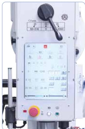
Großdimensionierter Touchscreen für sämtliche Einstellarbeiten wie z.B. Drehzahl, Bohren / Gewindeschneiden, Höhenverstellung Ausleger, ....
