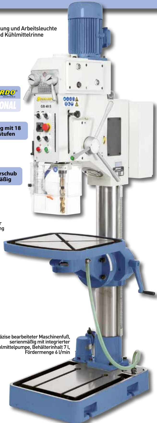
Präzise bearbeiteter Maschinenfuß, serienmäßig mit integrierter Kühlmittelpumpe, Behälterinhalt 7 l, Fördermenge 6 l/min
