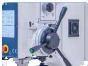
Für präzises Arbeiten ist die Maschine serienmäßig mit einem automatischem Spindelvorschub, sowie einer digitalen Bohrtiefenanzeige ausgestattet.
