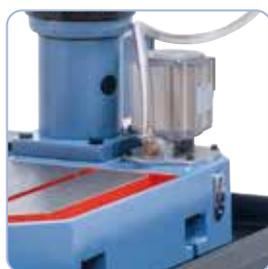
Handgeschabte Bodenplatte, serienmäßig mit integrierter Kühlmittelpumpe.
