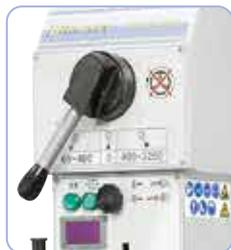
Einfache Vorwahl der Getriebestufe mittels Vorgelege, Einstellen der gewünschten Drehzahl mittels Potentiometer.
