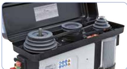
Gewichtete Grauguss-Antriebscheiben für hohe Laufruhe, die hochwertigen Keilriemen sorgen für eine optimale Kraftübertragung.
