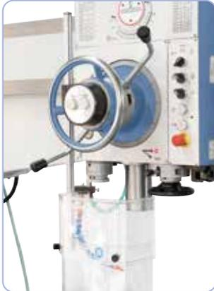
Präzisionsgelagerte Spindel für exakte Arbeitsergebnisse, Würfeltisch und Kühlmittel-einrichtung im Lieferumfang enthalten.
