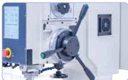
Der Bohrvorschub erfolgt wahlweise per Hand oder mittels Elektromagnetkupplung.
