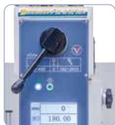
Einfache Vorwahl der Getriebestufe mittels Vorgelege, Einstellen der gewünschten Drehzahl am Bediendisplay.
