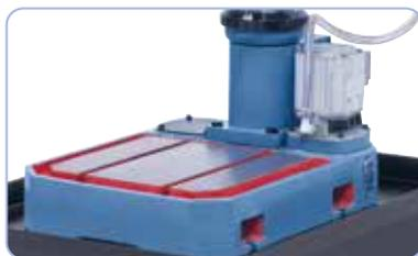
Massiver, großdimensionierter Arbeitstisch mit T-Nuten. Abbildung GB 30 T mit Kühlmittleinrichtung.
