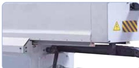
Die hochwertige Linearführung gewährleistet ein leichtgängiges Verfahren des Bohrkopfes.
