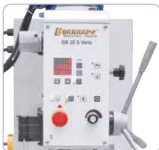
Einfache Vorwahl der Getriebestufe mittels Vorgelege, Einstellen der gewünschten Drehzahl mittels Potentiometer.
