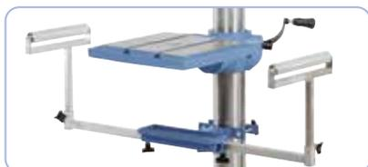
Zum Auflegen von langen Werkstücken kann die Maschine mit einem ausziehbaren Bohrsupport ausgestattet werden.
