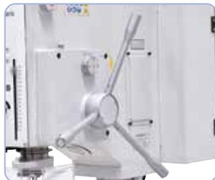
Der Bohrvorschub erfolgt wahlweise per Hand oder mittels Elektromagnetkupplung
