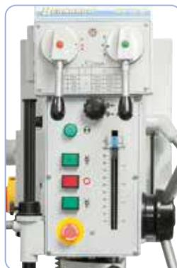
Übersichtlich angebrachte Schalt- und Bedienelemente an der Vorderseite der Maschine.
