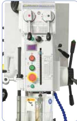
Schnelle und einfache Einstellung der Drehzahl mittels Getriebebeschaltung an der Vorderseite. Die Drehzahl wird an der Digitalanzeige abgelesen.
