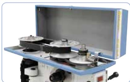
Die Geschwindigkeitsübertragung vom Motor zur Pinole erfolgt über einen soliden Variatorantrieb.
