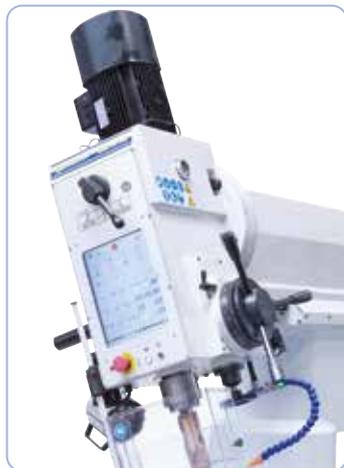
Erweiterter Einsatzbereich durch den von  $-90^\circ$  bis  $+90^\circ$  schwenkbaren Bohrkopf
