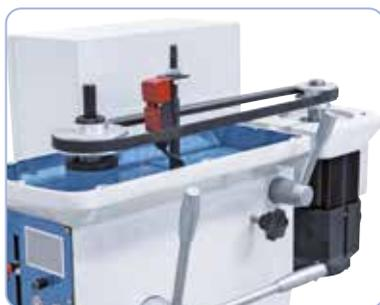
Gewichtete Grauguss-Antriebsscheiben für hohe Laufruhe, die hochwertigen Keilriemen sorgen für eine optimale Kraftübertragung.
