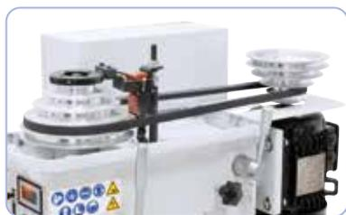
Gewichtete Grauguss-Antriebsscheiben für hohe Laufruhe, die hochwertigen Keilriemen sorgen für eine optimale Kraftübertragung.
