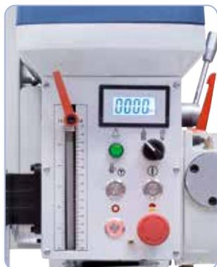
Serienmäßig mit digitaler Drehzahlanzeige ausgestattet. Ergonomisch angebrachte Schalt- und Bedienelemente an der Vorderseite.
