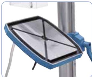
Der großzügig dimensionierte Bohrtisch ist von  $-45^\circ$  bis  $+45^\circ$  schwenkbar.
