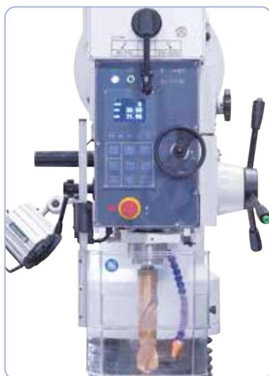
Bedienerfreundliches Arbeiten durch zentral angeordnete Schalt- und Bedienelemente.
