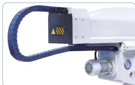
Motor für Hydraulikanlage und Energieführungskette an der Rückseite der Maschine.
