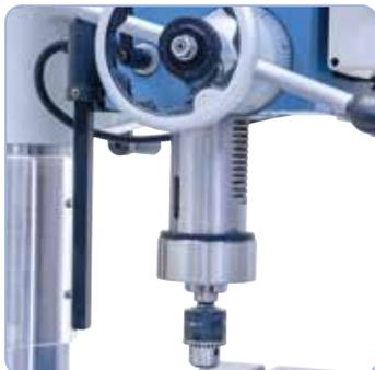
Großdimensionierte Pinole mit 140 mm Hub.
