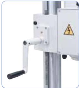
Einfache Höhenverstellung des Bohrkopfes mittels Kurbel.
