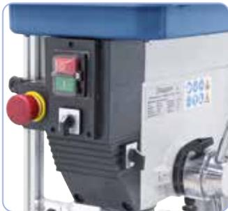
Not-Halt-Taster, Drehrichtungsschalter und 2-Stufenschalter an der Vorderseite der Maschine.
