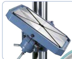
Massiver, bearbeiteter Graugussstisch mit T-Nuten und Kühlmittelrinne.
