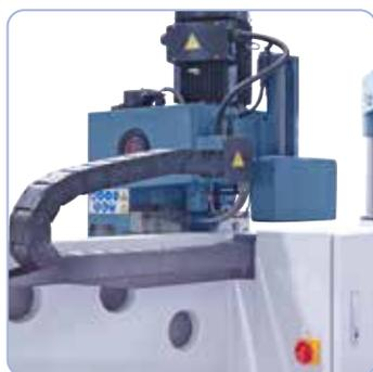
Gegengewicht für die Pinole und Energieführungskette an der Rückseite des Bohrkopfes.
