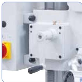
Einfache Höhenverstellung des Bohrkopfes mittels Kurbel.
