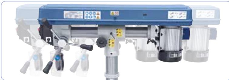
Die Ausladung des Bohrkopfes kann stufenlos verstellt werden.
