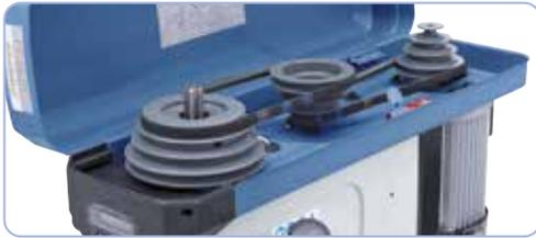
Hochwertige Keilriemen sorgen für eine optimale Kraftübertragung
