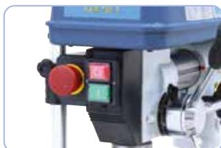
EIN-AUS Schalter nach IP 54 und separater Not-Halt-Taster
