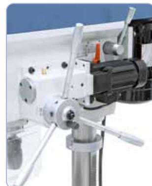
Stufenlos einstellbarer Pinolenvorschub mit separatem Antriebsmotor.
