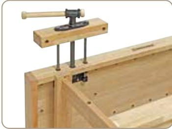
Französische Vorderzange mit Trapezgewindespindel und Parallelstabführung
