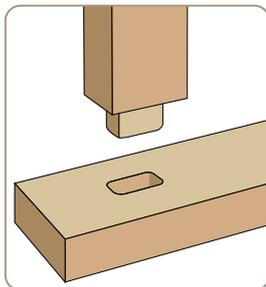
Hohe Standfestigkeit durch die Zapfen-Schlitz-Verbindung im Fußgestell
