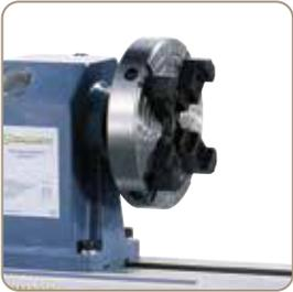
Zum Aufspannen von asymmetrischen Werkstücken kann die Maschine mit einer 4-Backen-Planscheibe ausgestattet werden.
