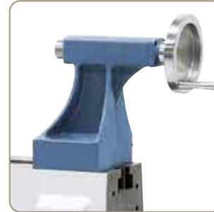
Pinole mit Durchgangsbohrung, ideal zum Herstellen z.B. von Kabelkanaelen in Lampensockeln.
