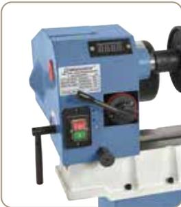
Für ein optimales Einstellen der gewünschten Drehzahl ist die Maschine mit einer digitalen Drehzahlanzeige ausgestattet.
