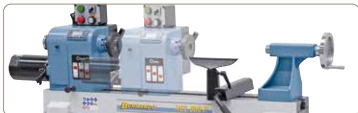
Der Spindelkasten kann in Längsrichtung beliebig verschoben und arretiert werden.
