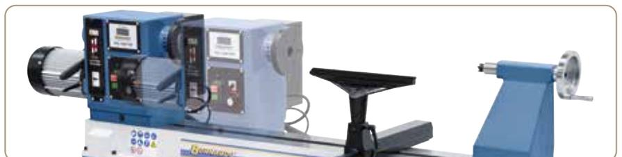
Der Spindelkasten kann in Längsrichtung beliebig verschoben und arretiert werden.
