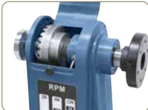
Einfaches Wechseln der Übersetzungsstufe durch Umlagen des Keitriemens.
