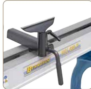
Einfache Fixierung der Handauflage mittels Schnellspannhebel.
