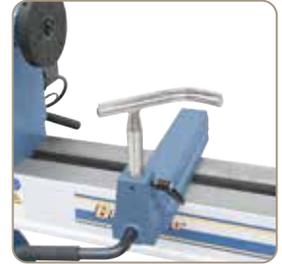
Durch das optional erhältliche Handauflagenset können verschiedenste Bearbeitungsvorgänge schnell und einfach durchgeführt werden.
