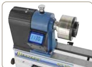
Einfaches Ablesen der Drehzahl mittels LED-Anzeige
