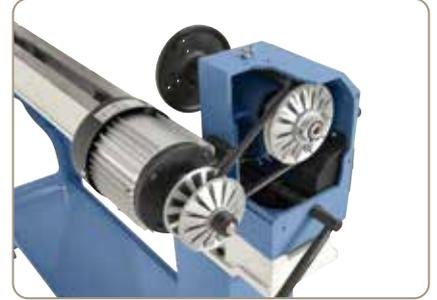
Die Geschwindigkeitsübertragung vom Motor zur Pinole erfolgt über einen soliden Variatorantrieb.
