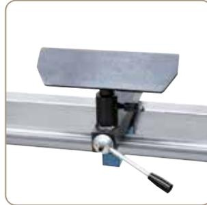
Einfache Fixierung der Handauflage mittels Schnellspannhebel.
