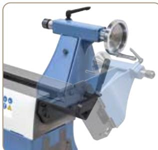
Bei Verwendung der optionalen Aussendrehvorrichtung wird der Reitstock einfach weggeschwenkt.
