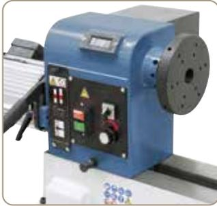
Für ein optimales Einstellen der gewünschten Drehzahl ist die Maschine mit einer digitalen Drehzahlanzeige ausgestattet.
