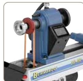
Die Kraftübertragung auf die Pinole erfolgt über einen robusten Riemenantrieb
