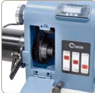
Die Kraftübertragung auf die Spindel erfolgt über einen robusten Riemenantrieb.
