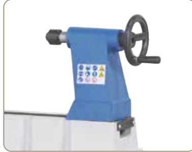
Pinole mit Durchgangsbohrung, ideal zum Herstellen z.B. von Kabelkanälen in Lampensockeln.
