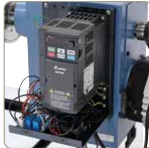
Der hochwertige Frequenzumrichter ermöglicht eine stufenlose Einstellung der Spindeldrehzahl.
