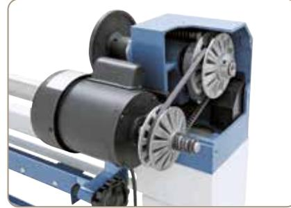
Der massive Variatorantrieb gewährleistet eine optimale Kraftübertragung
