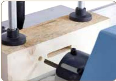
Das Westcott-Bohrfutter kann für Langlochbohrer mit Schaft max. 20 mm verwendet werden
