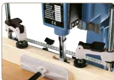
Exzentranspanner und Schnellspan-Schraubstock zur sicheren Fixierung des Werkstückes
