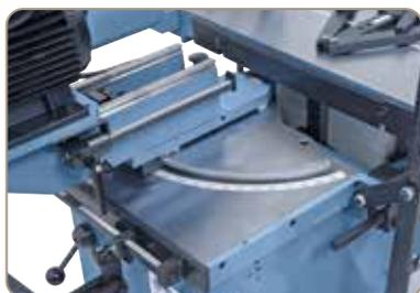
Bohraggregat rechts und links 60° schwenkbar
