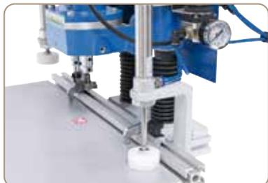
Optimale Werkstückfixierung durch die pneumatischen Niederhalter (BBM 35 P)
