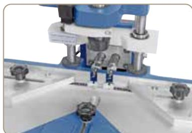
Gleichzeitige Herstellung von zwei Keilnuten mit fixem Spindelabstand von 28 mm
