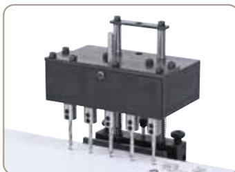
Dieser Reihenbohrkopf ist mit fünf Spindeln ausgestattet, zum Ausführen einer Serie von fünf Löchern gleichzeitig mit einem Achsabstand von 32 mm. Diese Ausrüstung wird beim Bohren von Möbelseitenteilen als auch zur Befestigung der Scharnierbasis verwendet.
