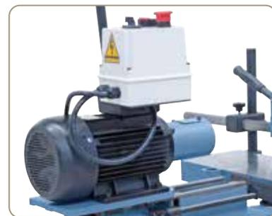
Leistungsstarker 2-Stufen-Antriebsmotor für optimale Bohrleistung
