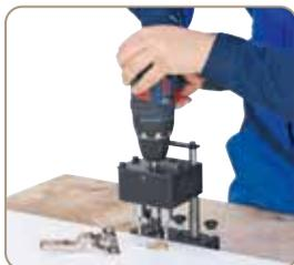
Die Bohrmaske für Scharniere Typ Blum bzw. Typ Grass hat drei Spindeln und ist dazu geeignet, die drei Löcher für die Befestigung von Scharnieren gleichzeitig auszuführen.
