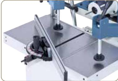
Für Winkelbohrungen ist ein beidseitig schwenkbarer (-60° bis +60°) Gehrungsanschlag im Lieferumfang enthalten
