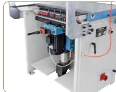
Pneumatisches Schwenken der Bohreinheit von 0° - 45° - 90°
