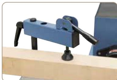
Der serienmäßige Exzentranspanner ermöglicht ein sicheres Fixieren des Werkstückes.
