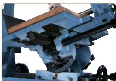
Erweiterter Einsatzbereich durch den vor- und zurück schwenkbaren Arbeitstisch
