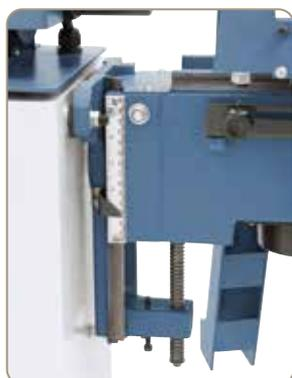
Die eingestellte Arbeitshöhe des Bohrtisches wird mittels Skala abgelesen.
