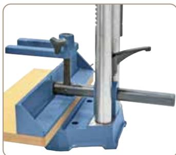
Wiederholgenaues Stemmen durch verstellbaren Werkstückanschlag
