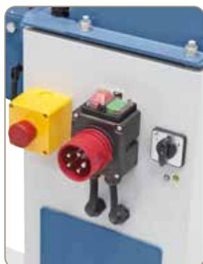
Not-Aus- und Drehrichtungsschalter seitlich am Maschinenkörper
