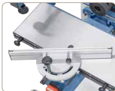
Verstellbarer Gehrungsanschlag, 2 x 60° schwenkbar.
