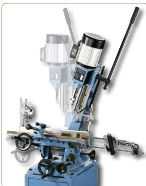
Spindelkopf rechts und links je 22,5° schwenkbar
