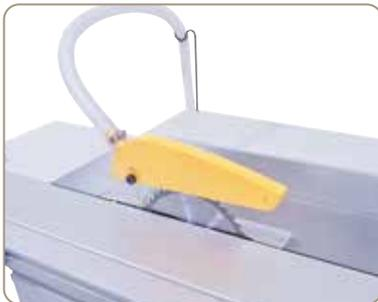
Der Sägeblattschutz mit integriertem Absaugstutzen ist am Spaltkeil befestigt.
