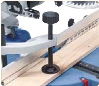
Serienmäßig mit höhenverstellbarem Niederhalter zur Fixierung des Werkstückes.
