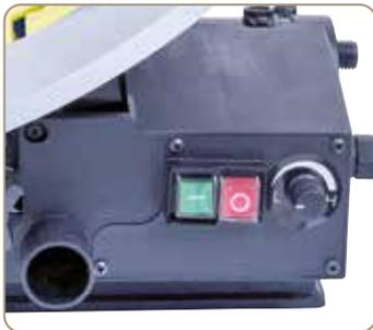
Die Hubzahl wird mittels Potentiometer stufenlos eingestellt.
