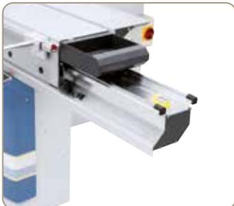
Leichtgängiger und präziser Lauf durch das bewährte Doppelrollenwagen-Führungssystem.
