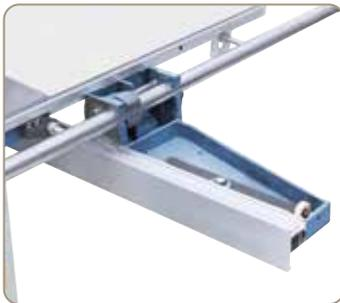
Zum Schneiden von großen Teilen wird der Parallelanschlag einfach abgeschwenkt.
