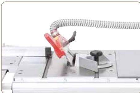
Leichtere Schnittführung des Werkstückes durch das nach links schwenkbare Sägeblatt.
