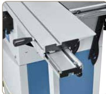
Gehärtete Prismenführung für einen leichtgängigen Lauf des Formattisches.
