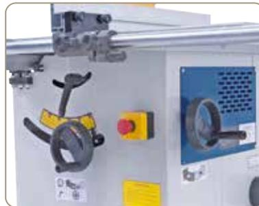
Die Höhenverstellung bzw. Schwenkung des Sägeaggregates erfolgt mittels ergonomisch angebrachten Handrädern.
