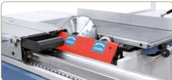
Stabiles Sägeaggregat mit beidseitig geführten Schwenkelementen aus Grauguss.
