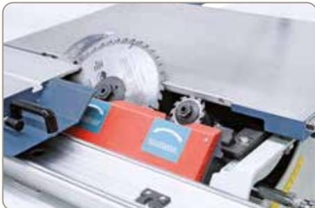
Stabiles Sägeaggregat mit beidseitig geführten Schwenkelementen aus Grauguss.
