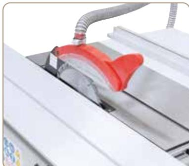
Der Sägeblattschutz mit integriertem Absaugstutzen ist am Spaltkeil befestigt.
