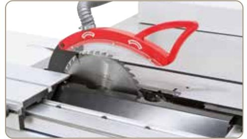
Der Sägeblattschutz mit integriertem Absaugstutzen ist am Spaltkeil befestigt. Serienmäßig mit Vorritzaggregat ausgestattet.
