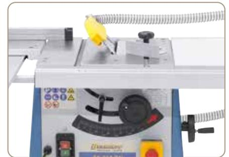
Nach links schwenkbares Sägeblatt für verbessertes Handling bei Schrägschnitten.
