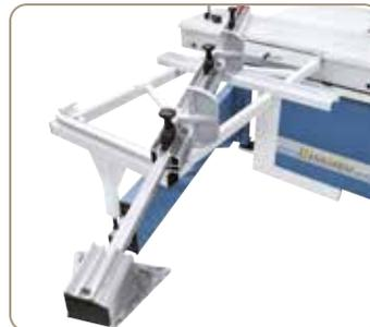
Der über die gesamte Schlittenlänge verschiebbare, massive Auslegertisch kann in jeder Position abgenommen werden. Der ausziehbare Teleskopanschlag mit 2 massiven Klappanschlägen ist millimetergenau einstellbar.
