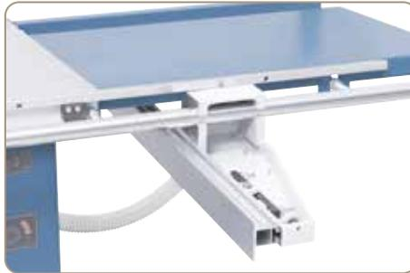
Zum Schneiden von großen Teilen wird der Parallelanschlag einfach abgeschwenkt.
