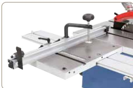
Durch den optionalen Rolltisch mit Aluminiumanschlag und Exzenterspanner wird der Einsatzbereich zusätzlich erhöht.
