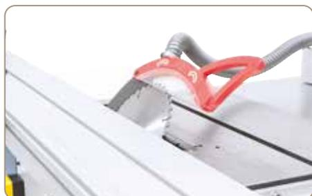
Das bis 45° schwenkbare Sägeaggregat kann mittels Handrad für Schnitthöhen bis 100 mm eingestellt werden.
