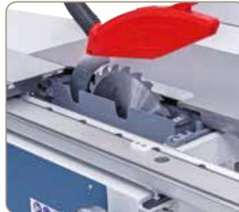
Stabiles Sägeaggregat mit beidseitig geführten Schwenkelementen aus Grauguß.
