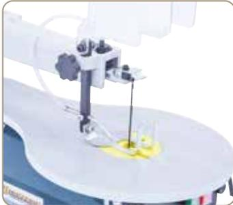
Die serienmäßige Ausblasvorrichtung entfernt den Sägestaub, dadurch optimale Sicht auf die Schnittlinie.
