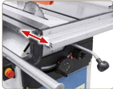
Zugkreisschneiden zum leichteren Bearbeiten von langen Werkstücken.
