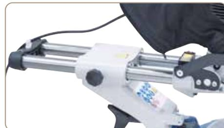
Hohe Stabilität durch Doppelsäulenführung des Sägeaggregates.
