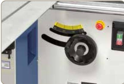
Schnelle und einfache Höhenverstellung des Sägeblattes mittels ergonomisch angebrachtem Handrad
