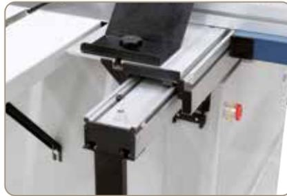
Der großzügig dimensionierte Formattisch läuft leichtgängig und absolut verschleißfrei auf einer gehärteten Prismenführung.
