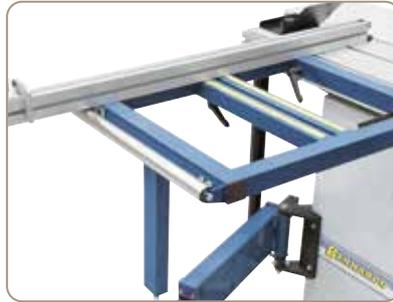
Auslegertisch mit Rolle für vereinfachtes Handling bei größeren Werkstücken.
