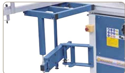
Der leichtgängige Auslegertisch ist zusätzlich mit einem Schwenkarm ausgestattet, wodurch das Bearbeiten von großen Platten ermöglicht wird.
