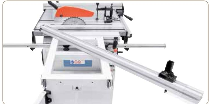
Der stufenlos schwenkbare (2 x 45°) Teleskopanschlag kann wahlweise vorne oder hinten am Auslegertisch montiert werden.
