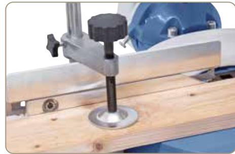
Sicheres Fixieren des Werkstückes mittels höhenverstellbarem Niederhalter.
