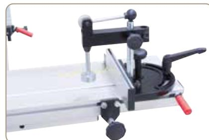
Gehrungsanschlag mit Anschlaglineal und Exzenterstapler über die gesamte Tischlänge verschiebbar.
