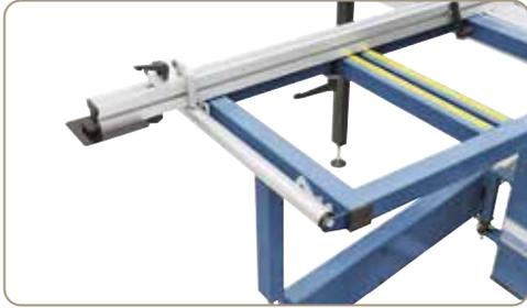
Auslegertisch mit Rolle für vereinfachtes Handling bei größeren Werkstücken.
