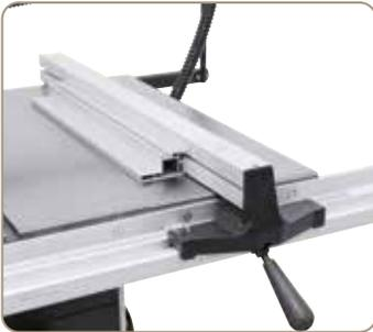
Inklusive leicht verschiebbarem Längsanschlag mit Schnellklemmsystem und Tischverbreiterung für Schnittbreiten bis 730 mm.
