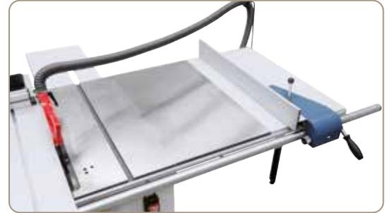
Großdimensionierter Arbeitstisch und serienmäßige Tischverbreiterung für Schnittbreiten bis 1200 mm.
