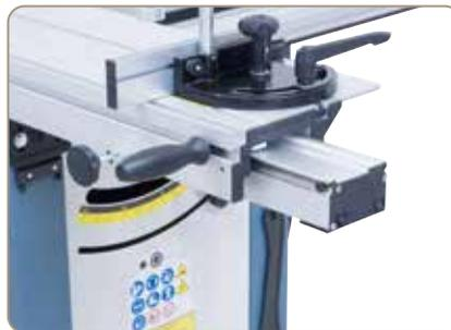
Der großzügig dimensionierte Formattisch läuft leichtgängig auf einer gehärteten Prismenführung.
