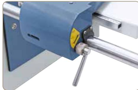
Der mit einer mikrometrischen Feineinstellung ausgerüstete Parallelanschlag kann für Schnittbreiten bis 1295 mm verwendet werden.
