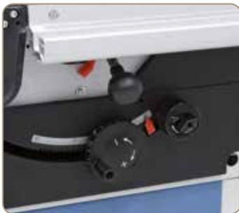
Problemlose und leichtgängige Schwenkung des Sägeblattes mittels Handrad über eine Zahnkranzführung.
