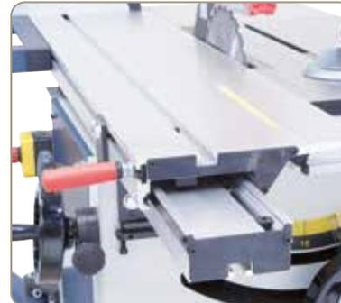
Der großzügig dimensionierte Formattisch läuft leichtgängig auf einer gehärteten Prismenführung.
