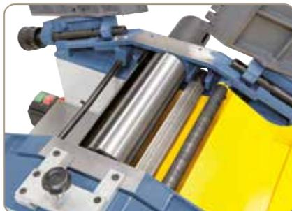
Hobelwerk bestehend aus: 3-Messerwelle, geriffelte Einzugswalze, gummierte Auszugswalze.
