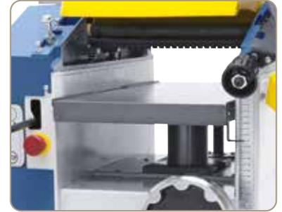
Dickentisch aus Grauguss mit mittlerer Zentralsäule und Abstützung, für Werkstücke bis 180 mm Höhe.
