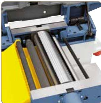
Das Hobelwerk besteht aus einer dynamisch ausgewuchteten 4-Messerwelle, einer Ein- und Auszugswalze, sowie massiven Rückschlagsicherungen.
