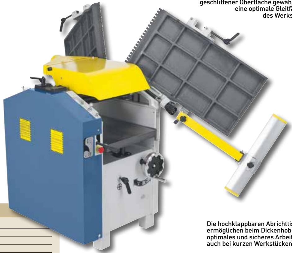
Die hochklappbaren Abrichttische ermöglichen beim Dickenhobeln ein optimales und sicheres Arbeiten, auch bei kurzen Werkstücken.
