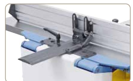
Der Abrichtanschlag wird über eine präzise Prismenführung auf die gewünschte Position eingestellt.
