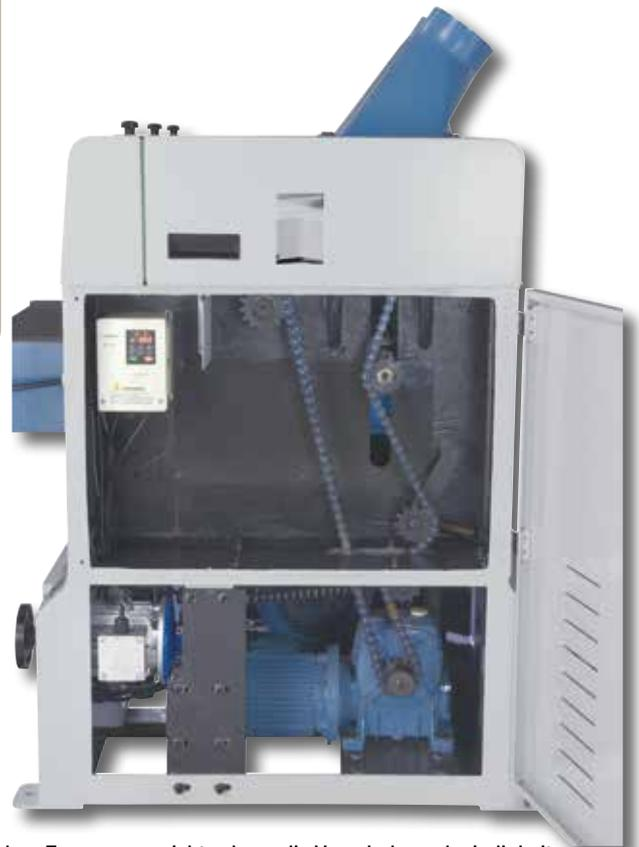
Mit dem Frequenzumrichter kann die Vorschubgeschwindigkeit der Ein- und Auszugswalze für präzise Hobelergebnisse optimal an das Werkstück angepasst werden
