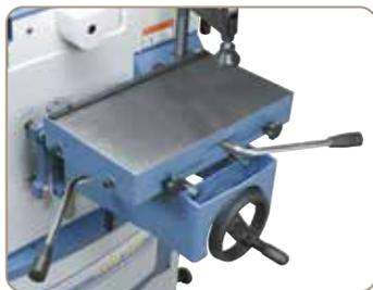
Die Langlochbohrereinrichtung ist ideal für Langlöcher, Dübel- und Schräglochbohrungen (optional), ...
