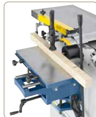
Die Langlochbohrereinrichtung ist ideal für Langlöcher, Dübel- und Schräglochbohrungen, ...
