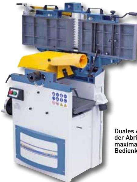
Duales Aufklappen der Abrichttische für maximalen Bedienkomfort.
