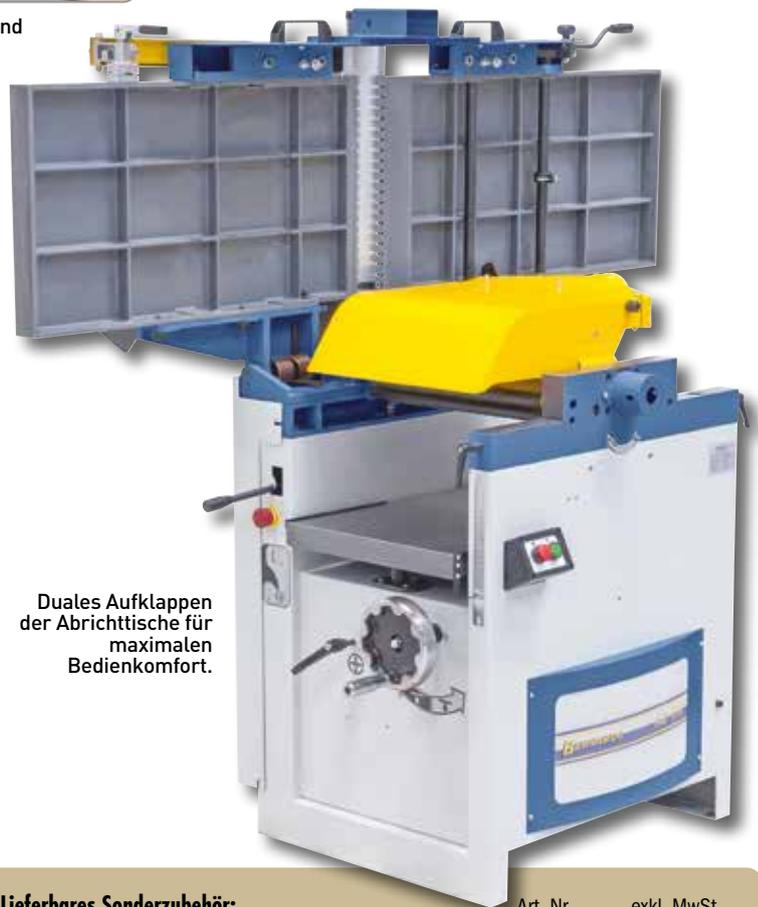
Duales Aufklappen der Abrichttische für maximalen Bedienkomfort.
