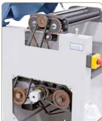
Der Vorschub des Werkstückes erfolgt über einen stabilen Kettenantrieb. Die Vorschubgeschwindigkeit beträgt 5 - 7 m/min.
