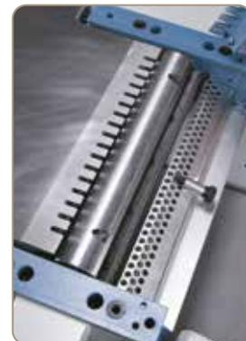
Die Tischclippen in Kombination mit dem gelochten Späneleitblech ergeben eine geringe Lärmbelastung.
