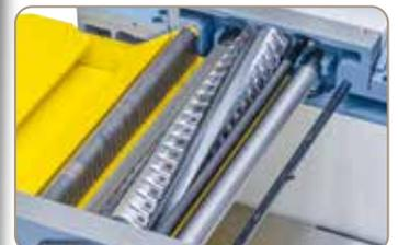
Die stabile Hobeinheit mit der präzisionsgelagerten Spiralmesser-Hobelwelle gewährleistet beste Hobelergebnisse.
