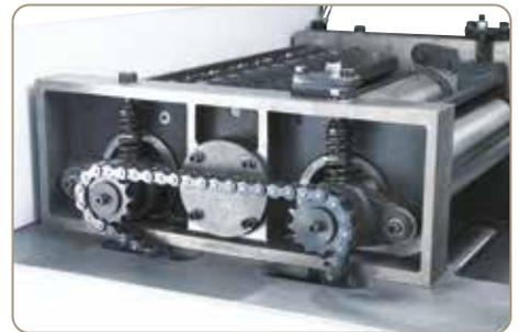
Der Kettenantrieb sorgt für einen gleichmäßigen Antrieb der Ein- und Auszugswalzen.
