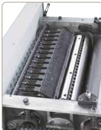
Segmentierte Einzugswalze und Druckbalken ermöglichen das gleichzeitige Hobeln von Werkstücken unterschiedlicher Dicke.
