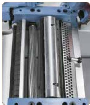
Durch die präzisionsgelagerte 4-Messerwelle und der spiralverzahnten Einzugswalze werden beste Hobelergebnisse erzielt.
