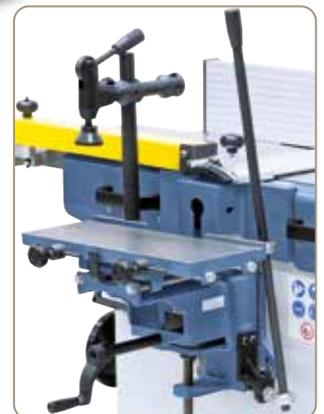
Die Langlochbohrereinrichtung ist ideal für Langlöcher, Dübel- und Schräglochbohrungen, ...
