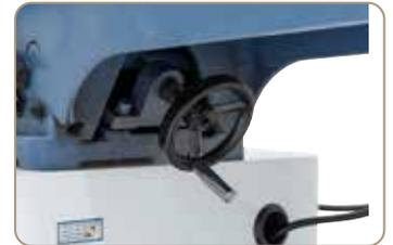
Leichte Einstellung der Spanabnahme mittels Handrad
