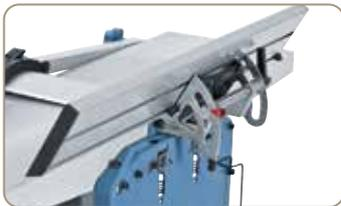
Aluminium-Abrichtanschlag, verwendbar von 90° bis 45°.
