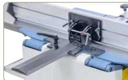
Der Abrichtanschlag wird über eine präzise Prismenführung auf die gewünschte Position eingestellt.
