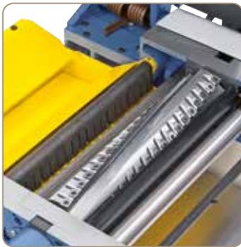
Das Hobelwerk besteht aus einer dynamisch ausgewuchteten Spiralmesser-Hobelwelle, einer Ein- und Auszugswalze, sowie massiven Rückschlagsicherungen.
