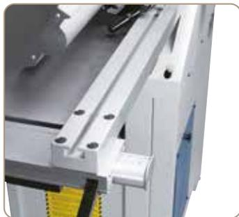
Sehr platzsparende Konstruktion durch den seitlich geführten Abrichtanschlag.
