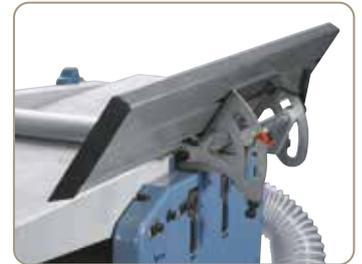
Die Schwenkung des Abrichtanschlages erfolgt schnell und einfach an der Rückseite. Die gewünschte Gradeinstellung kann an der Skala abgelesen werden.
