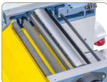
Die stabile Hobeinheit mit der präzisionsgelagerten 3-Messerwelle gewährleistet beste Hobelergebnisse.
