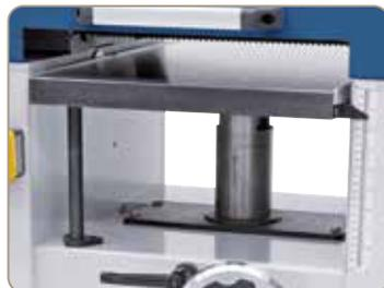
Der verwindungsfreie Dickentisch ist mit einer mittigen Säule geführt und zusätzlich abgestützt.
