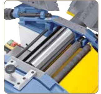
Die dynamisch ausgewuchtete 3-Messerwelle garantiert durch den vibrationsfreien und ruhigen Lauf beste Hobelergebnisse.
