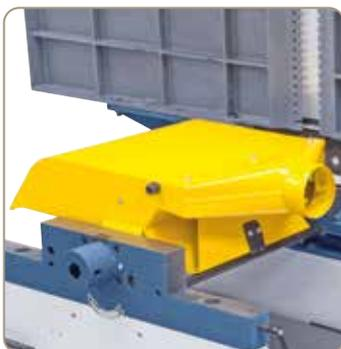
Integrierte umklappbare Spanauswurfschaube – Anschlussdurchmesser 100 mm.
