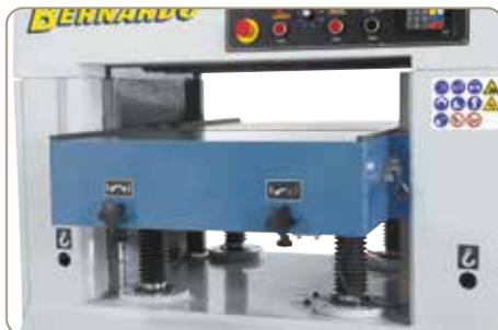
Massiver Dickentisch aus Grauguss, motorisch einstellbar von 4 - 300 mm Arbeitshöhe. Die Höhenverstellung erfolgt über 4 großdimensionierte Spindeln, die Führung mit vier Präzisionsflachführungen ist für höchste Beanspruchung ausgelegt.
