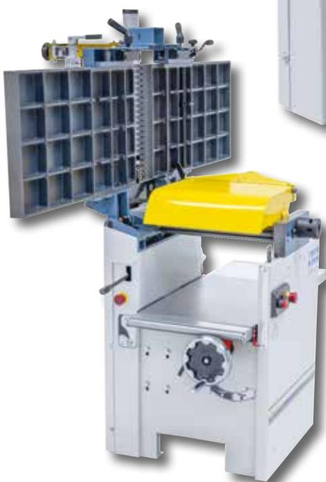
Durch die langen Abricht- bzw. den Dickenhobeltisch aus stark verripptem Grauguss wird eine präzise Bearbeitung bei langen Werkstücken ermöglicht.
