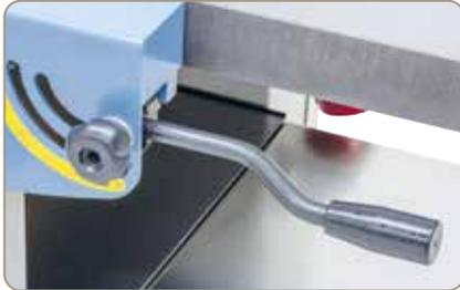
Schnelle und einfache Einstellung der Spanabnahme bis max. 3,5 mm.
