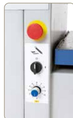
Stufenlos einstellbare Vorschubgeschwindigkeit, optimal für verschiedene Werkstücke (ADM 300 V).
