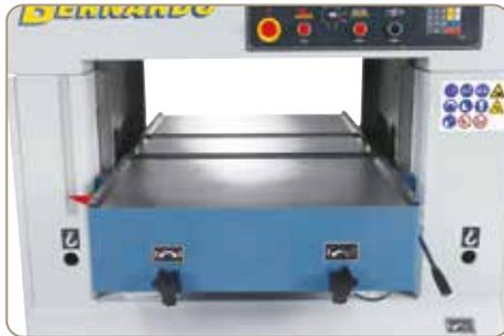
Für einen gleichmäßigen Vorschub des Werkstückes ist der Dickentisch mit zwei feineinstellbaren Walzen ausgestattet.
