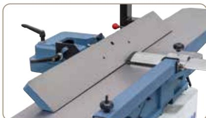
Der massive, bis 45° schrägstellbare Abrichtanschlag ist leicht verstellbar.
