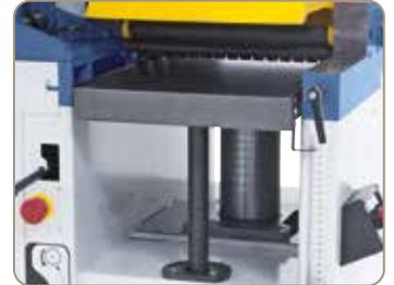
Stabiler Dickenanschub mit Pinolenführung und Abstützung für exaktes Hobeln von Bretter, Leisten, Bohlen, ...
