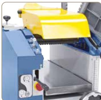
Stabiler Dickentisch aus Grauguss mit mittiger Zentralführung und Klemmung, zum Hobeln von Werkstücken bis 190 mm Höhe.
