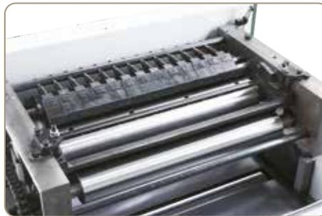
Massives Hobelaggregat mit der 120 mm starken präzisionsgelagerten 4-Messerwelle garantiert auch bei hoher Belastung ein präzises Hobelbild.
