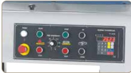
Übersichtlich angeordnete Schalt- und Bedienelemente, die Ablesung der Dicktischeinstellung erfolgt über die Digitalanzeige.
