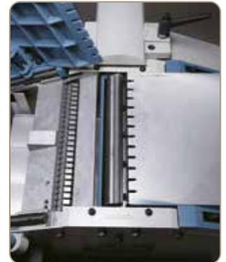
Durch die präzisionsgelagerte Messerwelle und der geriffelten Einzugswalze werden beste Hobelergebnisse erzielt.
