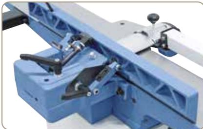
Robuste Schwenkeinrichtung des Abrichtanschlages mit justierbaren Endanschlägen
