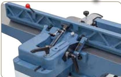
Robuste Schwenkeinrichtung des Abrichtanschlages mit justierbaren Endanschläge.
