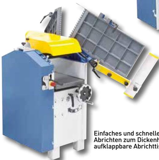
Einfaches und schnelles Umrüsten vom Abrichten zum Dickenhobeln durch aufklappbare Abrichttische.
