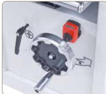
Die Einstellung der Dickentischhöhe erfolgt mittels digitaler Anzeige auf 1/10 mm genau.
