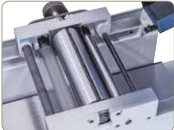
Durch die präzisionsgelagerte 4-Messerwelle und der gerade verzahnten Einzugswalze werden die besten Hobelergebnisse erzielt.
