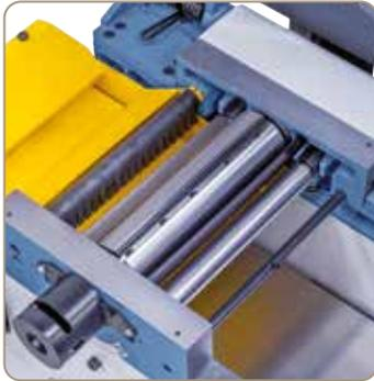
Das Hobelwerk besteht aus einer dynamisch ausgewuchteten 3-Messerwelle, einer Ein- und Auszugswalze, sowie massiven Rückschlagsicherungen.
