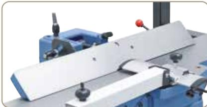
Der massive, bis 45° schrägstellbare Abrichtanschlag ist leicht verstellbar.
