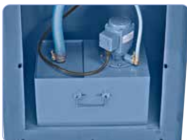
Effektiv kølevæskeanordning integreret pladsbesparende i understellet
