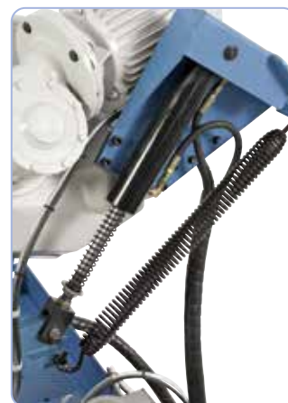
Som standard med hydraulikcylinder til fintfølede sænkning af savrammen.
