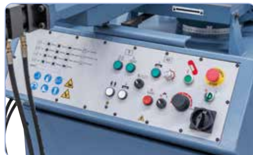
Drejekontakt til trinløs skærehastighed og kontrolventil til kontaktryk på det ergonomisk monterede betjeningspanel
