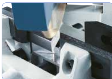
Svingbart gearhoved (45° til venstre / højre), optimal til geringssnit.
