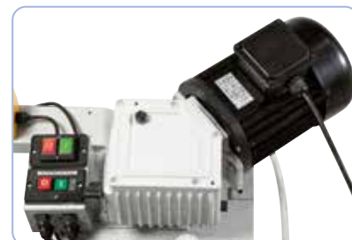
Gear med hærdet og slebet snækkeaksel, snækkehjulet er af bronze
