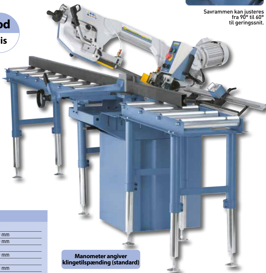
Standardmanometeret muliggør optimal justering af klingetilspændingen.
