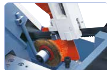
Klingestyr på kuglelejer og spånbørste til optimale skæresultater.
