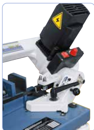
Effektiv drivmotor med elektrisk hastighedsregulator
