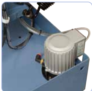
Med en kraftig kølevæskes-pumpe som standard.
