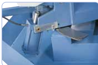
Den hydrauliske cylinder spænder savrammen på den indstillede skærevinkel.
