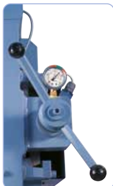
Det standardmæssige manometer muliggør præcis justering af klingens tilspænding.
