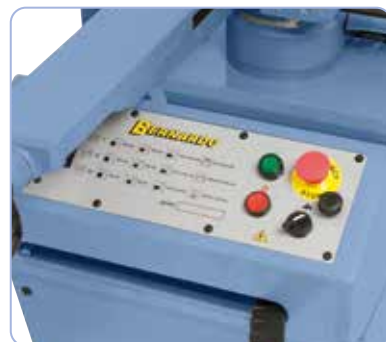
Den overskueligt opbyggede kontaktboks foran på maskinen gør arbejdet behageligt.
