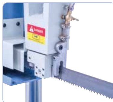
Klingestyring via et kombineret rullebakke-styringssystem med h rdmetalindsatser
