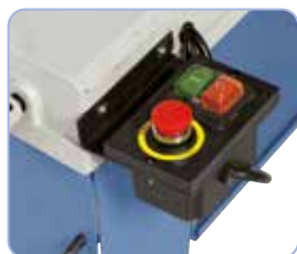
Sikkerhedsafbryder med underspændingsudløsning og separat nødstopknap, automatisk afbrydelse efter afslutning af saveprocessen
