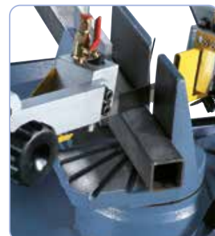
Savrammen kan justeres fra 90° til 60° til geringsnit.
