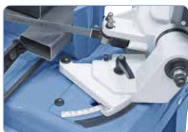
Savramme med låseanordning til bedre håndtering under mobil brug
