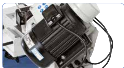
Kraftig støbejernsmotor i henhold til IP 54, fås som ekstraudstyr i 230 V eller 400 V
