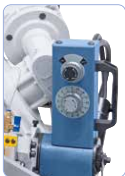
Trinløs justerbar sænkning af savrammen ved hjælp af en reguleringsventil.
