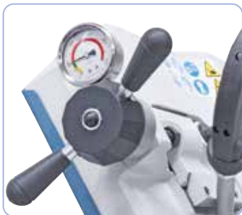
Optimal justering af klingetilsænkningen vha. manometer.
