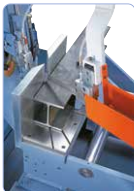
Klingestyr på kuglelejer med hurtig justering til tilpasning til emnets bredde sikrer et optimalt arbejdsresultat.
