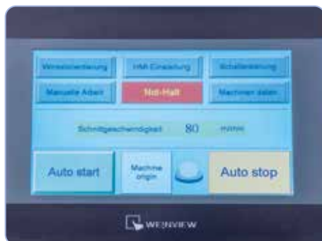
Ved anvendelse af automatik kan fremf ring, sk revinkel og antal snit blive programmeret
