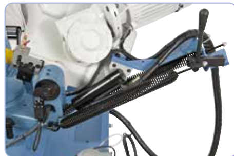
Trækfjeder med justeringshåndtag til skift til manuel betjening.
