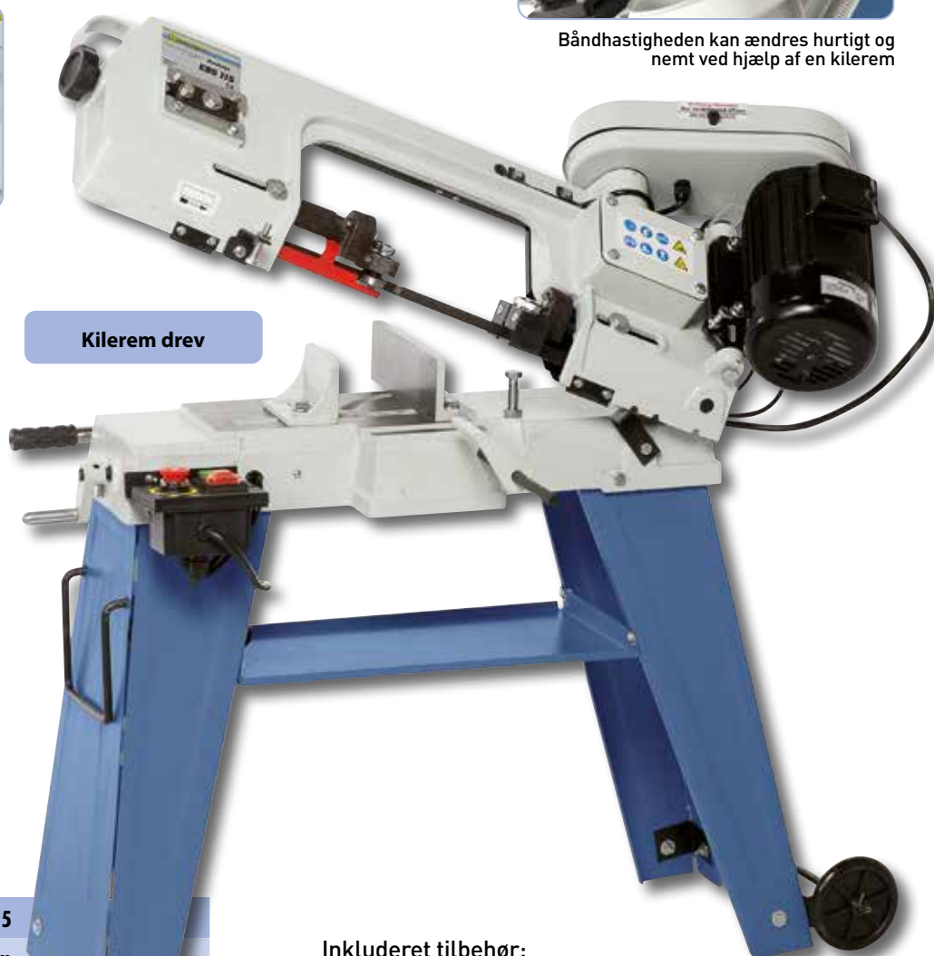
Kraftig støbejernsmotor i henhold til IP 54, fås som ekstraudstyr i 230 V eller 400 V
