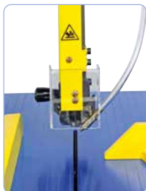
Inkl. udblæsningsanordning for optimal udsyn til skærelinjen
