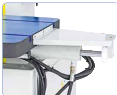
Hydraulisk cylinder til bordfremføring
