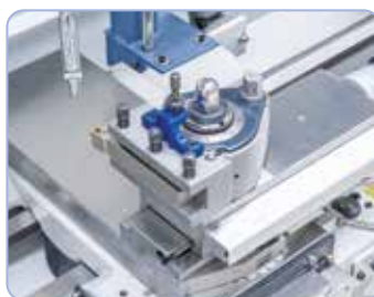
Hurtigskifteholder giver mulighed for at reducere ikke-produktiv arbejdstid og garanterer en høj repetitionseffekt.
