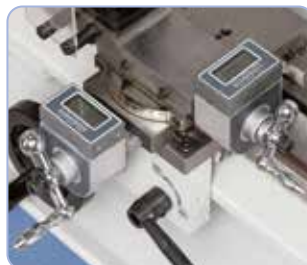
Med digitale displays til præcis indføring og aflæsning ved drejning.
