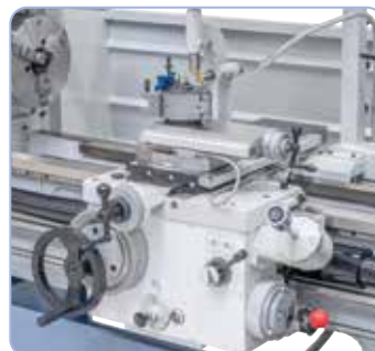
42 frit valgbare fremføringer er tilgængelige til langsgående og tværgående bevægelse af slæden eller den øverste støtte.
