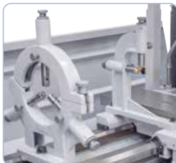
Udstyret som standard med en fast eller medløbende brille for at stabilisere lange emner.
