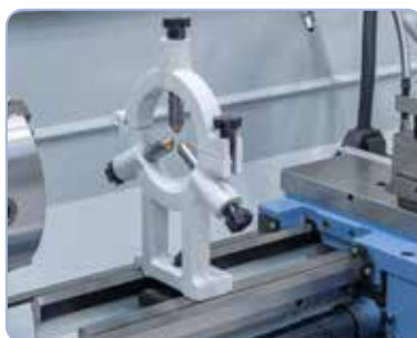
Fast brille med bronzestyring til stabilisering af lange emner
