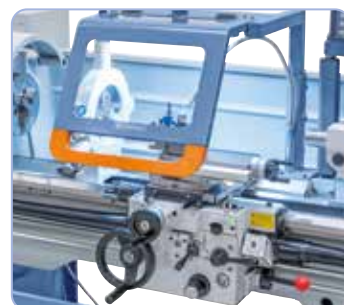
Til langsgående og tværgående bevægelse af slæden eller den øvre støtte der er 17 frit valgbare tilgængelige indstillinger.
