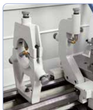
Hurtigskiftværktøjsholderen Multifix muliggør en reduktion af ikke-produktiv tid og sikrer et højt gentagelsesniveau.
