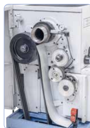
Hærdet hovedspindel med præcise koniske lejer for høj koncentricitet, optimal kraftoverførsel gennem tandede Optibelt-kileremme
