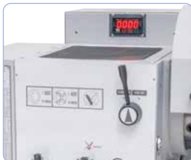
Elektronisk, trinløs hastighedsregulering, let aflæsning ved hjælp af et digitalt display.
