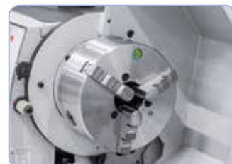
Fordel ved Bernardo-bakkepatronen DK11-200 mm / D5: Der kan leveres monoblok, grund-, vendbare bakker og topbakker
