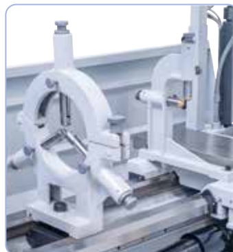
Udstyret som standard med en fast eller medløbende brille for at stabilisere lange emner.
