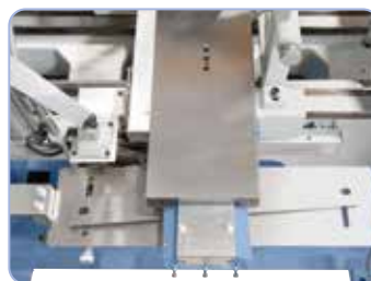
Konisk drejeanordning fås som ekstraudstyr, drejelængde 455 mm, indstillingsvinkel +/- 8°.
