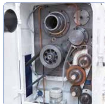
Den hærdede hovedspindel med 130 mm spindelboring er lejet på koniske rullelejer og radiale rullelejer.
