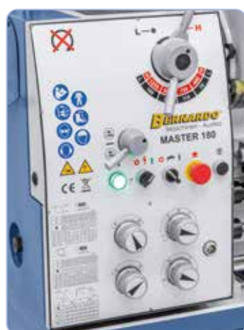
Letgående fremførings- og hastighedskontrol på gearhovedet, jævn drift takket være hærde og slebne tandhjul, der drives i et oliebad.
