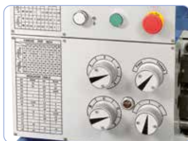
Fremføringsgear kan let og præcist skiftes, drives i et oliebad
