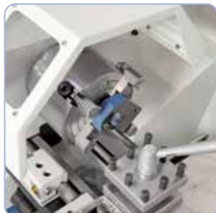
160 mm planskive (ekstraudstyr) ideel til fastspænding af asymmetriske emner.
