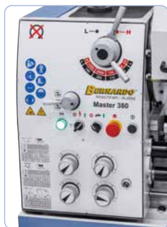
Letgående fremførings- og hastighedskontrol på gearhovedet, jævn drift takket være hærkede og slebne tandhjul, der drives i et oliebad.
