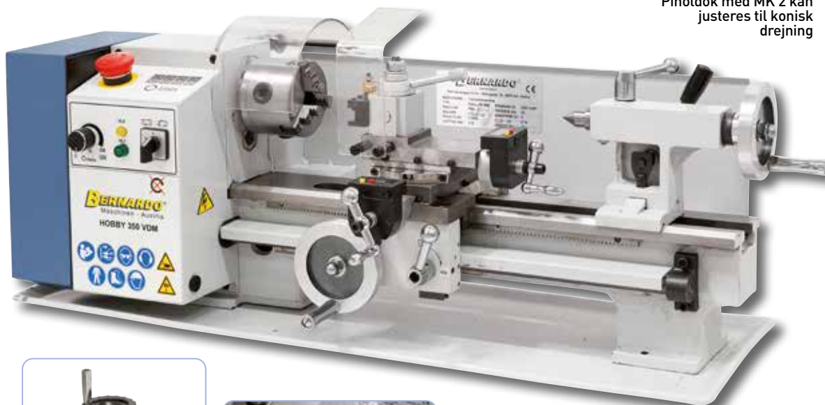
Udstyret med metal håndhjul og metaltandhjul
