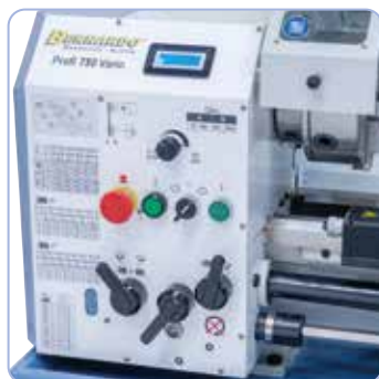
Elektronisk, trinløs hastighedsregulering, let aflæsning ved hjælp af et digitalt display.
