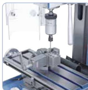
Til gevindskæring kan maskinen udstyres med et gevindskæringsapparat fra M5 - M12.
