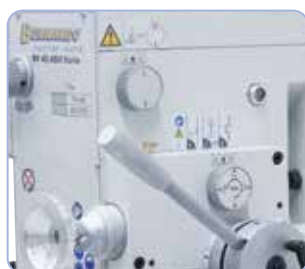
Spindelfremføringen kan indstilles til 0,10 / 0,18 eller 0,26 mm/o efter eget valg
