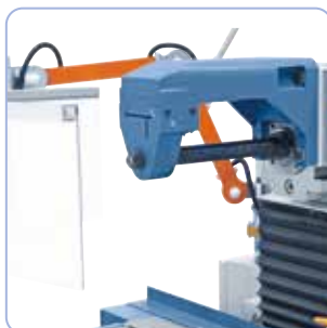
Til fræsning i vandret position med modleje og lang fræsedorn.
