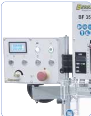
Digital visning af hastighed og boredybde inkluderet ved leveringen.
