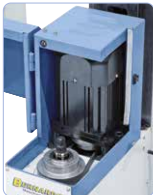
Meget jævn drift takket være afbalancerede drivskiver.
