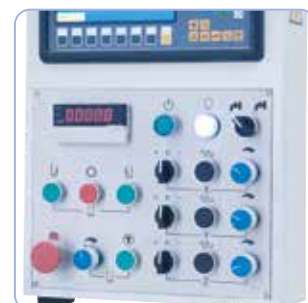
Hurtig og nem indstilling af den ønskede fremføringshastighed direkte på betjeningspanelet.
