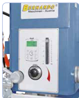
Frekvensomformer regulerer omdrejningstal trinløst.
