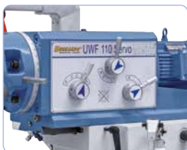
Enkelt betjening af betjeningsselement til skift af omdrejningstal.
