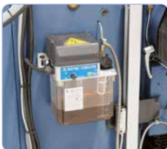
Elektrisk centralsmøring til alle føringsveje og spindler.
