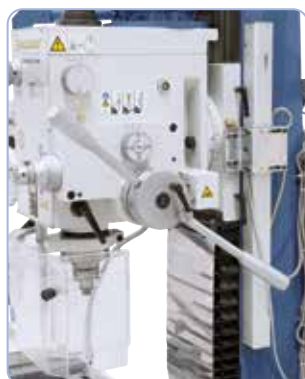
Spindelfremføringen kan indstilles til 0,10 / 0,18 eller 0,26 mm/o efter eget valg
