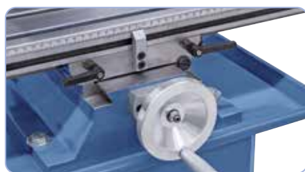
SValehaleføring til x, y og z akser, justerbar via kilelister.
