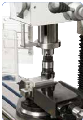
Fræsning med skærehoved
