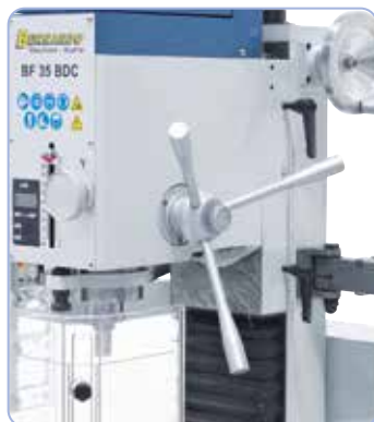
Stort stjernegreb til let spindeltilførsel ved boring, håndhjul til fin indføring ved fræsning.
