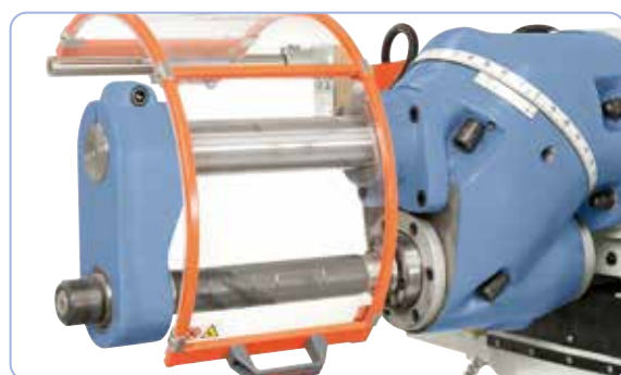
Til fræsning i vandret position med modleje og lang fræsedorn som standard
