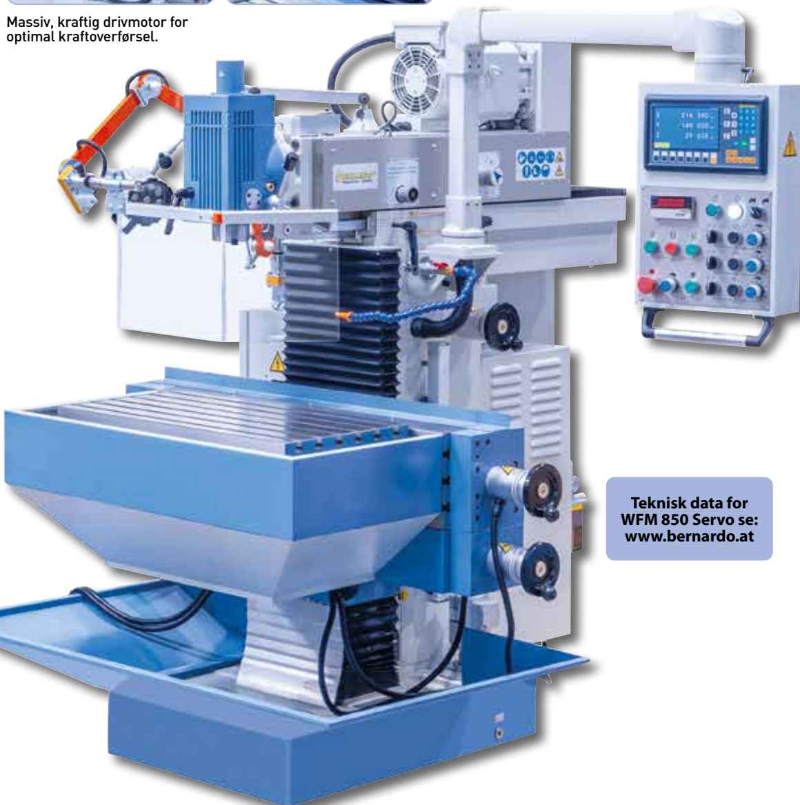
Justerbar beskyttelsesanordning, der kan anvendes til både lodret og vandret fræsearbejde.
