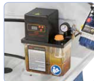
Elektrisk centralsmøring inkluderet i leveringsomfanget
