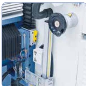
Med elektroniske håndhjul til manuel bevægelse i x-, y- og z-akserne.
