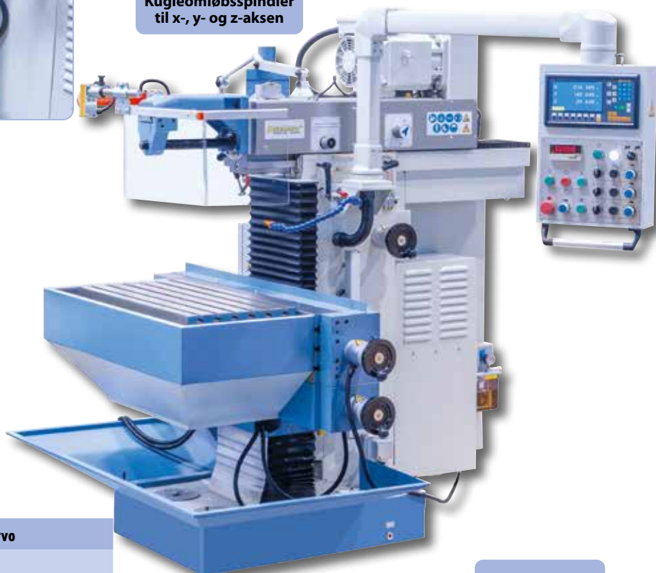
Hurtig og nem indstilling af den ønskede fremføringshastighed direkte på betjeningspanelet.
