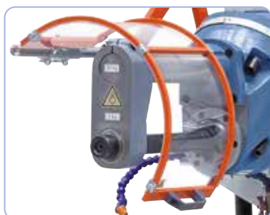
Til fræsning i vundet position med modleje og lang fræsedorn.
