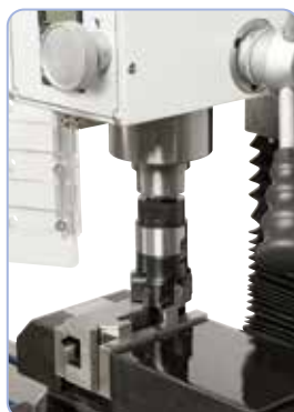
Fræsning med skærehoved
