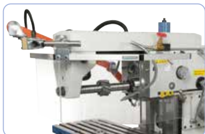
Horizontal fræsning med modholder
