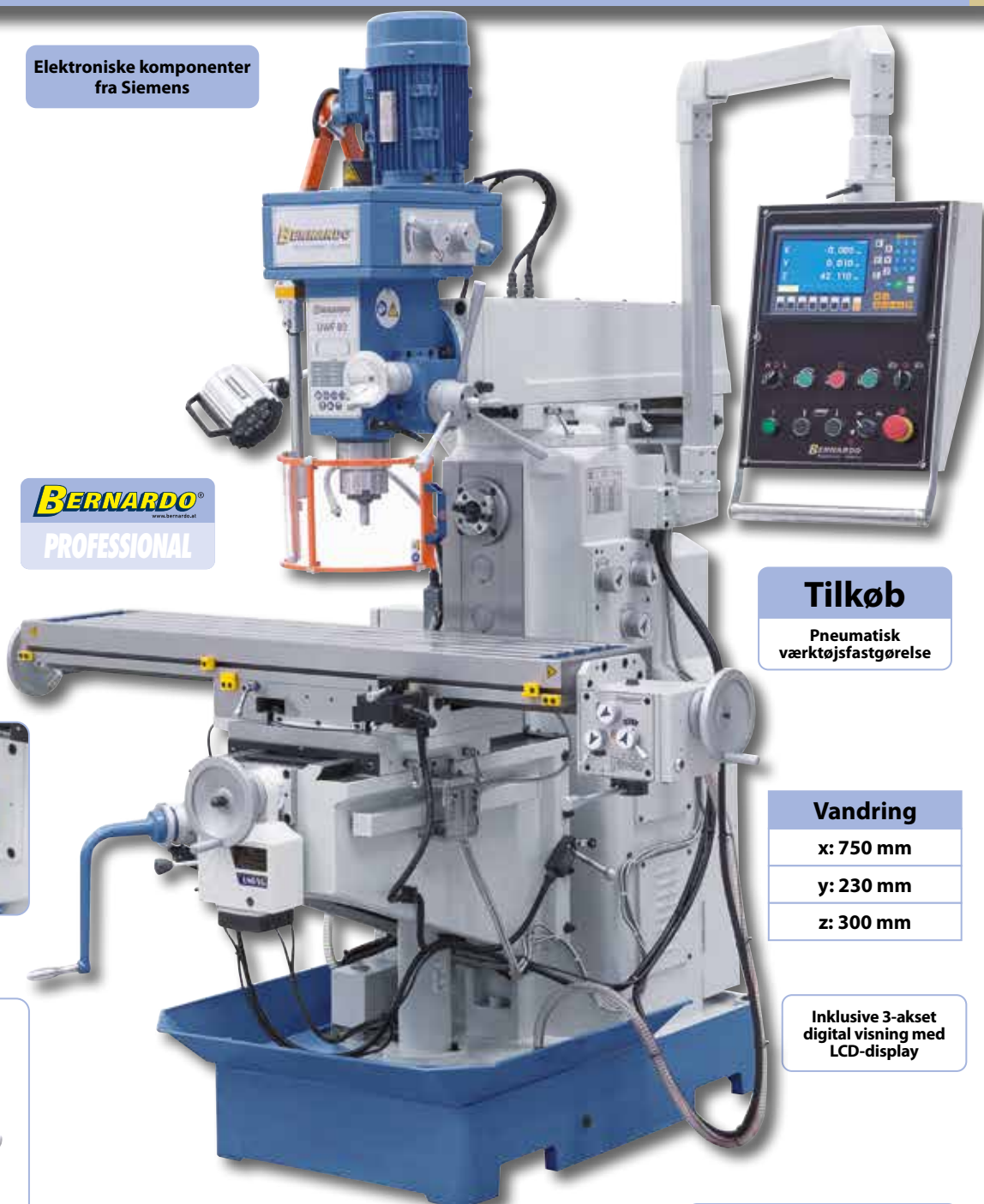
Inklusiv trinløs regulerbar fremføring til y-aksen.
