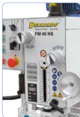
Enkelt og hurtigt hastighedsskift ved hjælp af gearvalgskontakt.
