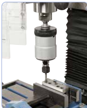
Til gevindskæring kan maskinen udstyres med et gevindskærings- apparat fra M5 - M12.
