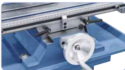
Svælhaleføring til x, y og z akser, justerbar via kilelister.
