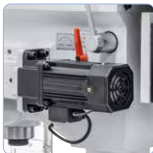
Trinløs indstillelig spindelfremføring med separat drivmotor.
