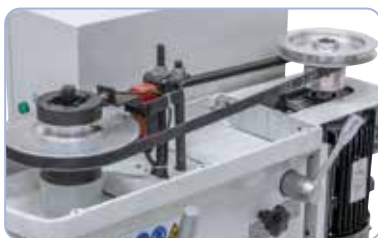
Meget jævn drift takket være afbalancerede drivskiver.
