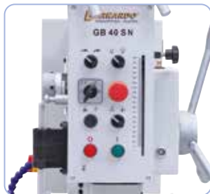
Enkel betjening af koblingselementerne på fronten
