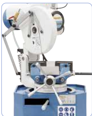
Naklápěcí hlava převodovky (v úhlu 45° vpravo / vlevo), optimální k pokosovému řezání
