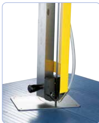
Vedení pilového pásu uložené v kuličkových ložiscích, nastavitelné na výšku obrobku.
