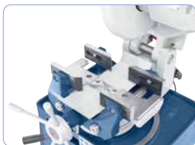
Svěrák s automatickým středěním a podélné posuvnými upínacími čelistmi
