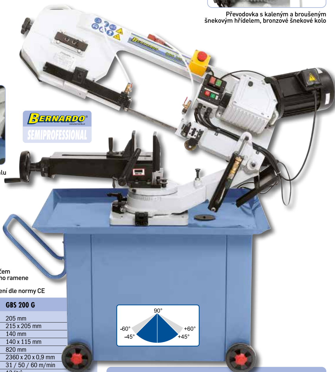
Centrální uspořádání ovládacích prvků na pilovém rameni
