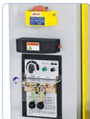
Včetně svářečky pilového pásu se zařízením na žihání pásu, nůžkami a brusku
