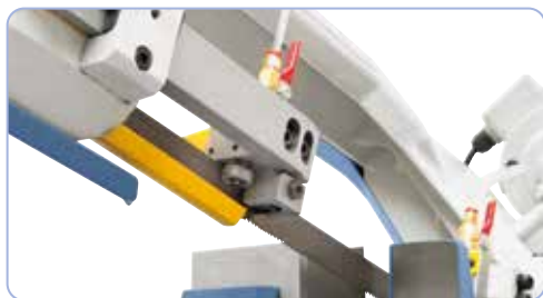
Kombinované vedení s válečky a tvrdokovem zamezuje rychlému opotřebení pilového pásu
