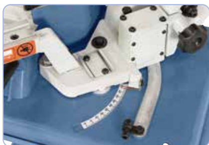
Nastavitelný rám pily k pokosovému řezání
