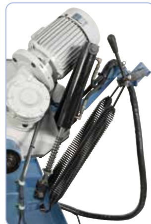
Tažná pružina se stavěcí pákou k přepnutí na ruční provoz
