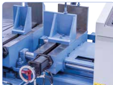
Posuv materiálu pomocí hydraulického upínacího zařízení a přesného kruhového vedení
