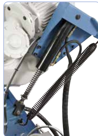
Sériově vybavená hydraulickým válcem, který umožňuje citlivé spouštění ramene pily
