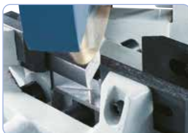
Naklápěcí hlava převodovky (v úhlu 45° vpravo / vlevo), optimální k pokosovému řezání
