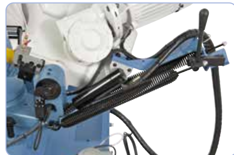
Tažná pružina se stavěcí pákou k přepnutí na ruční provoz
