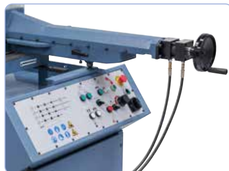
Posuvný svěrák, upnutí se provádí ručně nebo hydraulicky
