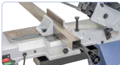
S dorazem délky obrobku pro řezy v malých sériích
