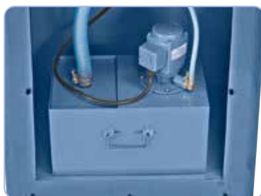
Výkonné chladicí zařízení, úsporně integrované v podstavci
