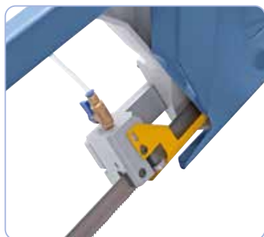
Vedení pilového pásu v kuličkových ložiscích a stírací kartáč na třísky zajišťují optimální výsledky řezu
