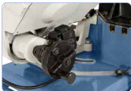
3polohové nastavení řezného tlaku rámu pily
