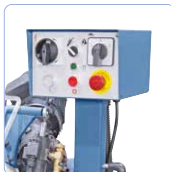
Přehledně uspořádaná ovládací skříň na přední straně stroje zajišťuje komfort obsluhy
