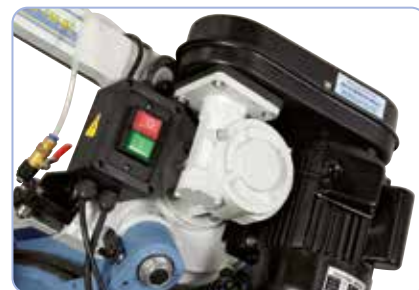
Řeznou rychlost (23 / 33 / 52 m/min) lze rychle a jednoduše změnit přesunutím klínového řemenu
