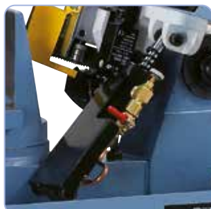
Sériově vybavená hydraulickým válcem, který umožňuje citlivě spouštění rámu pily
