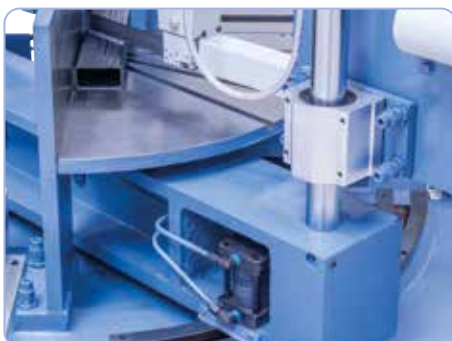
Automatické nastavení úhlu řezu s hydraulickým upínáním.
