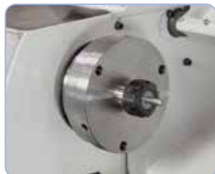
Pro přesné upínání válcových obrobků lze doobjednat kleštinový upínač ER 25 s upínacím rozsahem 1 - 16 mm.
