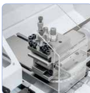
Zrychlení výměn nožů lze dosáhnout rychlovýměnným nožovým držákem
