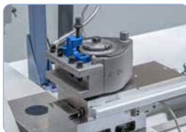
Pro hospodárnou práci je stroj sériově vybaven rychloupínacím nožovým držákem.
