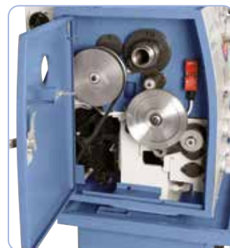
Dodáváno s kompletní sadou výměnných kol pro řezání závitů
