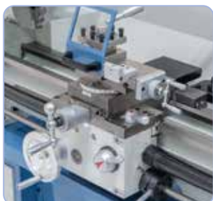
Snadný chod nožového suportu a čtyřnožového držáku pomocí ruční kola s nastavitelnou jemnou stupnicí
