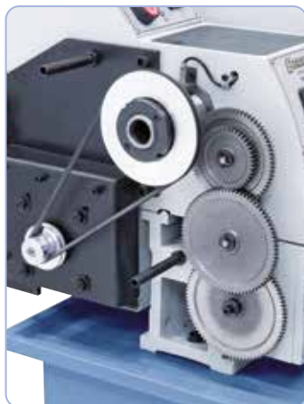
Uložení kaleného vřetena v přesných kuželíkových ložiscích zajišťuje velmi nízkou házivost ( \leq 0,015 mm)
