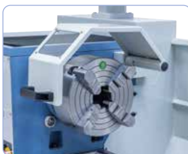
Centricky upínané 4čelíkové sklíčidlo 200 mm, optimální pro čtyřhranné obrobky (na objednávku)
