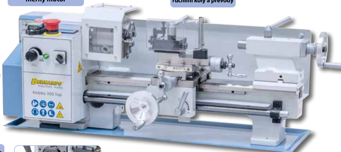
Koník s upínacím kuzelem MK 2 lze nastavit pro soustružení kuželových tvarů
