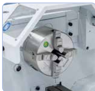
Lze dodat 4čelíšťové sklíčidlo pr. 125 mm, pro upínání čtyřhranných obrobků
