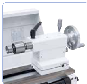
Otočný středící hrot typ SMA se 7 výměnnými hroty pro univerzálnější používání (na objednávku)
