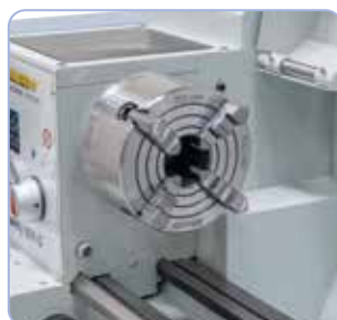
4čelistové nesoustředné sklíčidlo k upínání obrobků nepravidelného tvaru (na objednávku).
