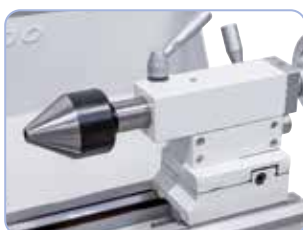
Středicí hrot pr. 60 mm, ideální k upínání trubek a dutých těles (na objednávku)
