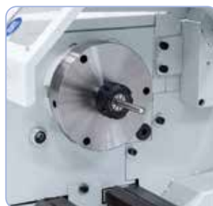
Pro přesné upínání válcových obrobků lze doobjednat kleštinový upínač ER 25 s upínacím rozsahem 1 - 16 mm.
