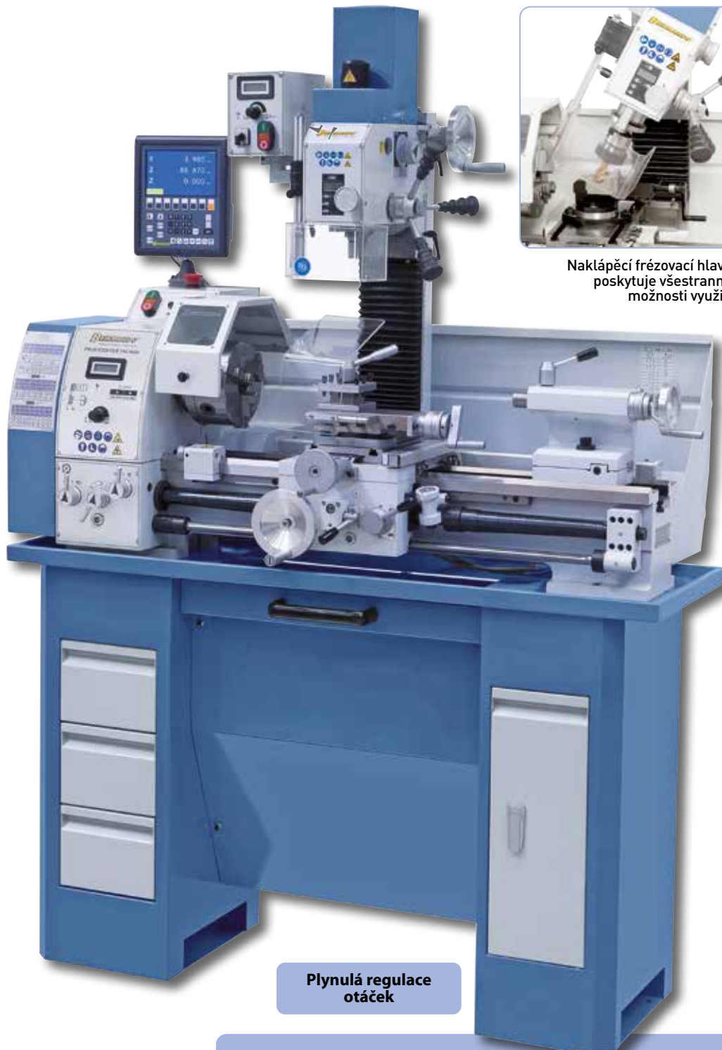
Suport se jemně ladí pomocí ručních kol, tento model je navíc vybavený automatickým příčným posuvem
