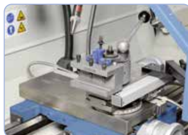
Rychloupínací nožový držák Multifix v základní výbavě (Standard 165 Top)
