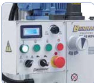
Jednoduchá předvolba stupně převodovky volicím spínačem převodovky, nastavení požadovaných otáček potenciometrem
