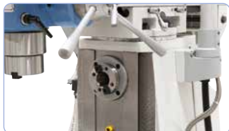
Horizontální vřeteno pro rozšířené možnosti využití
