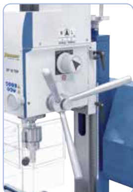
Hvězdicová rukojeť dimenzovaná pro snadný přísuv pinoly při vrtání, ruční kolo k jemnému přísuvu při frézování
