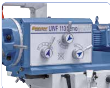
Jednoduchá obsluha ovládacích prvků pro změnu otáček
