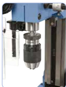
Na přání s rychloupínacím sklíčidlem 1 - 10 mm / B 12
