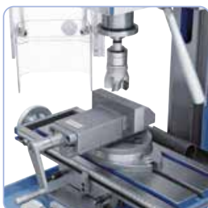
Frézování s plochou a rohovou frézou (pol. č.: 42-1057)
