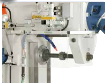
Opěrné ložisko a dlouhý frézovací trn k horizontálnímu frézování v základní výbavě
