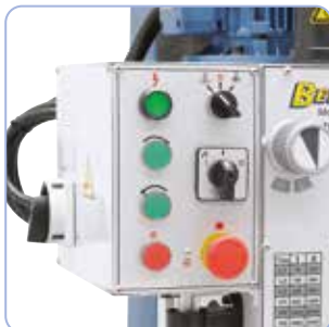
Přehledné umístění ovládacích prvků (vrtání závitů, start-stop ovladač,...)
