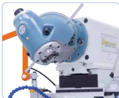
Univerzální frézovací hlava, nastavitelná do všech poloh s libovolným úhlem
