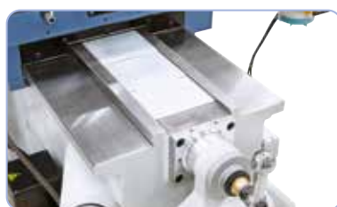
Masivní hranolové vedení v ose y
