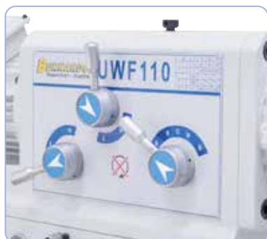
Jednoduché ovládání řadičích prvků změny otáček
