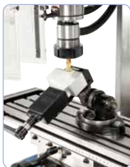
Frézování s trojosým otočným svérákem PGS 50
