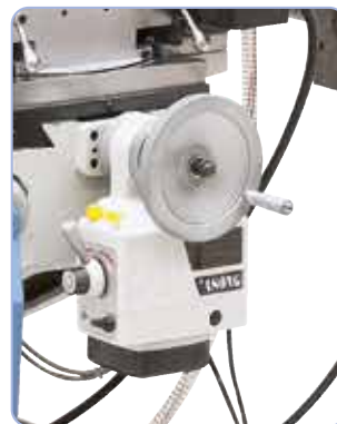
Plynulý posuv pro osu y v základní výbavě
