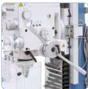
Sériově vybavená automatickým 3stupňovým posuvem pinoly
