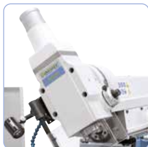
Naklápěcí svislá frézovací hlava s ručně posouvanou pinolou.
