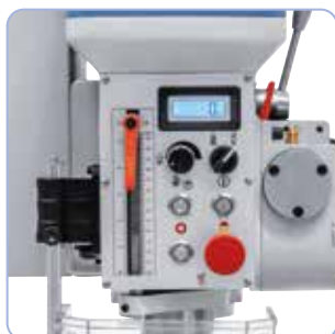
Sériově vybavená digitálním zobrazením otáček. Ergonomicky umístěné ovládací a obslužné prvky na přední straně (DMT 25 PFV).
