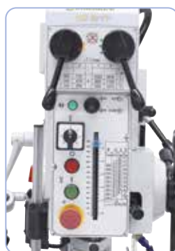
Masivní hlava převodovky s ergonomicky umístěnými ovládacími a obslužnými prvky
