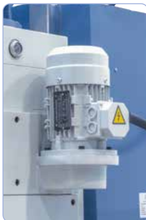
Motor posuvu snižuje polohovací doby pinoly
