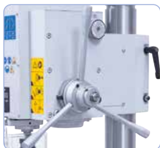
Pohyb pinoly je možný ručně nebo pomocí strojního posuvu
