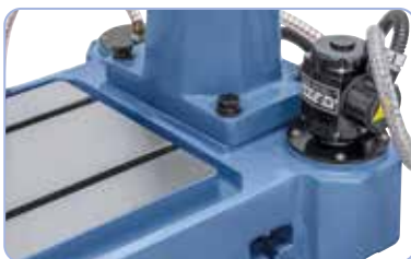
Přesně opracovaná základna stroje, sériově dodávaná s integrovaným čerpadlem chladicí kapaliny.
