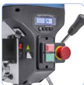
Digitální zobrazení hloubky vrtání zjednodušuje obsluhu
