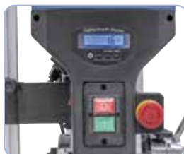
Digitální zobrazení hloubky vrtání zjednodušuje obsluhu
