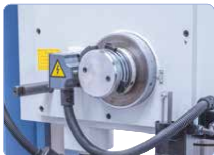
Zařízení pro řezání závitů s rychloposuvem, popřípadě pracovním posuvem, a rychlý zpětný chod (z KBM 63)
