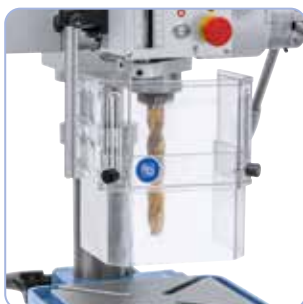
Vysoká bezpečnost zajištěna výškově stavitelným krytem sklíčidla s mikrospínacem
