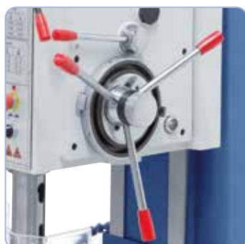
Hvězdicová rukojeť k ručnímu posuvu pinoly, spojovací páka pro automatický posuv.
