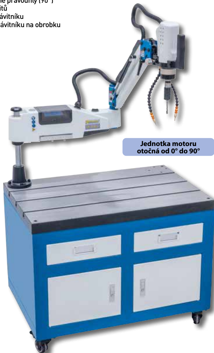
Komfortní práce: Nastavení velikosti závitů, stoupání, počtu otáček a hloubky vrtání přímo přes integrovanou dotykovou obrazovku
